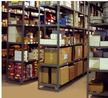
Figura n° 30 Almacenamiento mediante estantería de ángulo ranurado
