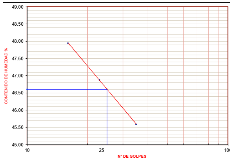
Ilustración 27- Contenido de Humedad en porcentaje versus, número de golpes en copa de Casa Grande, Calicata 01. Fuente: Elaboración propia.
