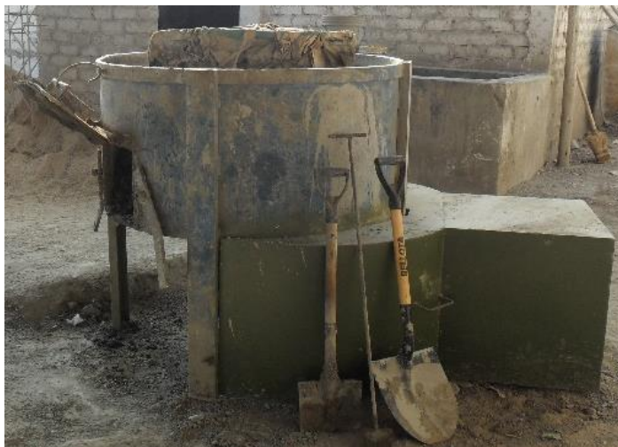
Figura 07: Máquina mezcladora de agregados Fuente: Elaboración Propio (2018)
