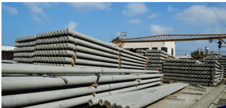
Figura 05: Postes de concreto para tendido eléctrico
