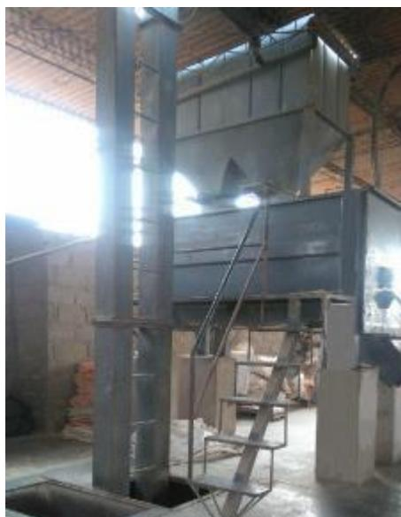
Figura 19 Mezcladora horizontal de doble cinta
