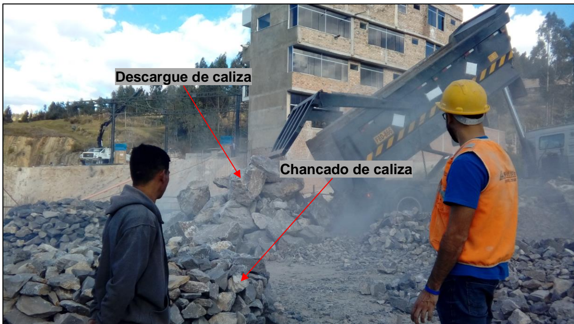
Figura 11. Descargue de roca caliza y chancado. Fuente: Elaboración propia, (2017).
