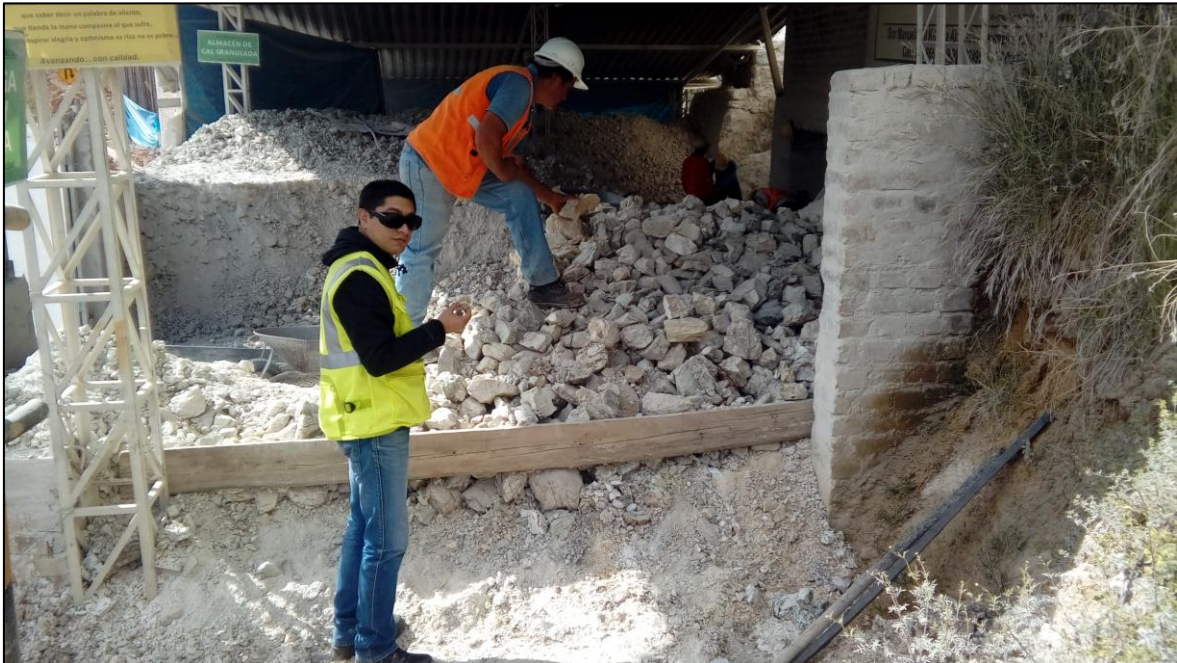
Figura 15. Selección de impurezas dentro del óxido de calcio granado.
