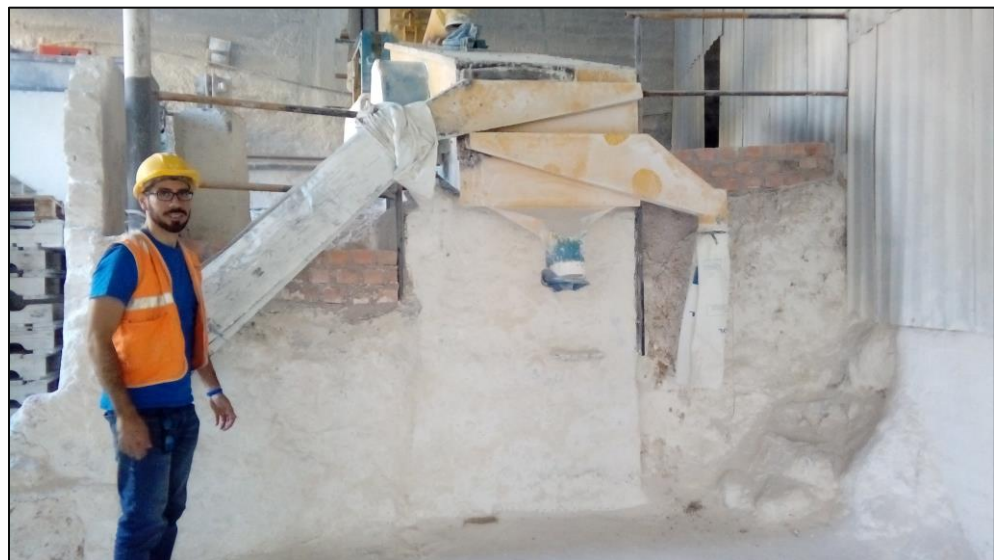
Figura 22. Llenado de sacos con óxido de calcio molido. Fuente: Elaboración propia, (2018).
