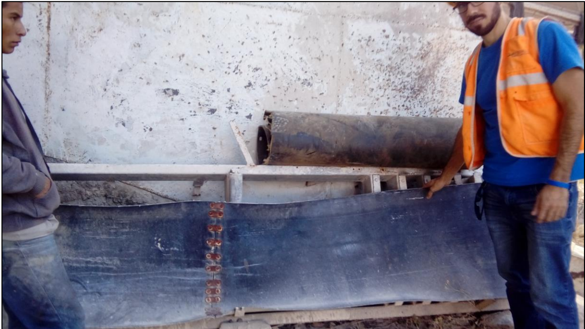
Figura 26: Faja transportadora que sustituirá a las herramientas manuales. Fuente: Elaboración propia, (2018).
