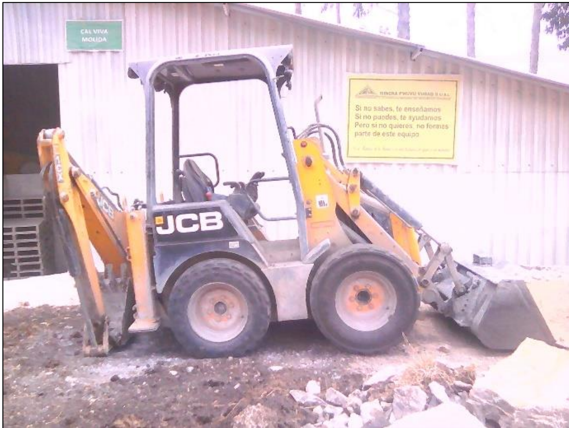
Figura 25: Mini cargador que alimentará a la chancadora. Fuente: Elaboración propia, (2018).
