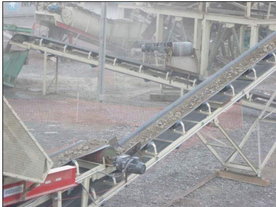
Figura 6. Fajas transportadoras Nordberg NB500 hasta chancadora.
