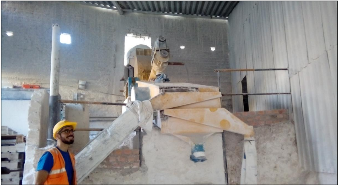
Figura 16. Molienda del óxido de calcio granado.
