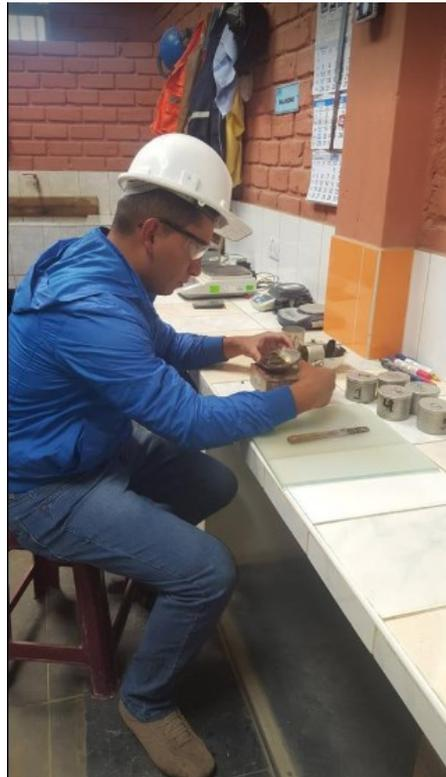
Foto n° 3: Ensayo de Límites de Atterberg para determinar la plasticidad según ASTM D 4318
