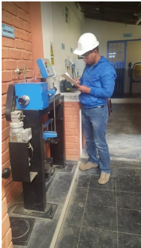
Foto n° 6: Ensayo de Corte Directo según ASTM D 3080-90
