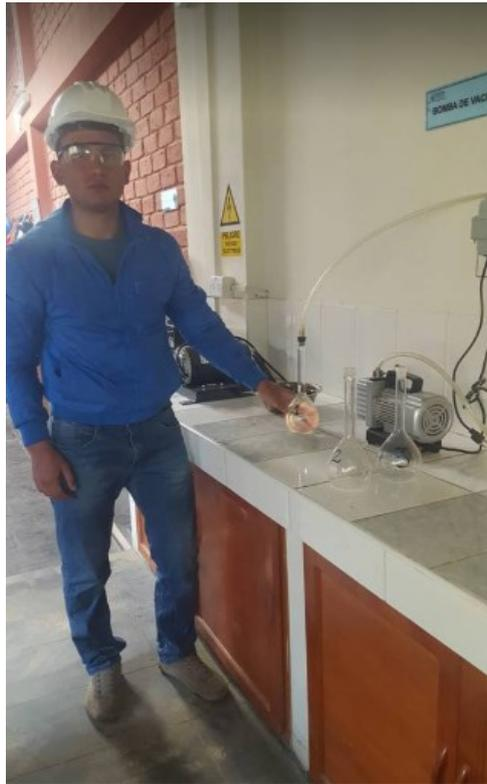
Foto n° 5: Ensayo de Peso Específico de Finos según ASTM D 854
