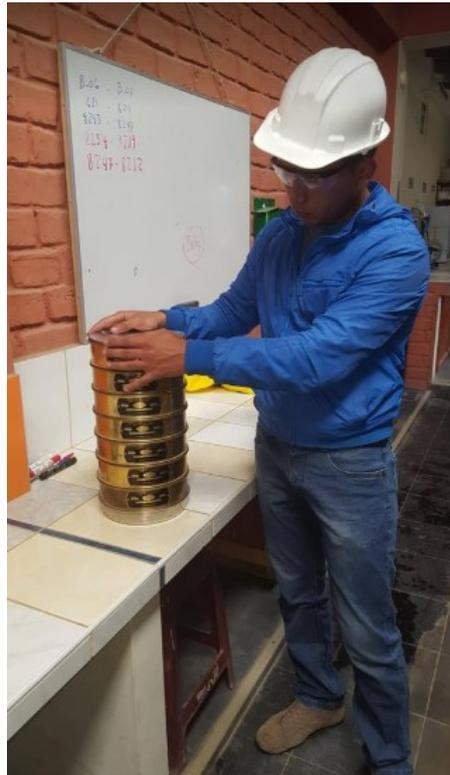
Foto n° 1: Ensayo de Análisis Granulométrico ASTM D422/C136
