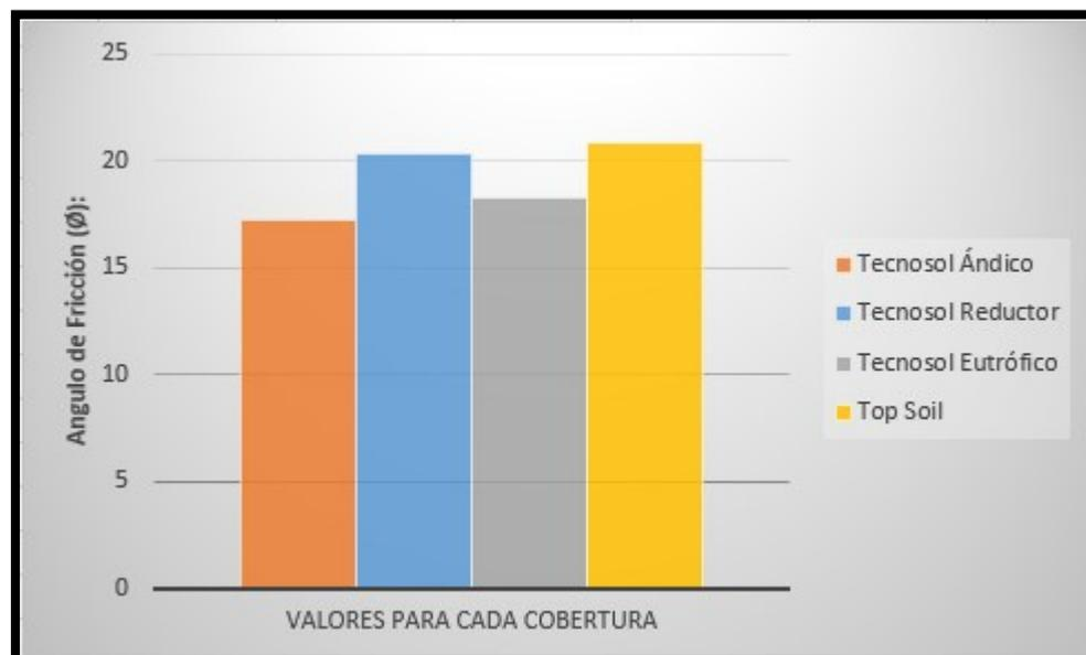
**Figura 10:** Valores de ángulo de fricción interno para cada tipo de cobertura
