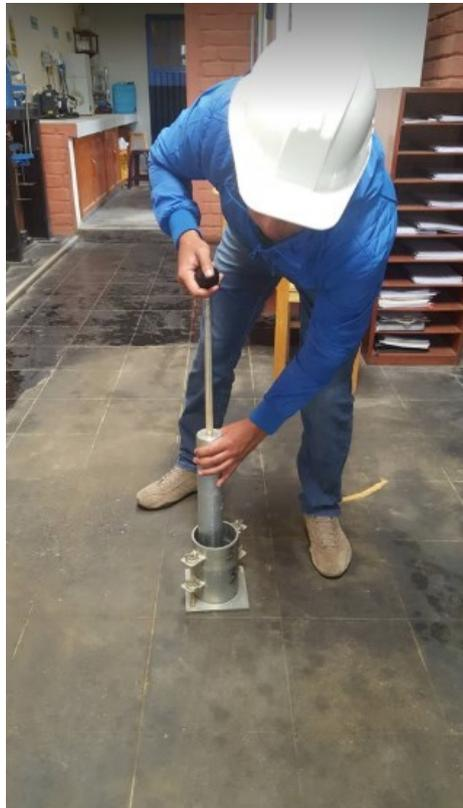
Foto n° 4: Ensayo de compactación Proctor Estándar según ASTM D 698
