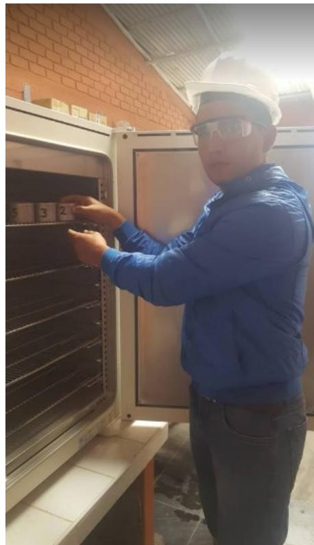
Foto n° 2: Horno para secado de muestras a temperatura 110°C y determinar el Contenido de Humedad según ASTM D 2216
