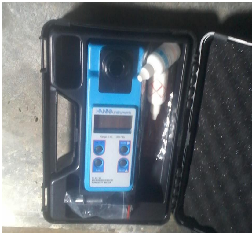
Figura 02: Turbidímetro para el análisis de la calidad del agua en el distrito de Bambamarca – 2017.
