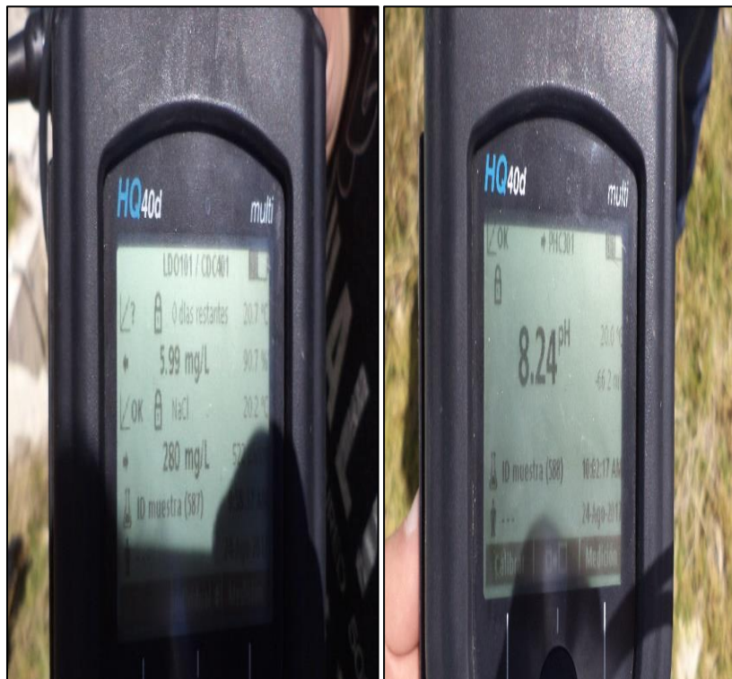
Figura 07: Medición de la Conductividad Eléctrica, Oxígeno Disuelto, Sólidos Totales Disueltos, Temperatura y pH.
