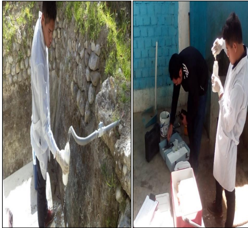
Figura 16: Muestreo y preservación de muestras.
