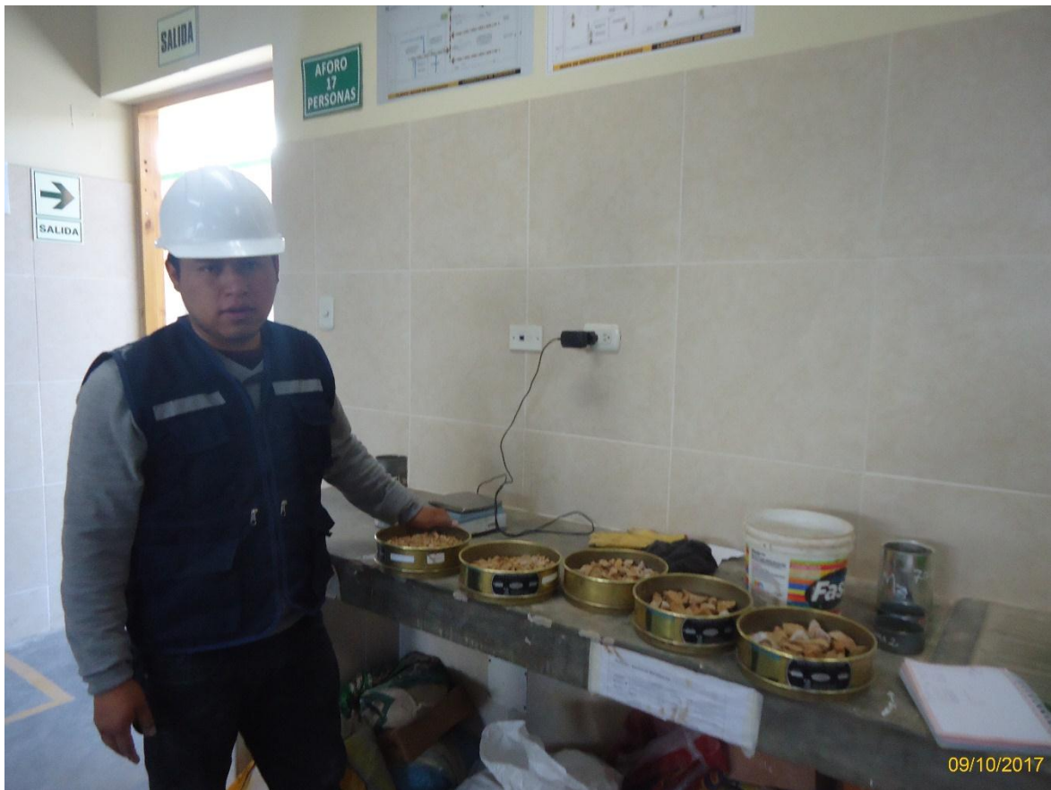
Fotografía n.º 6. Pesaje del material retenido por las mallas.
