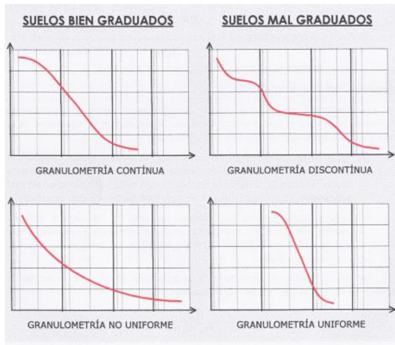
Figura 4. Interpretación de la curva granulométrica. Fuente: Bañon, 2010.
