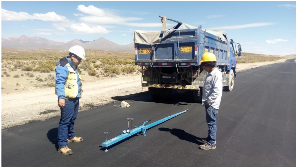
Imagen 7. Ejecución del Ensayo de Viga Benkelman para determinar la deflexión y radio de curvatura.
