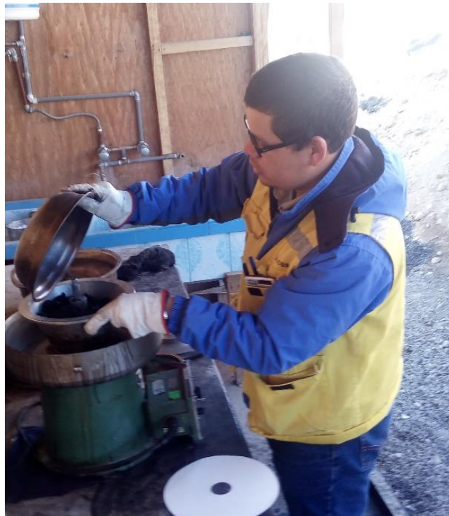
Imagen 1. Colocado de la mezcla asfáltica en la centrífuga para la realización del ensayo.
