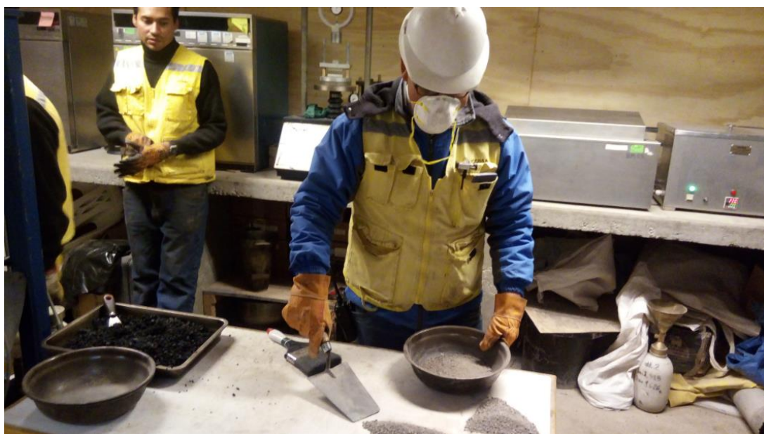
Imagen 5. El ensayo de adherencia permite determinar el grado de cubrimiento de las partículas de agregado en una mezcla bituminosa.
