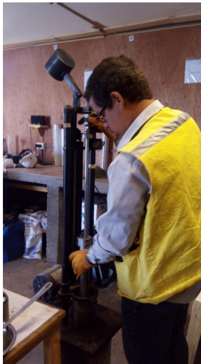
Imagen 2. El ensayo Marshall es un procedimiento para obtener el contenido de asfalto y diferentes parámetros de calidad de una mezcla bituminosa.
