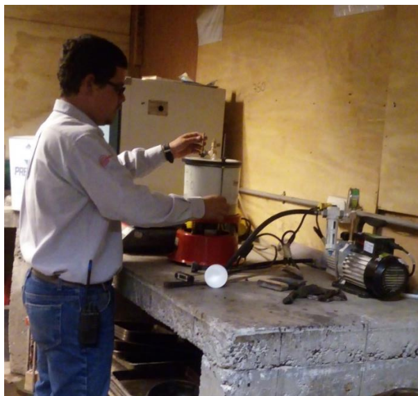
Imagen 3. El Ensayo Rice es un procedimiento utilizado para la determinación del peso específico efectivo y absorción de asfalto de agregados pétreos para mezclas asfálticas en caliente.
