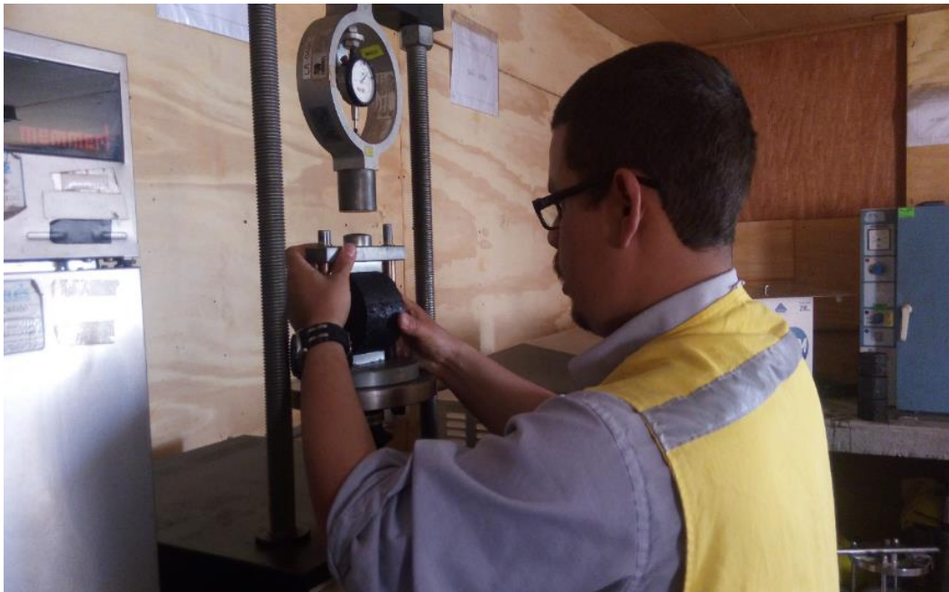
Imagen 4. El ensayo Lottman consiste en cargar una probeta cilíndrica, igual a la definida para el ensayo Marshall, con una carga de compresión diametral a lo largo de dos generatrices opuestas.
