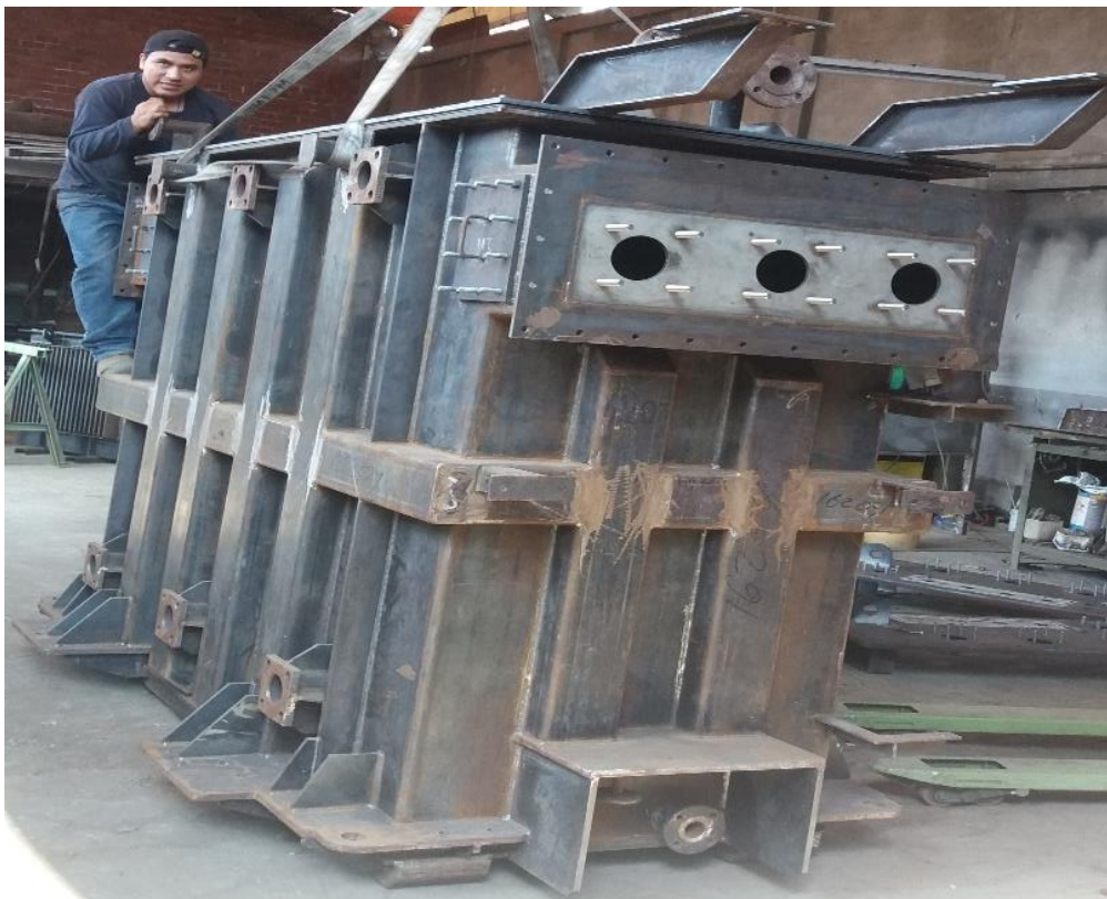
Figura n°. 7. Tanque de potencia
