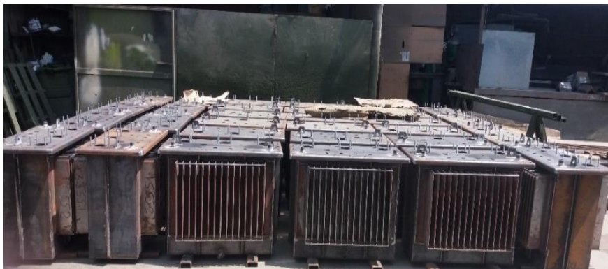
Figura n°. 10. Tanque(cuba) de distribución modelo aleteado 50kva
