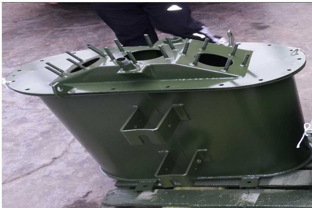
Figura n°. 6. Tanque trafomix-ovalado
