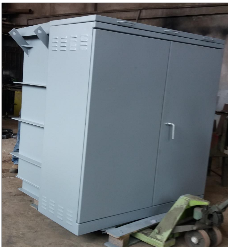
Figura n°. 8. Tanque tipo pedestal
