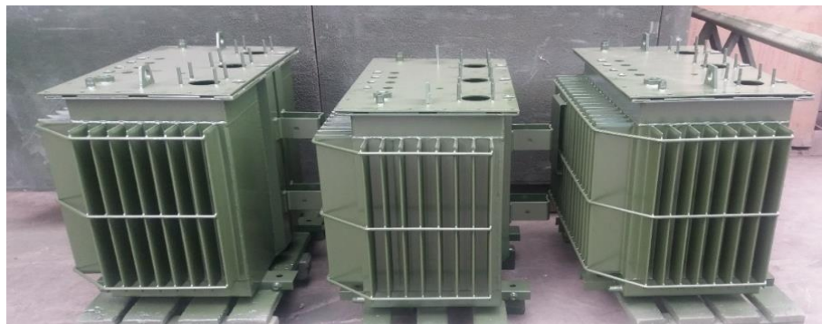
Figura n°. 9. Tanque de distribución modelo aleteado 100kva
