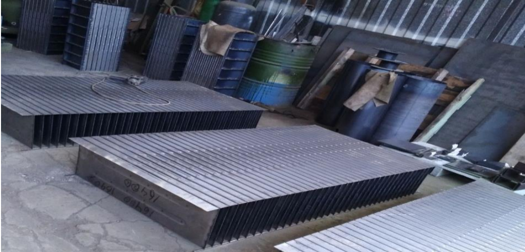
Figura n°. 12. Aletas para tanques de transformadores
