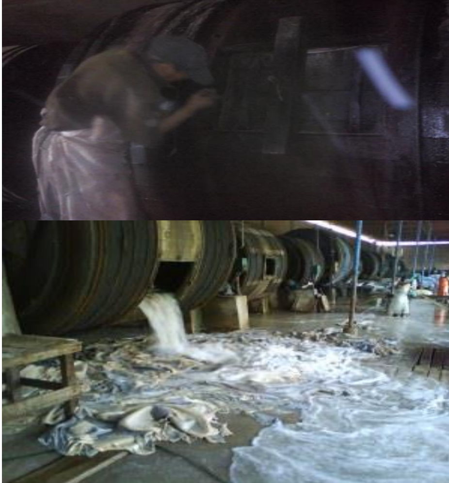
Figura 28: Proceso se lava la piel dentro de los botaes desencalado y purga
