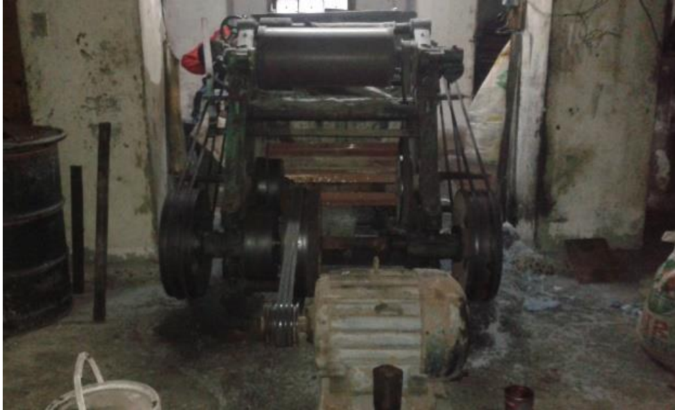
Figura 40: La máquina no cuenta con guardas de seguridad
