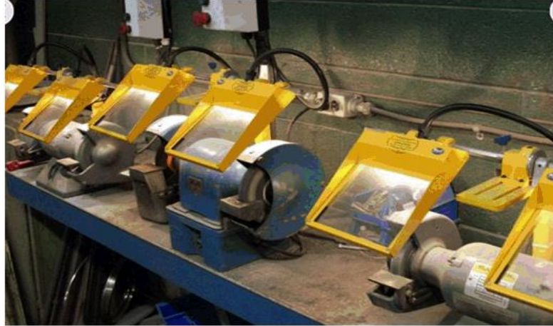
Figura 58: Resguardos Regulables y Autorregulables, en equipos de esmerilado, equipos similares a los que se emplean en la Curtiembre San José E.I.R.L.
