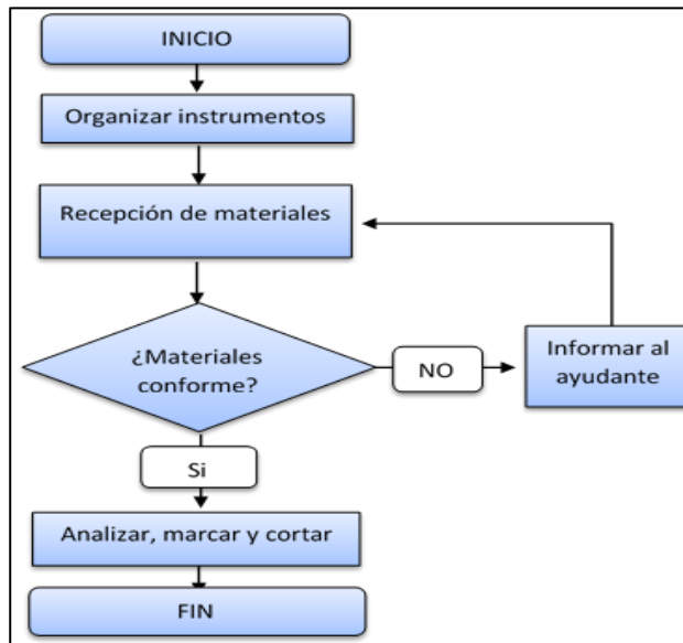
Figura 19: Diagrama de flujo del área de corte
