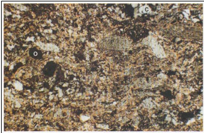
Figura 2.5. Gneis, compuestos por granos de cuarzo (c), plagioclasas (p), muscovita (m) intersticiales; existen escasos minerales opacos (o). Aumento 150X.
