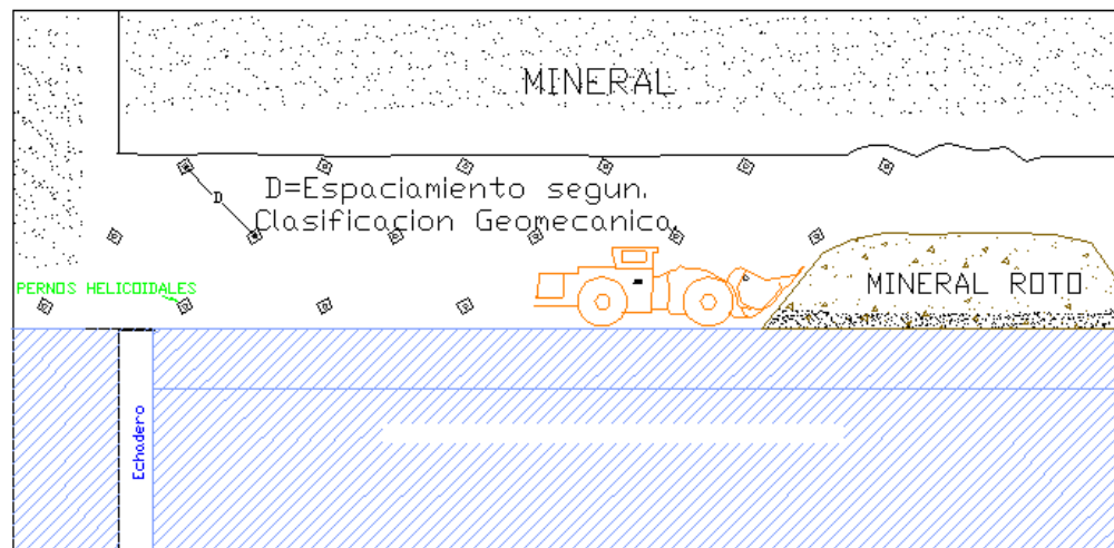
Figura 32 Ciclo de Minado en Corte y Relleno Semimecanizado – Limpieza.
