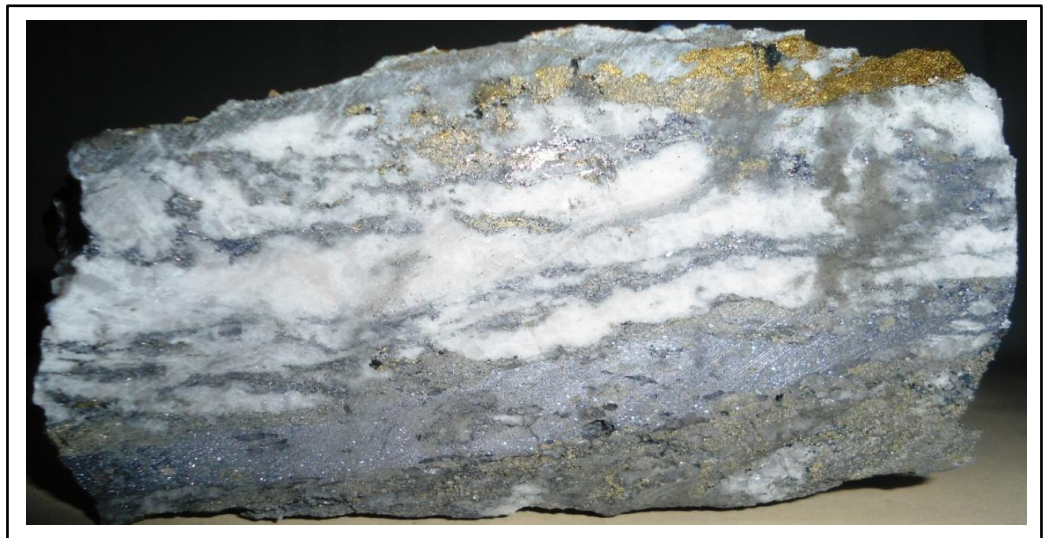
Figura 2.16 Imagen donde se muestra la textura crustificada típico de un filon donde se nota la secuencia de mineralización Sf, Ga, Py, Qz y Cal i/o la textura de bamdeamiento en la mineralizacion.
