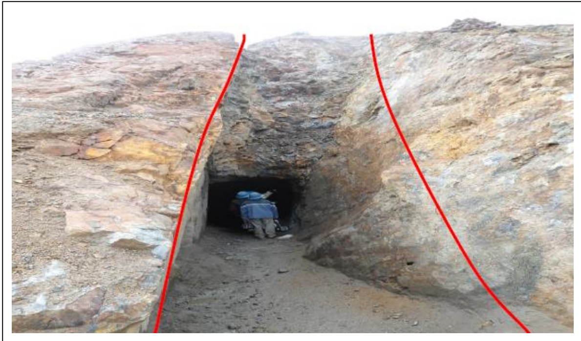
Figura 2.20 Imagen donde se muestra a la veta Bertha en el Nv.4330 Galería Omonte I definida por las cajas andecíticas.
