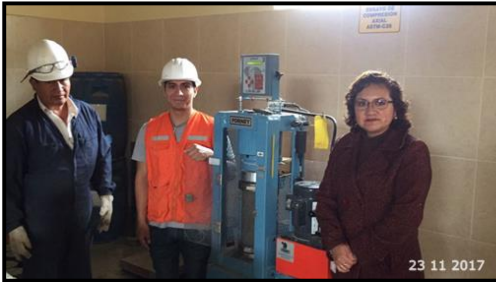
Foto 39: Supervisión de la ingeniera Anita Alva y colaboración del Sr. Víctor Cuzco en el ensayo de compresión axial de probetas de la edad de 14 y 28 días.
