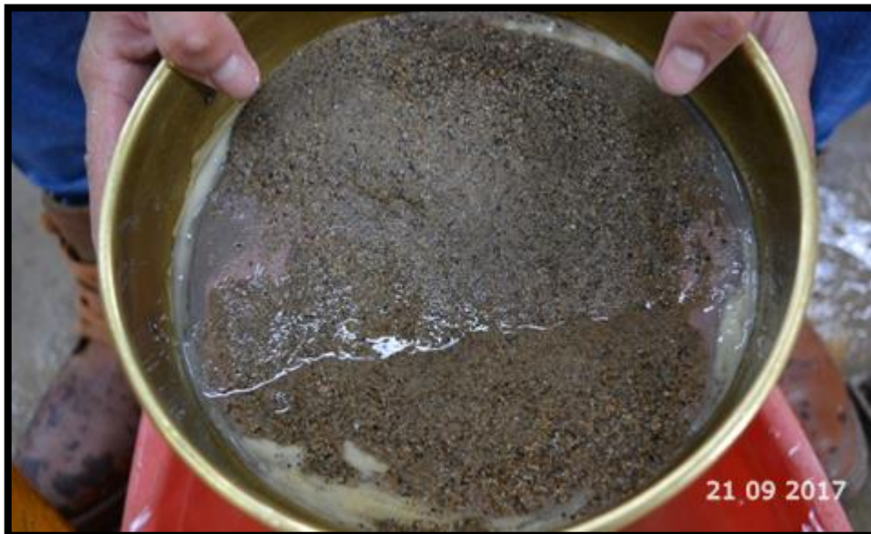
Foto 13: Material listo para depositarlo en la tara correspondiente
