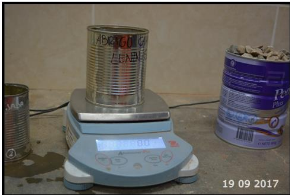
Foto 03: Tarado de recipiente para el ensayo de contenido de humedad del agregado fino.
