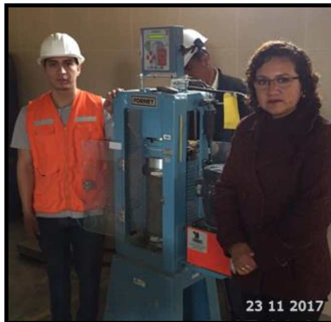
Foto 38: Supervisión de la ingeniera Anita Alva en el ensayo de compresión axial de probetas de la edad de 14 y 28 días.
