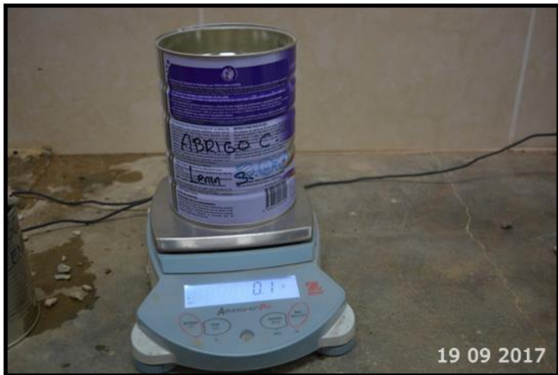
Foto 03: Tarado de recipiente para el ensayo de contenido de humedad del agregado grueso.
