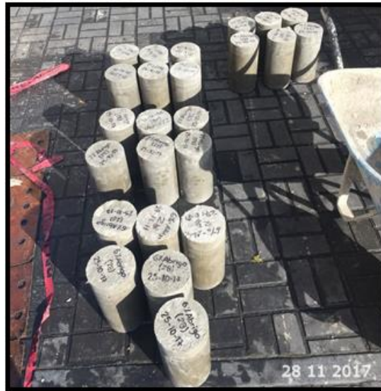
Foto 41: Preparación de las probetas de la edad de 7 días para el ensayo a compresión axial en el laboratorio.
