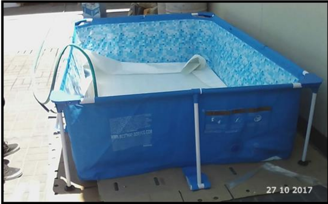
Foto 33: Armado y llenado de la piscina para el curado de las probetas.
