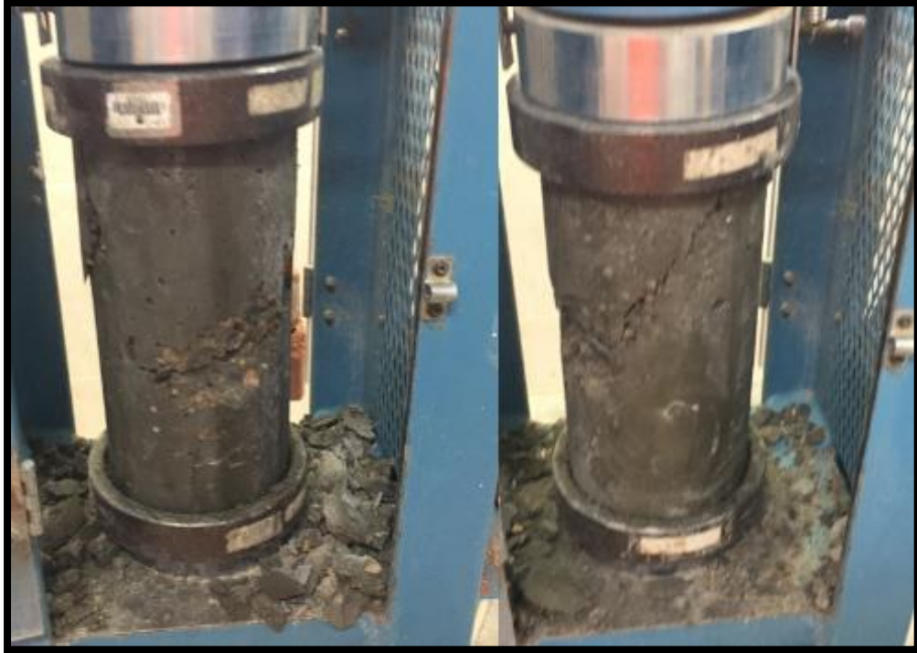
Fotografía N° 2: Fractura presentada en la probeta patrón a la edad de 14 días.
