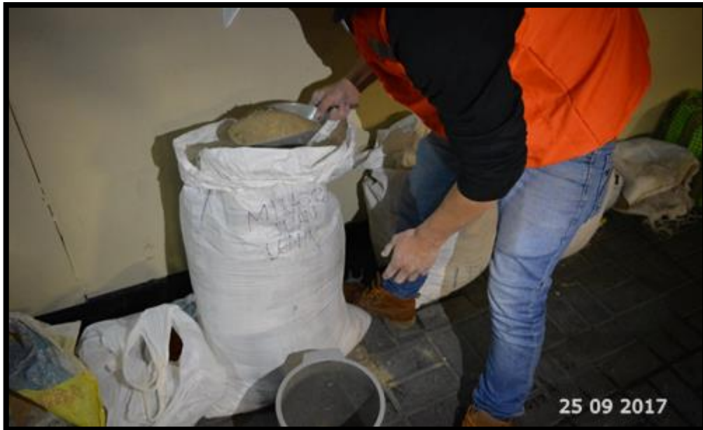
Foto 16: Colocación de agregado fino en el molde para el ensayo de peso unitario.
