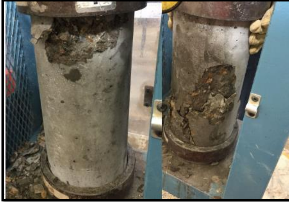
Fotografía N° 3: Fractura presentada en la probeta patrón a la edad de 28 días.
