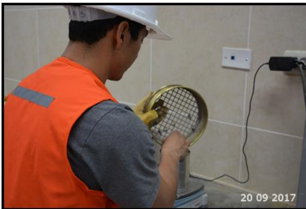
Foto 09: Extracción del agregado grueso del tamiz, para luego pesarlo.
