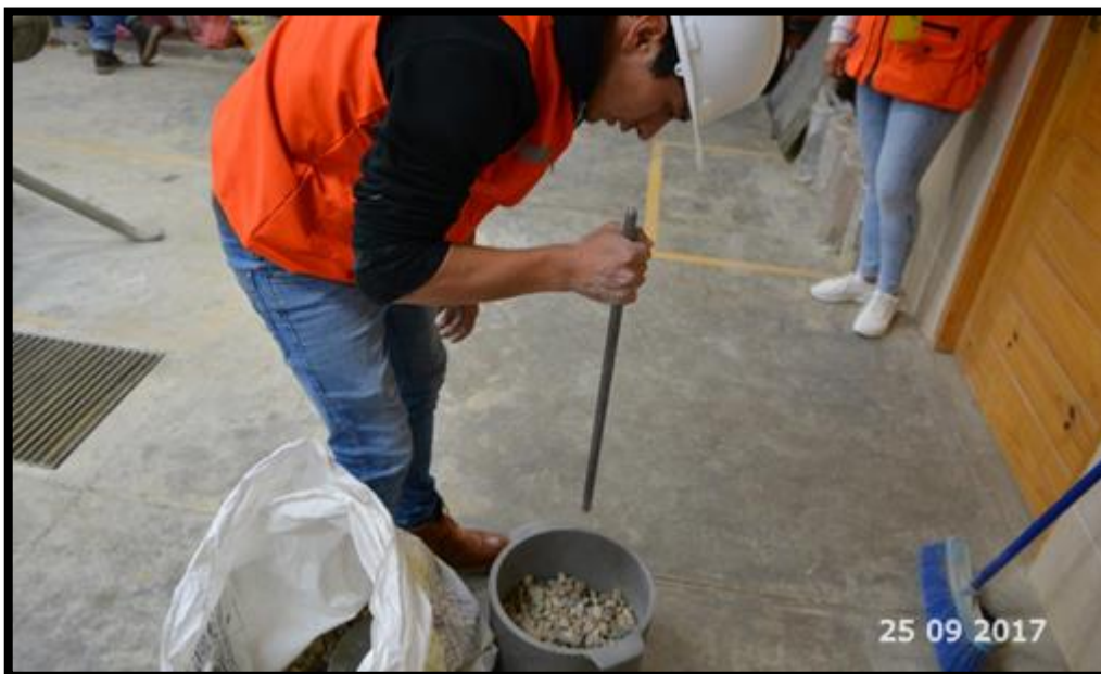
Foto 15: Apuntalamiento uniforme de agregado grueso para el ensayo de peso unitario.
