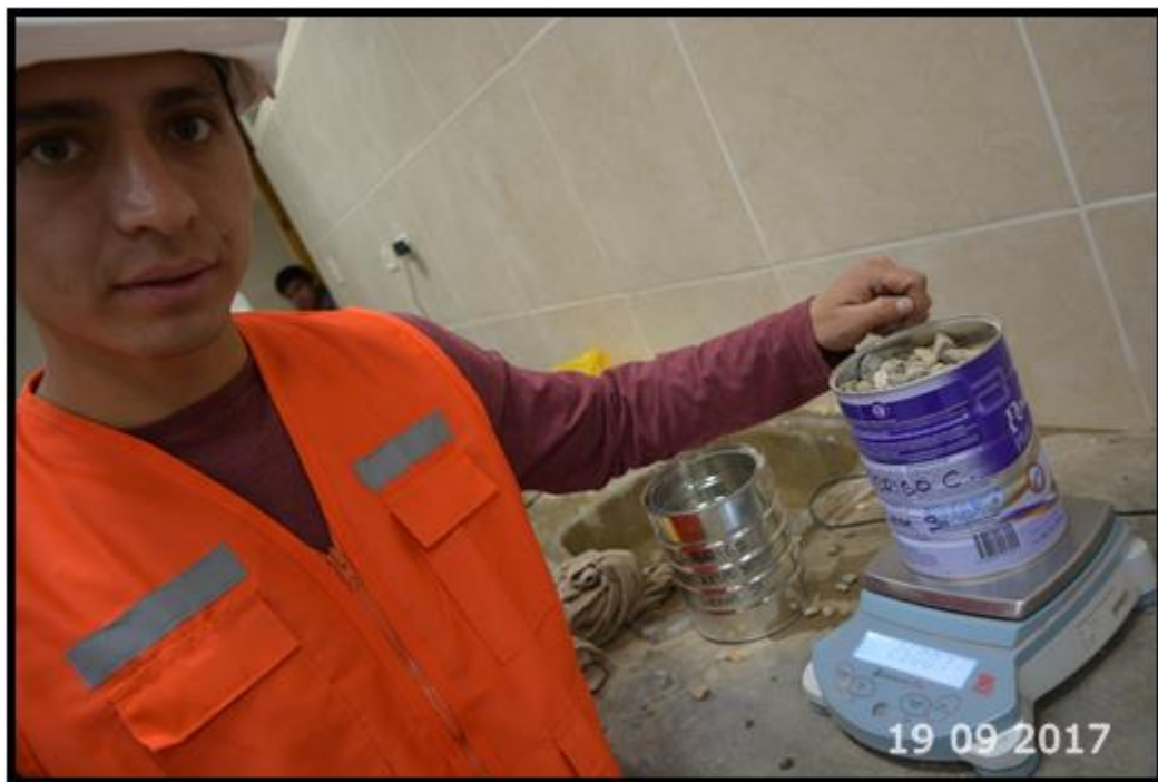
Foto 05: toma de datos para el ensayo de contenido de humedad del agregado fino.
