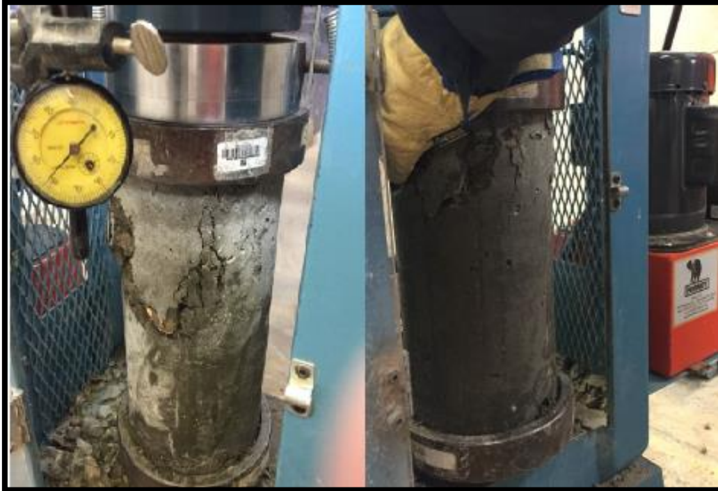
Fotografía N° 6: Fractura presentada en la probeta con 2% de fibra de vidrio a la edad de 28 días
