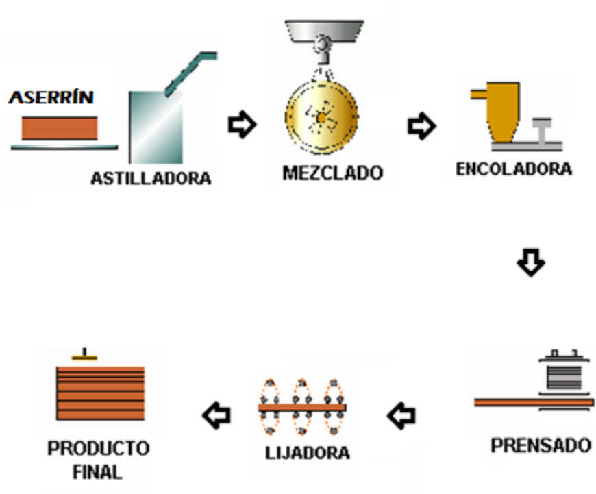
Figura n° 9: Esquema del proceso de producción de tableros aglomerados.
