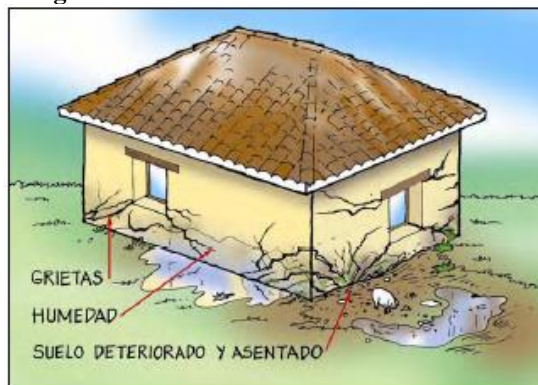
Figura N° 19 Ausencia de Cimentación
