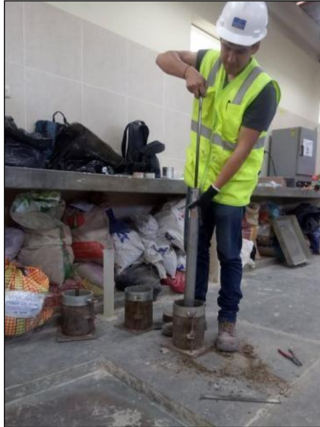
Figura 14: Compactación en moldes CBR
