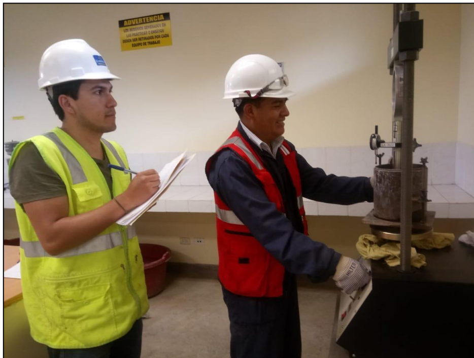
Fotografía 8: Lecturas de penetración en Prensa Hidráulica con el asesoramiento del laboratorista.
