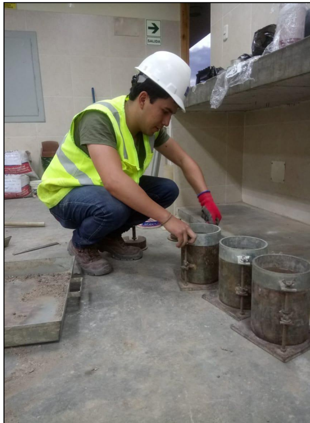
Fotografía 7: Preparación y ajuste de moldes CBR para realizar el ensayo de compactación
