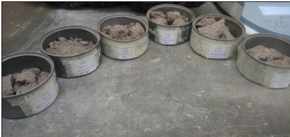
Figura 15: Muestras para determinar densidad húmeda y contenido de humedad de cada molde
