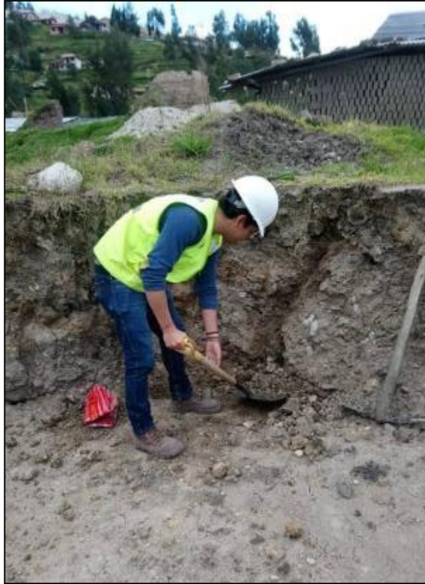
Figura 3: Excavación manual para obtención de la muestra
