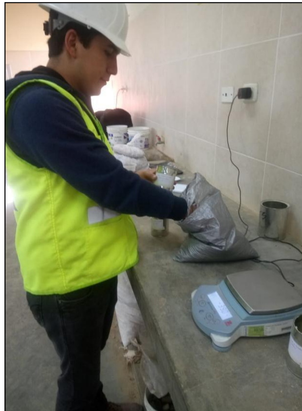
Fotografía 3: Preparación de la muestra para el ensayo de contenido de humedad
