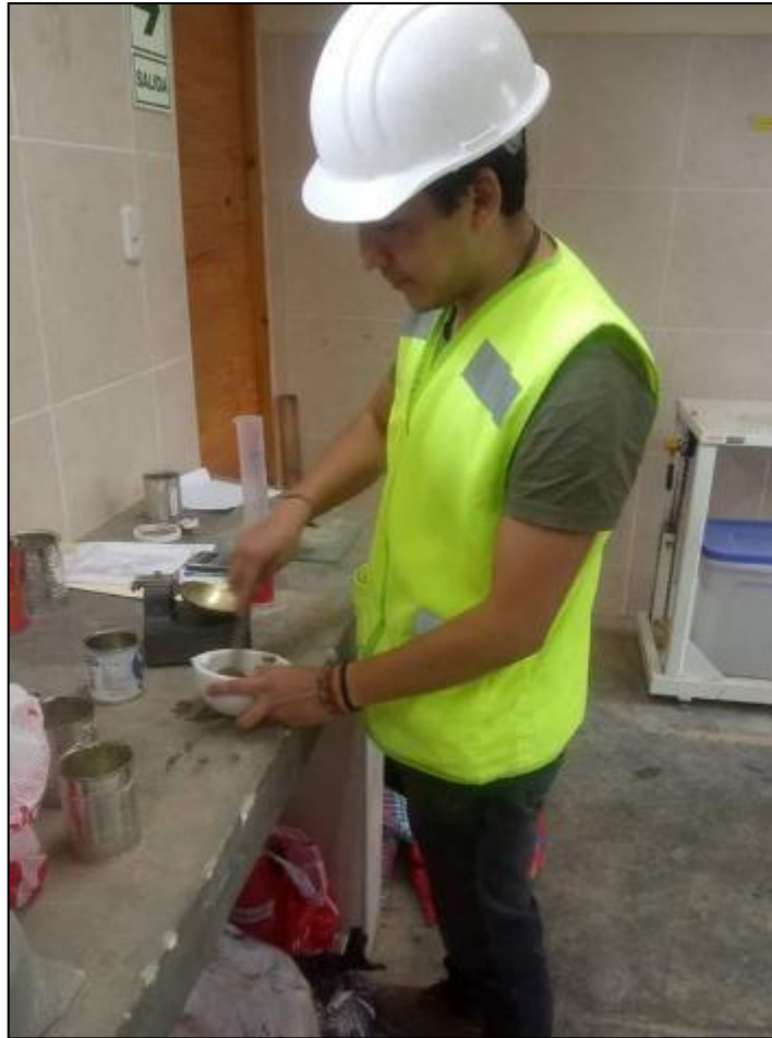
Figura 9: Obtención de la pasta en la cápsula de porcelana
