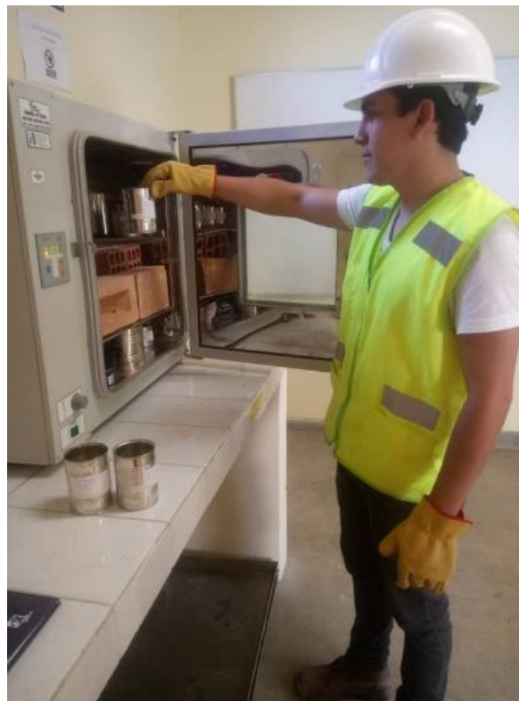
Figura 5: Secado de material en el horno a 110 \pm 5 °C
