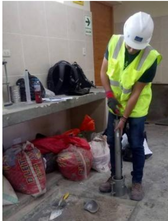
Figura 12: Compactación con el pisón a 5 capas con 25 golpes cada una
