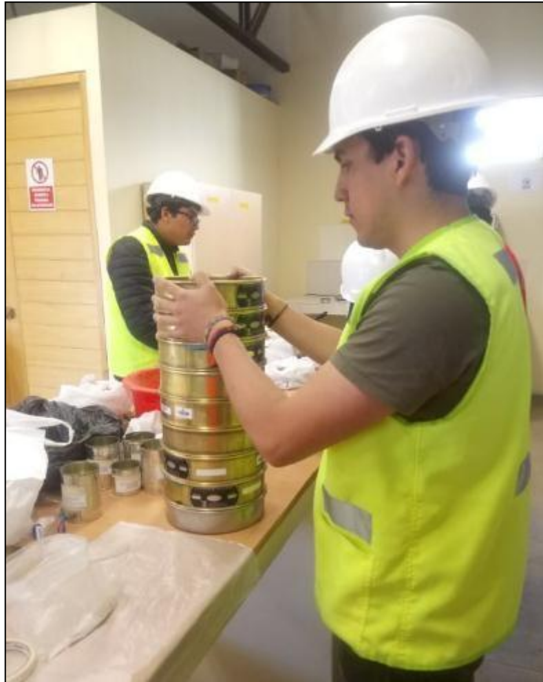
Figura 8: Tamizado de la muestra seca
