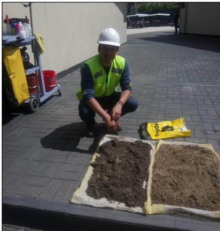
Fotografía 2: Secado a temperatura de ambiente del suelo obtenido para ser ensayado.
