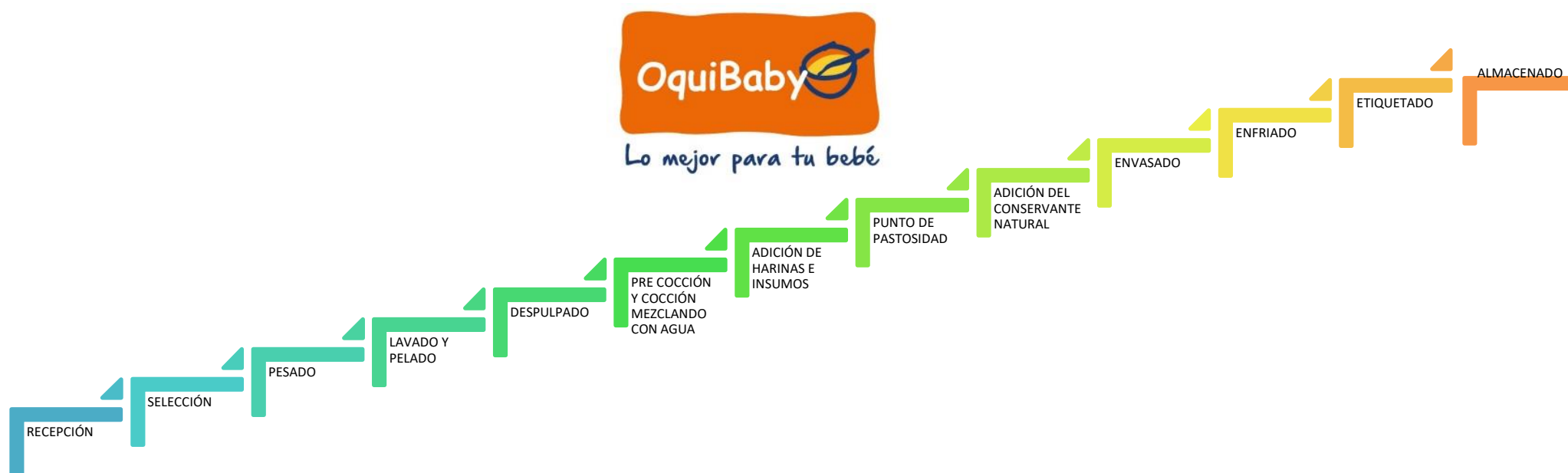
Figura 50. Diagrama de flujo proceso de producción
