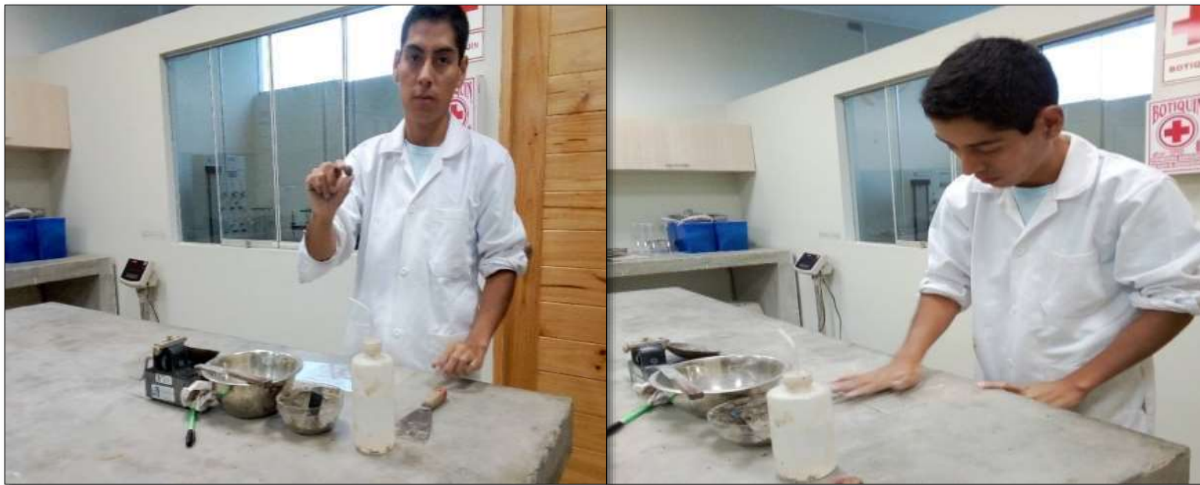
Figura N° 36: Desarrollo del ensayo de límite plástico (LP).
