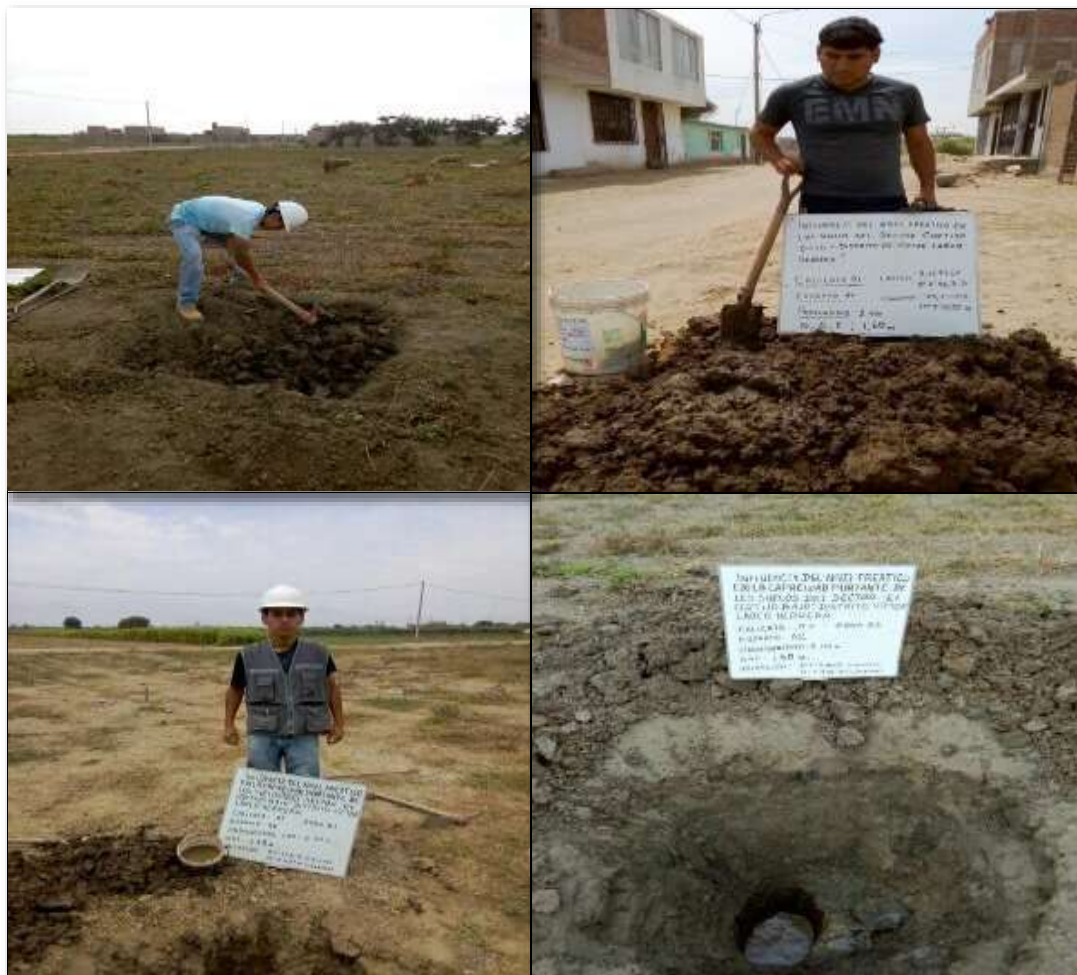
Figura N° 27: Excavación de calicatas en los sectores de estudio.
