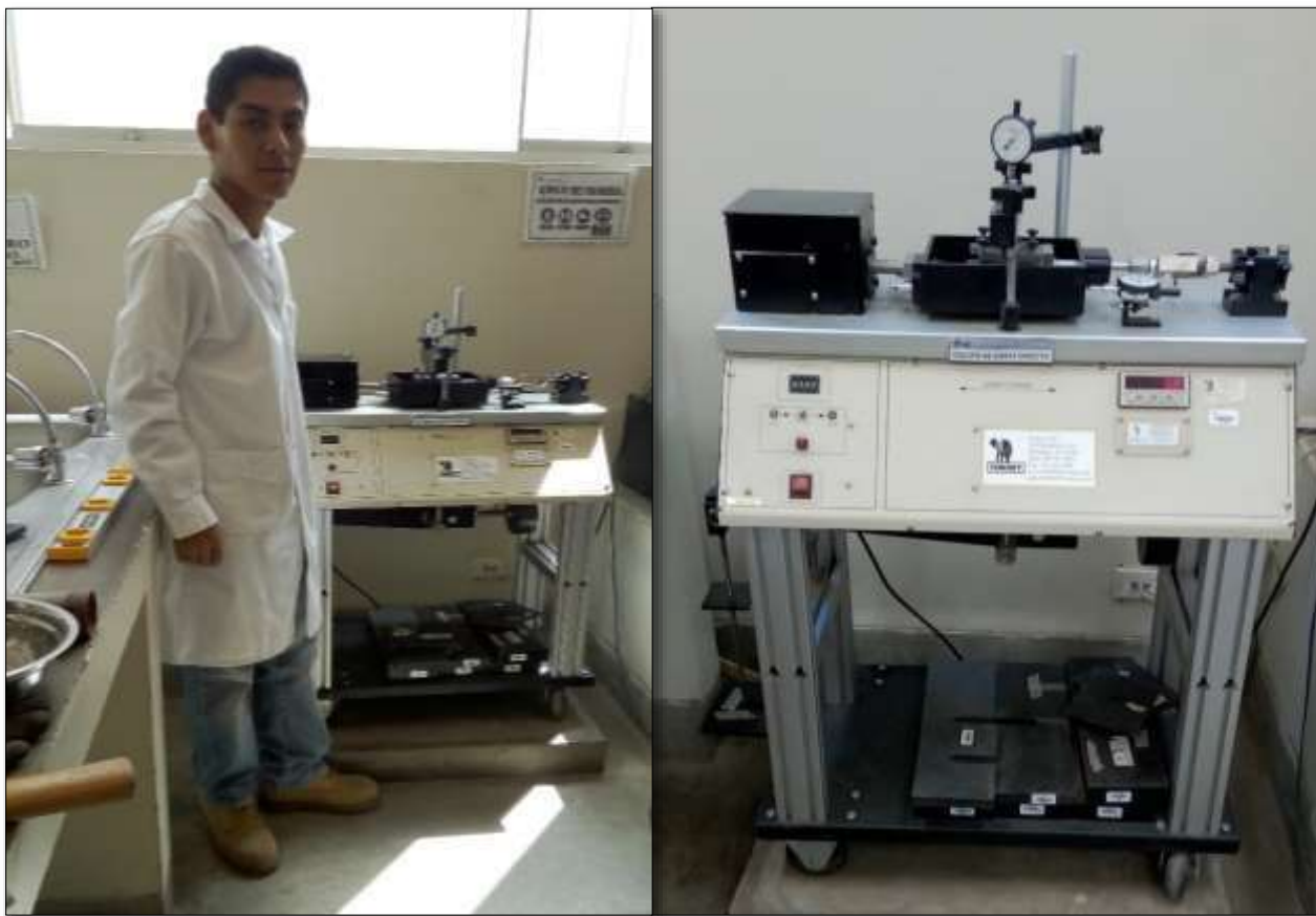
Figura N° 38: Reconocimiento del Equipo de Corte Directo.
