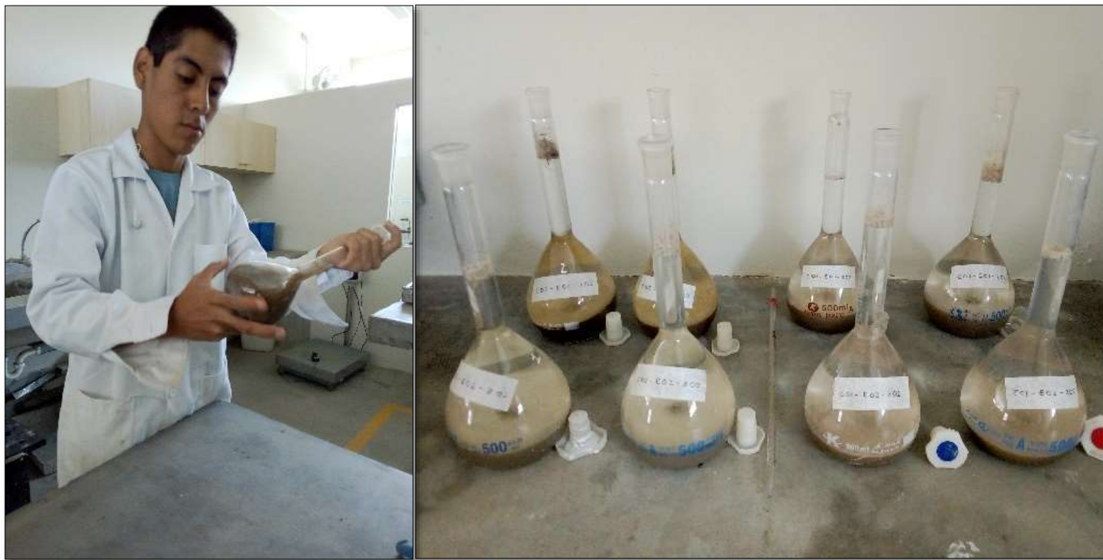
Figura N° 32: Desarrollo de ensayo de peso específico.
