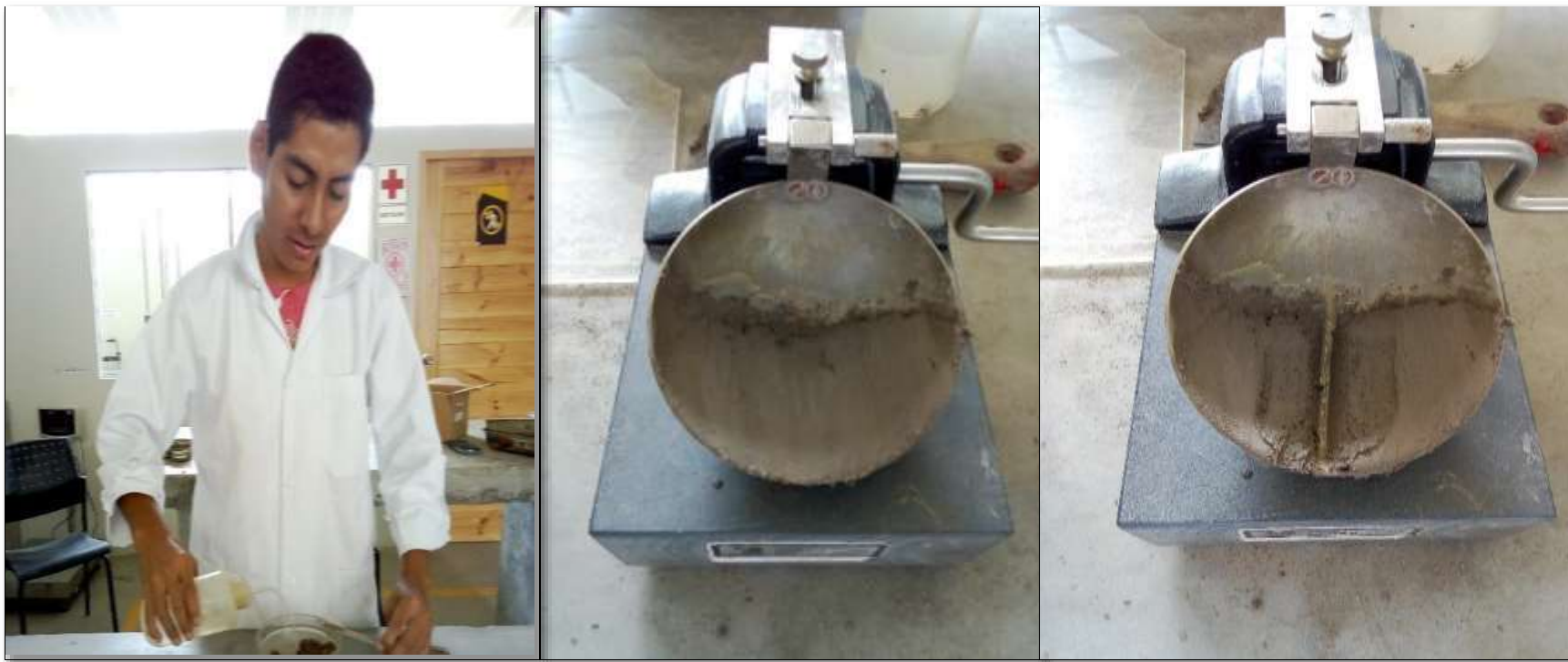
Figura N° 35: Desarrollo del ensayo de límite líquido (LL).
