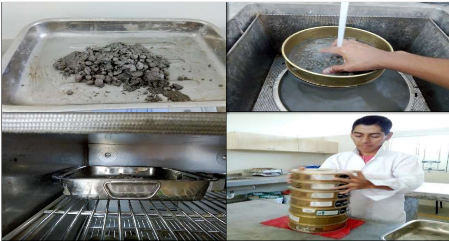
Figura N° 33: Desarrollo de ensayo de análisis granulométrico.
