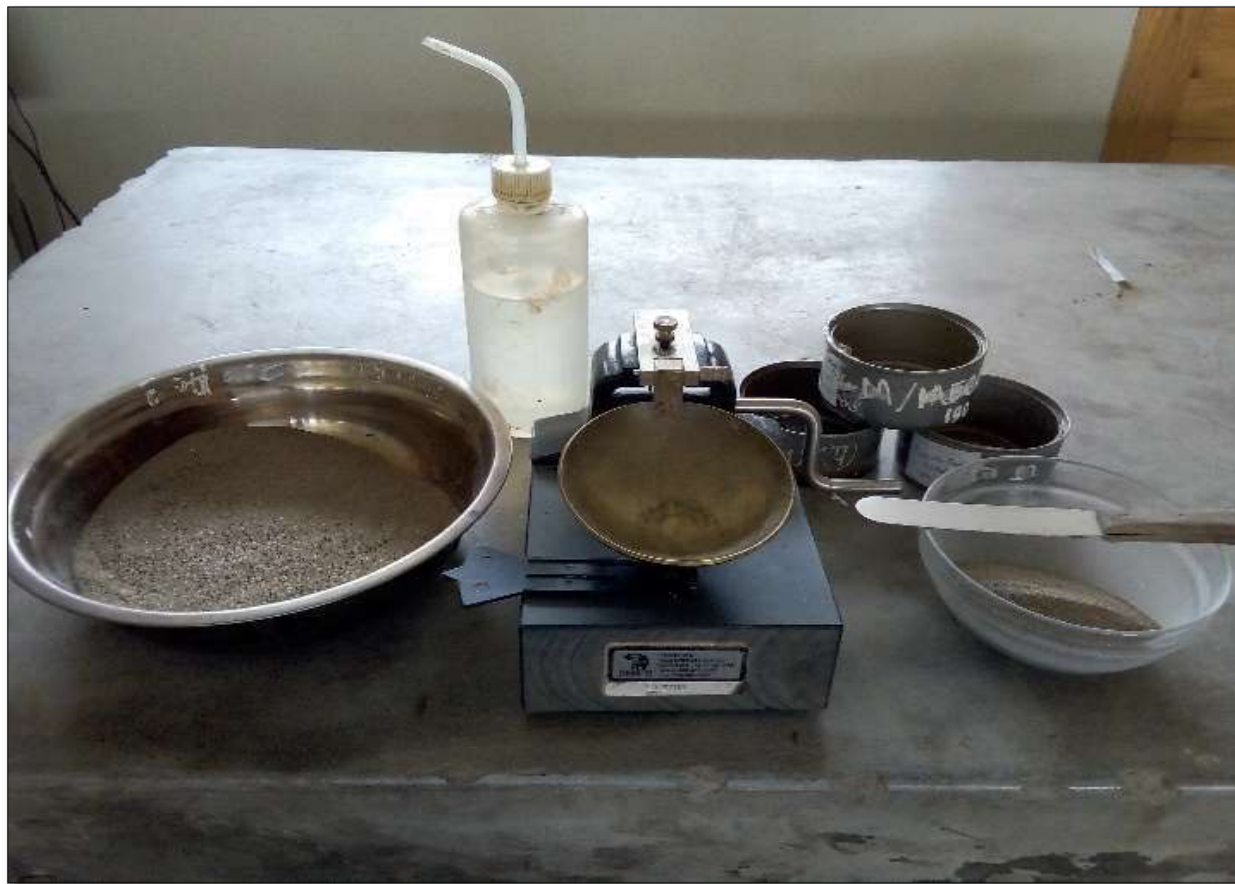
Figura N° 34: Ensayo de límites de Atterberg - Equipo y muestra para desarrollar.
