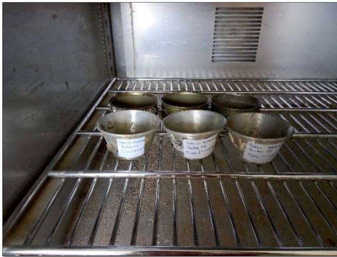
Figura N° 31: Desarrollo de ensayo de contenido de humedad.
