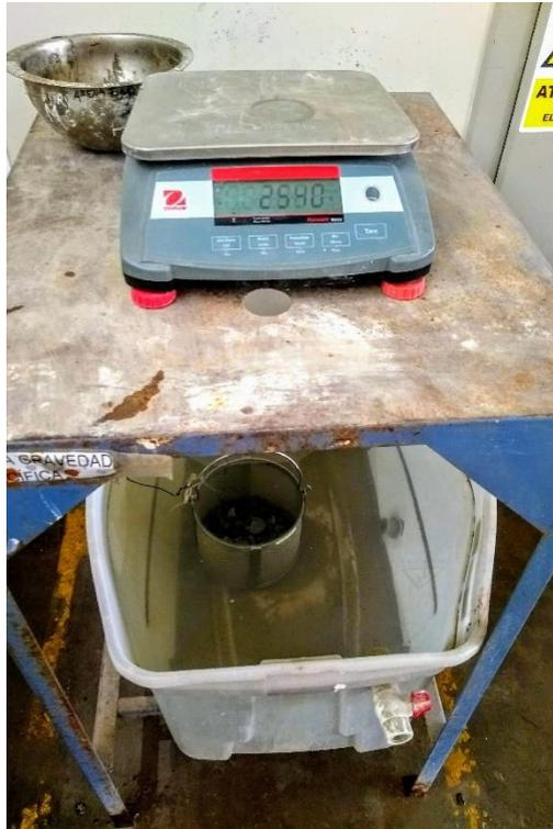
**Figura N° 72:** Peso específico de agregado fino.
