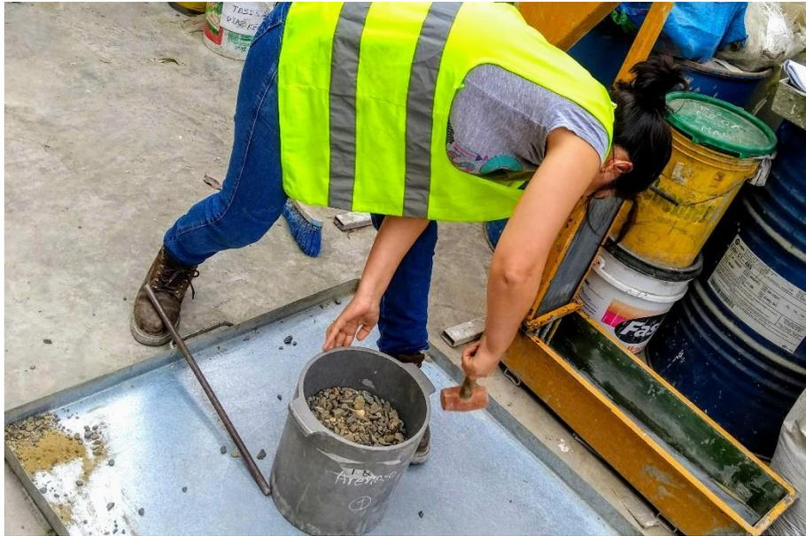
**Figura N° 70:** Peso unitario suelto de agregado fino.
