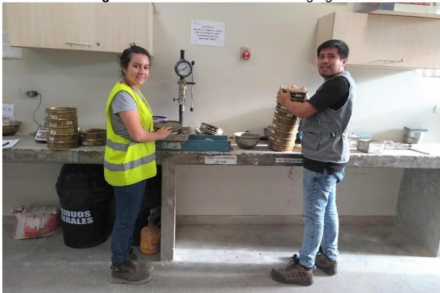
**Figura N° 69:** Peso unitario compactado de agregado grueso
