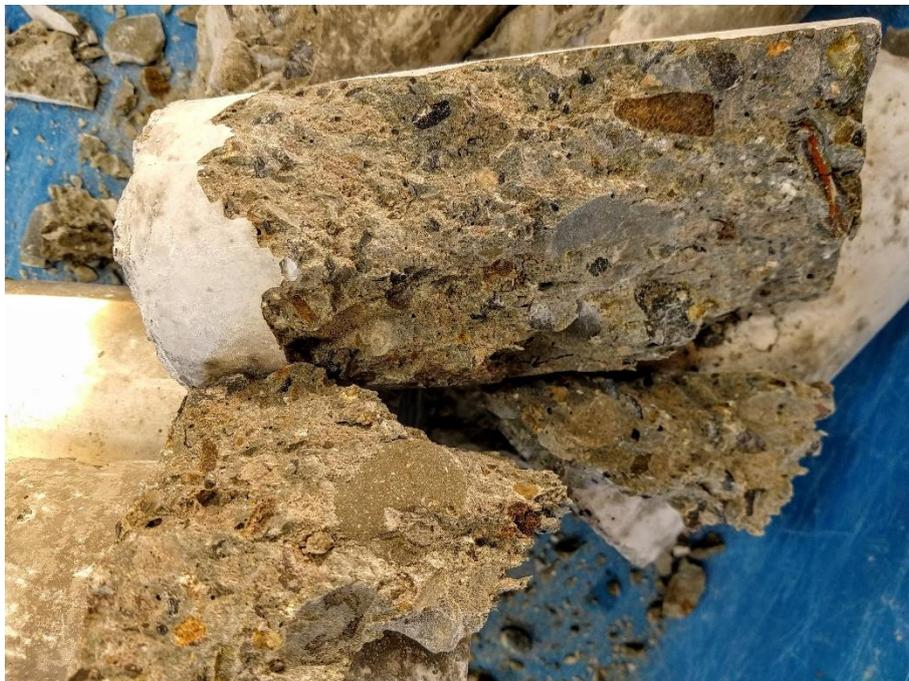
**Figura N° 83:** Corte de probetas para ensayo de succión capilar.
