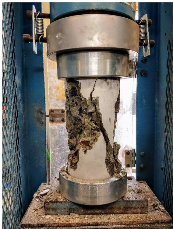
**Figura N° 81:** Ensayo de resistencia a la compresión.
