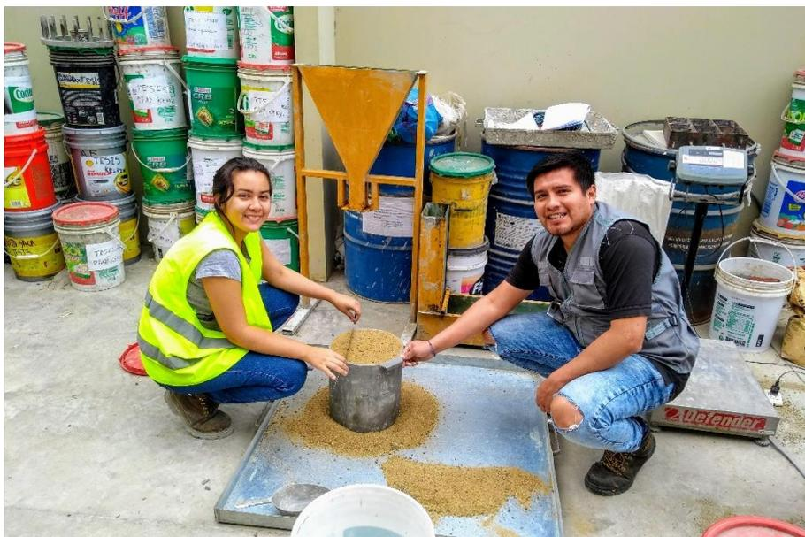
**Figura N° 71:** Peso específico de agregado reciclado.
