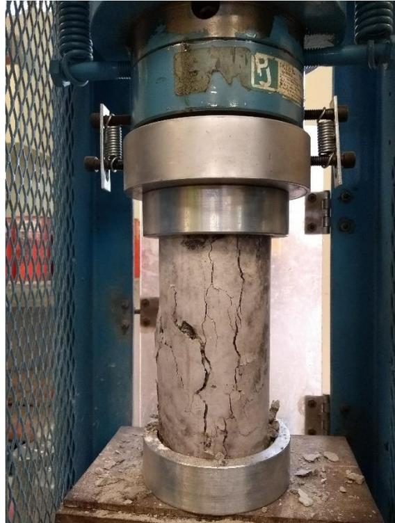
**Figura N° 80:** Ensayo de resistencia a la compresión.
