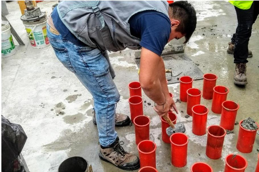
**Figura N° 78:** Curado de probetas.
