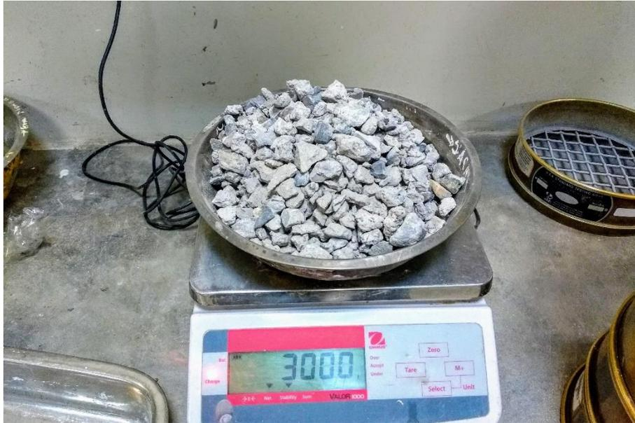
**Figura N° 68: Tamizado manual de agregado.**
