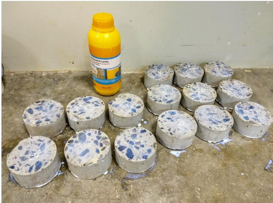
**Figura N° 85:** Ensayo de succión capilar.
