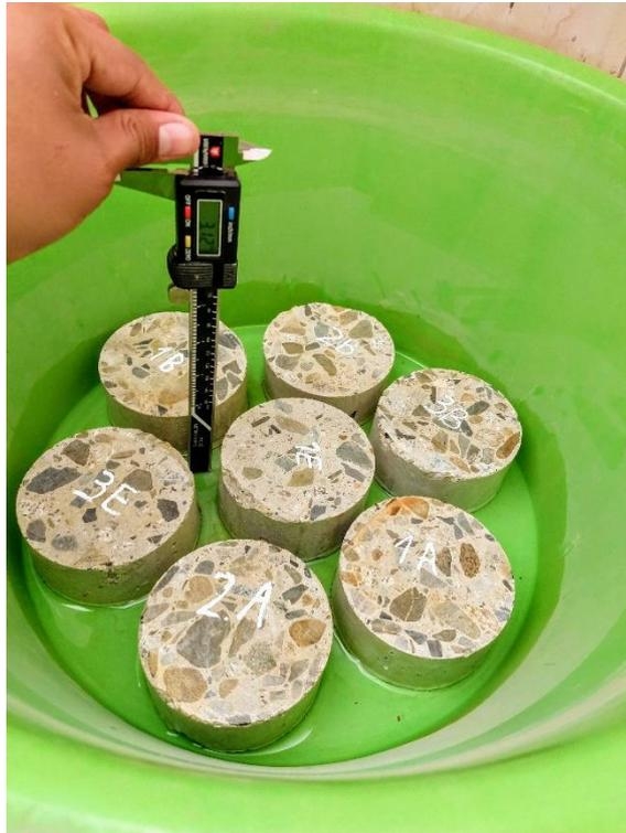
**Figura N° 86:** Pesaje de probeta para ensayo de succión capilar.
