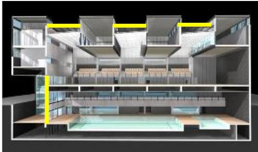
Figura n.º 1. Corte tridimensional de gimnasio vertical – elementos de captación de luz natural.
