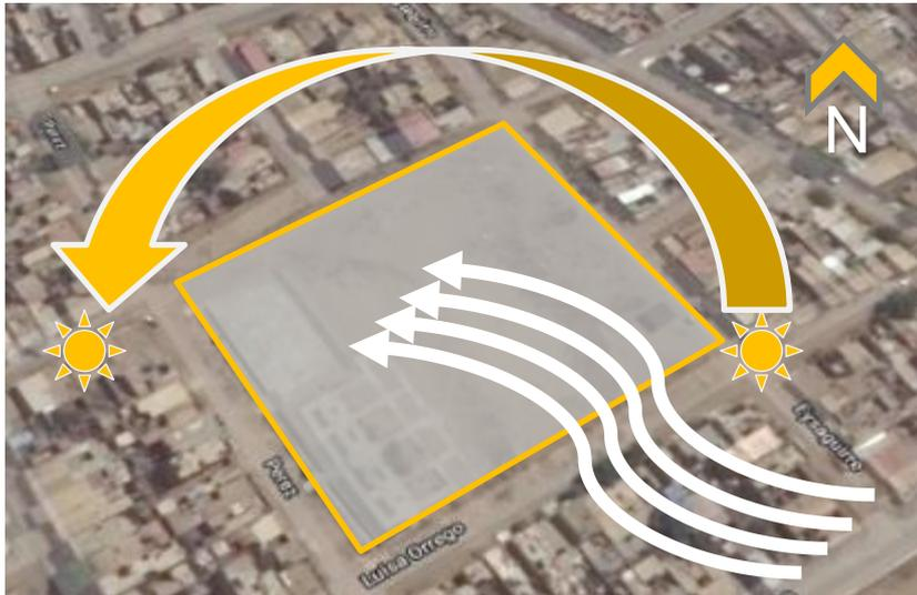
Figura n.º 21. Análisis de asoleamiento del terreno.
