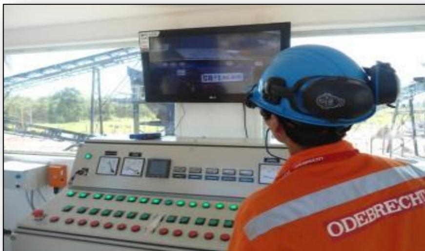
Figura 166: Imagen mostrando los indicadores de presión y temperatura
