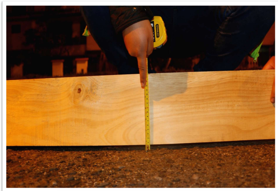
Fotografía N° 18: Falla de Depresión en la Unidad 7
