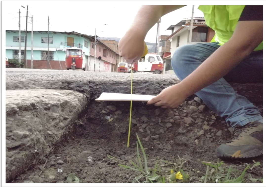
Fotografía N° 37: Perfil de pavimento
