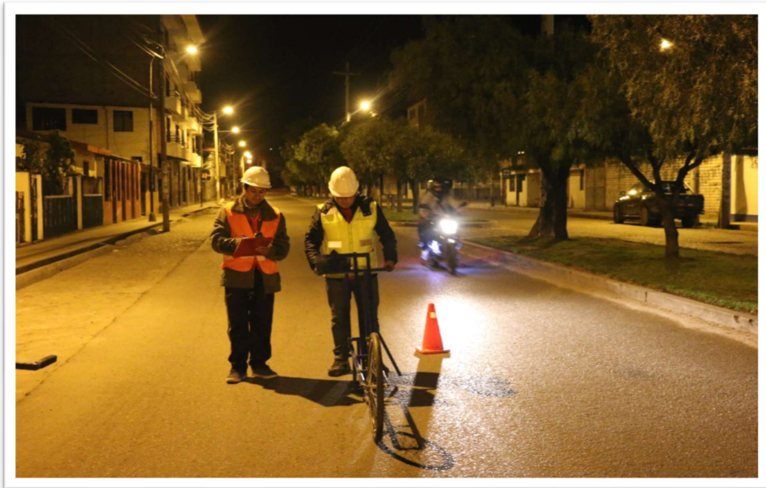
Fotografía N° 12: Rugosímetro de Merlín
