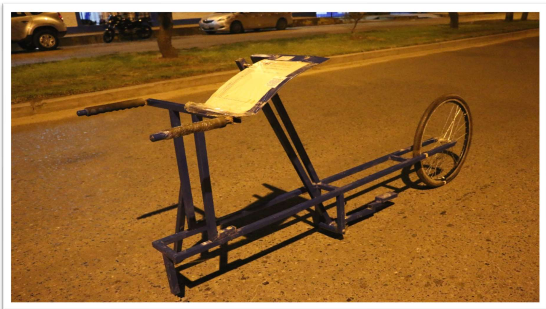
Fotografía N° 12: Rugosímetro de Merlín
