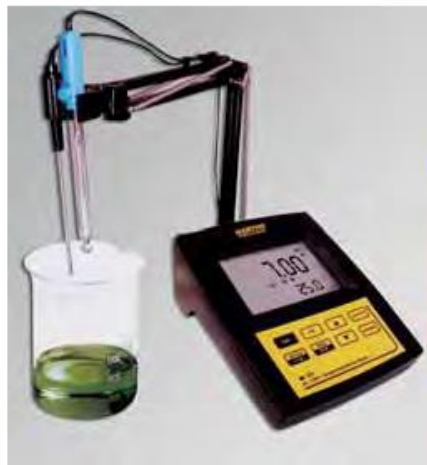
Figura 21. Medidor pH de líquidos La figura representa un equipo para determinar el grado de acidez del producto antes de fermentación. Tomado del catálogo de maquinaria para destilar mucilago de cacao (2018).
