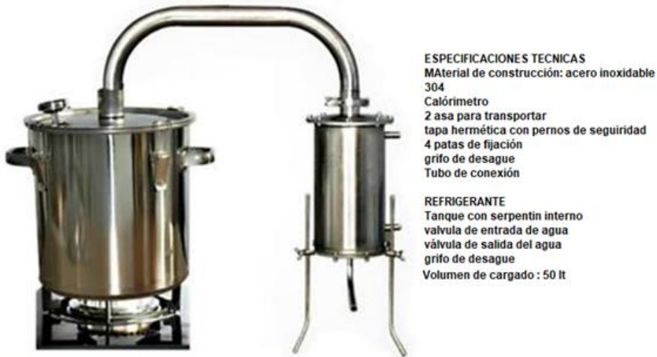
Figura 18. Alambique para destilar
