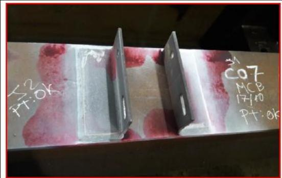
IMAGEN N° 2: Nos muestra la aplicación del tinte en la junta
