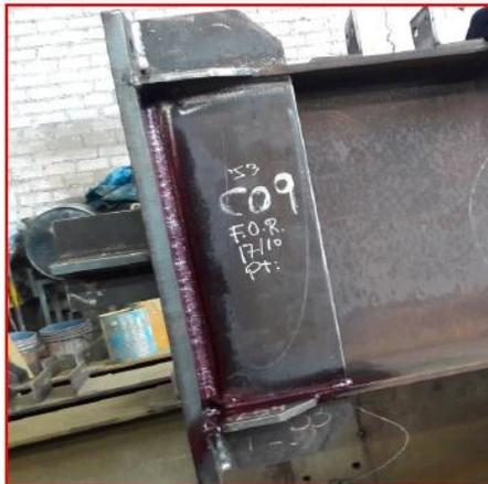
IMAGEN N° 3: Nos muestra la aplicación del tinte en la junta
