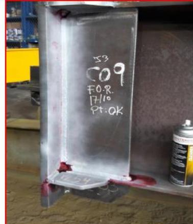
IMAGEN N° 4: Nos muestra la aplicación del tinte en la junta
