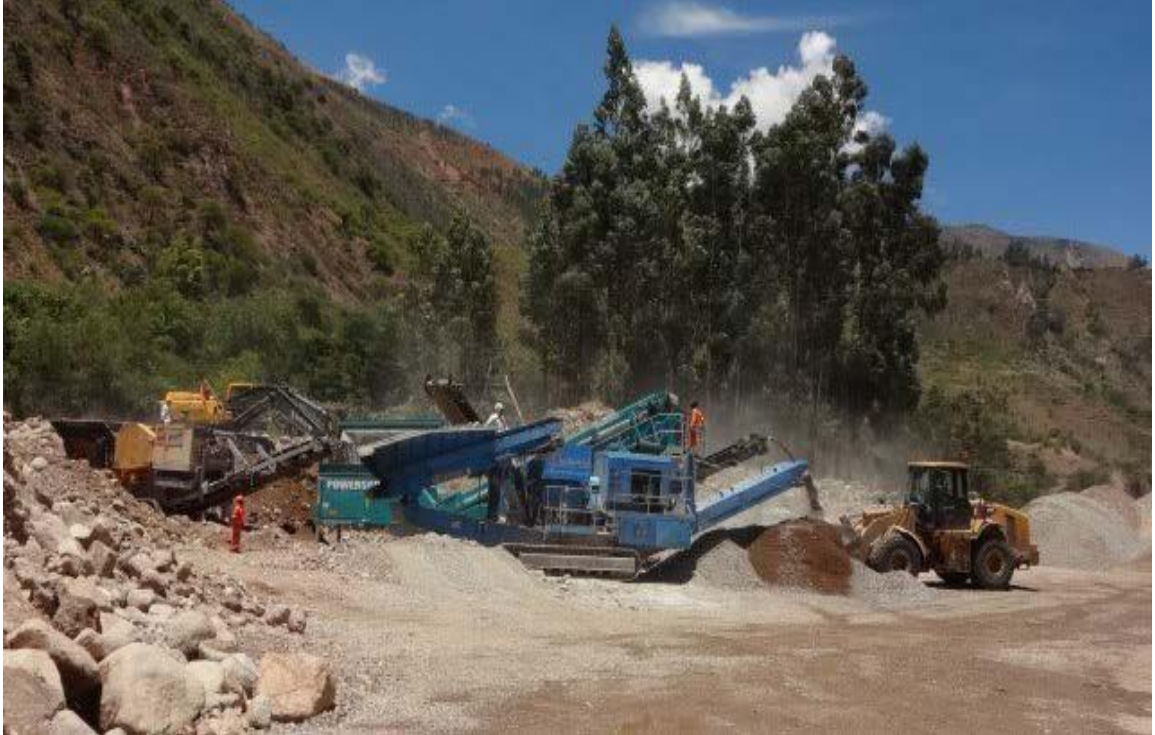
Figura n.º 4. 2 Propuesta de mejora, trituración primaria, secundaria, terciaria, y cribado.
