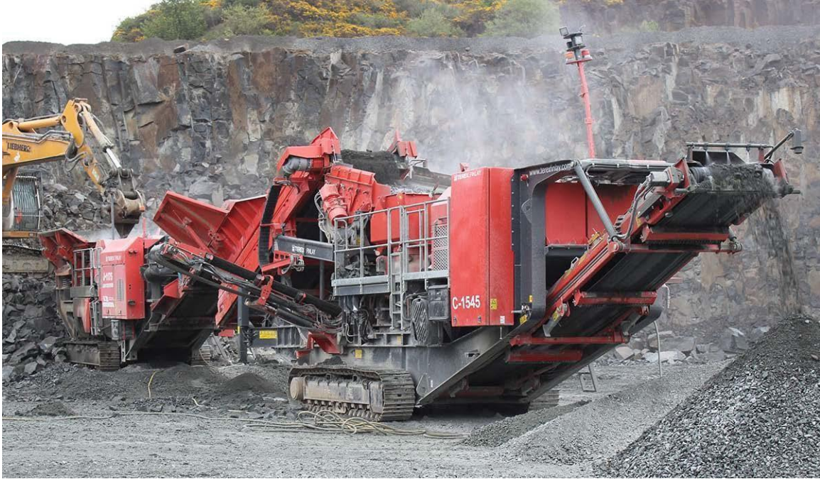
Figura n.º 1. 2 Planta móvil de procesamiento de agregados
