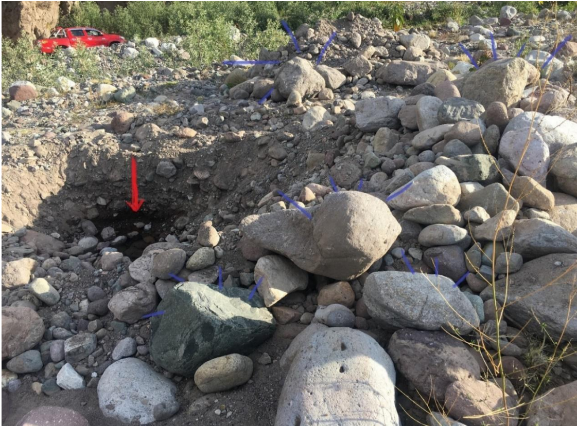
Figura n.º 3. 18 Calicata con presencia de agua y rocas grandes
