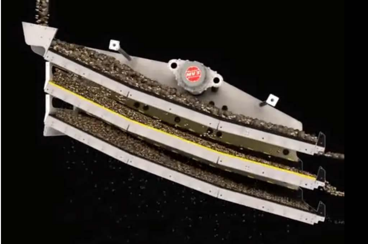
Figura n.º 2. 5 Zaranda vibratoria de tres niveles
