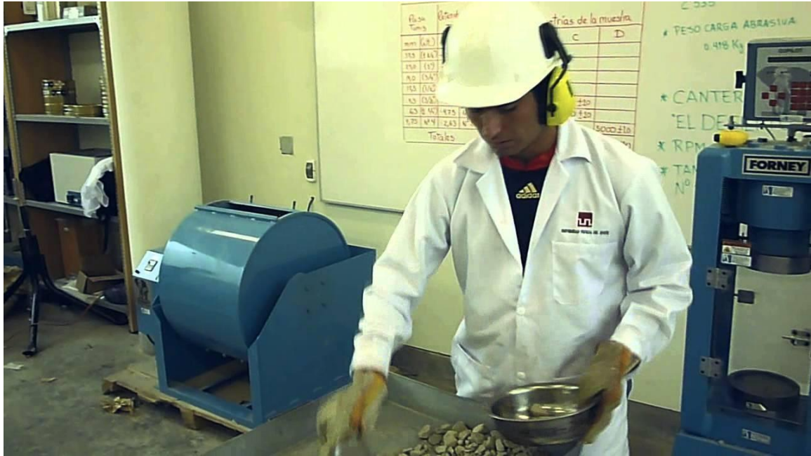
Figura n.º 3. 20 Ensayo de abrasión de los Ángeles
