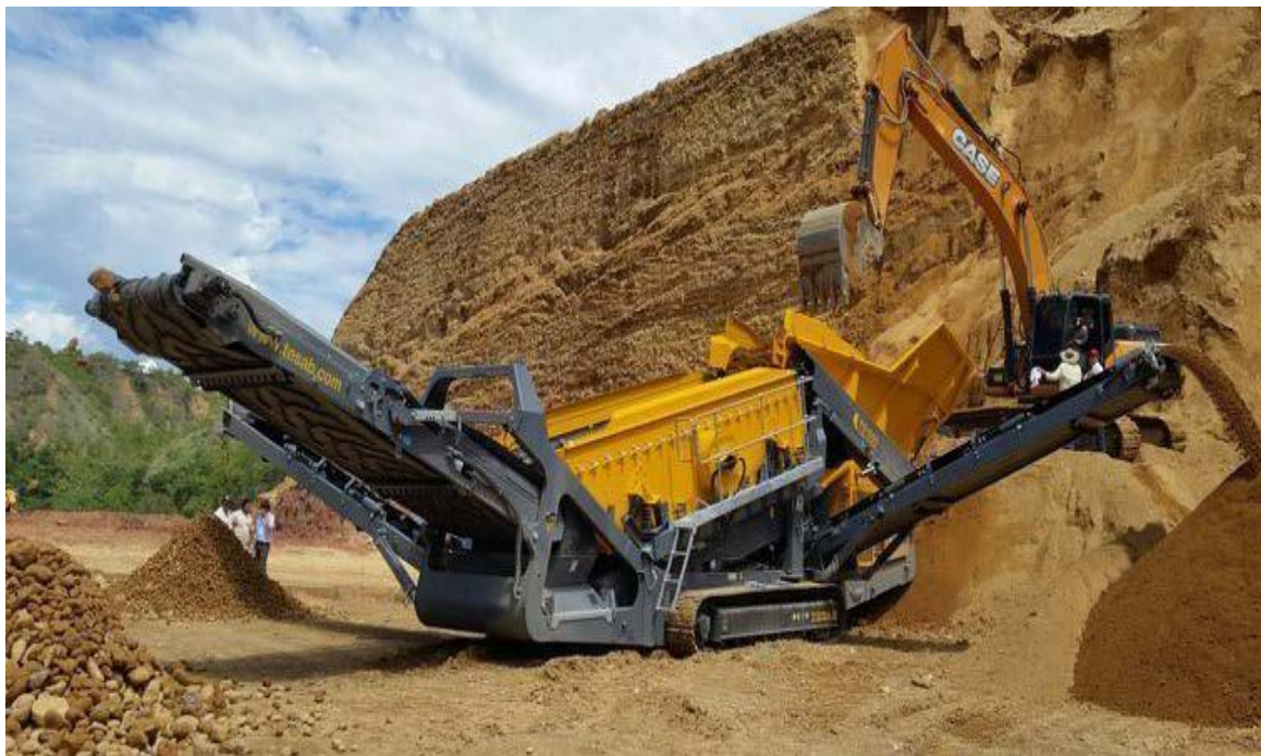
Figura n.º 3. 8 Zaranda Scalper, equipo especial para separación de material grueso
