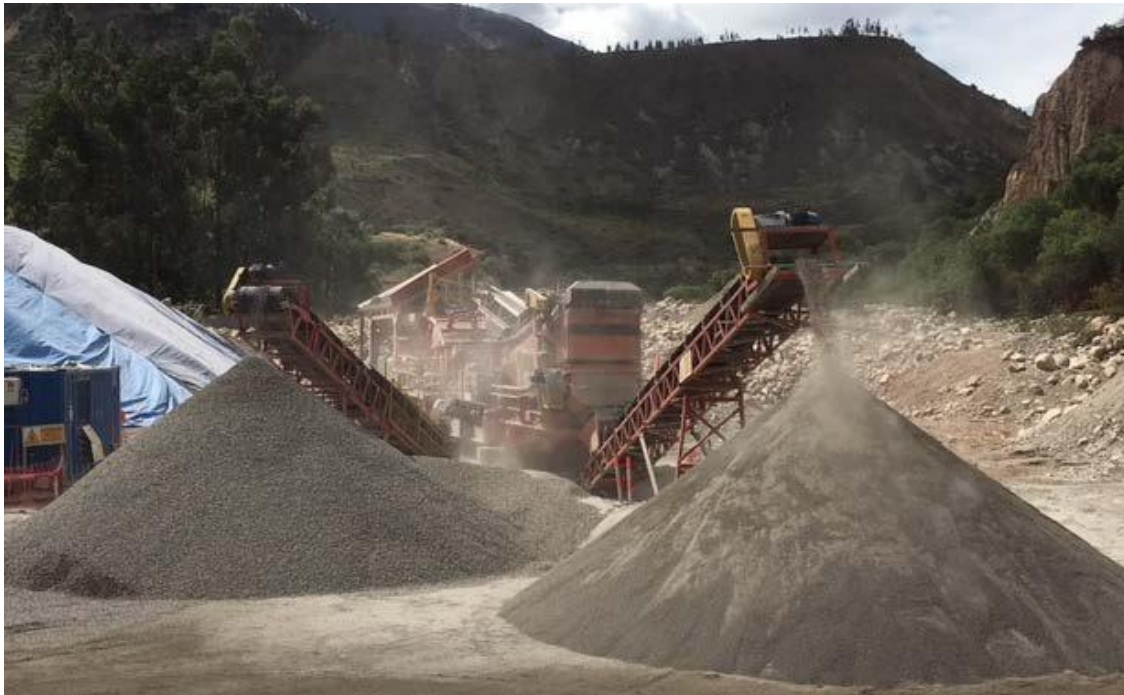
Figura n.º 3. 11 Productos que se obtienen en la planta chancadora de impacto (HSI)
