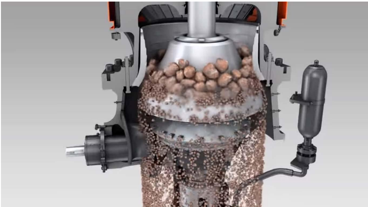
Figura n.º 2. 2 Trituradora tipo cónica en pleno trabajo quebrando la roca
