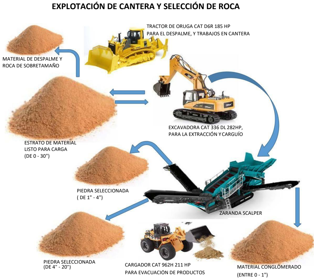
Figura n.º 3. 22 Propuesta de mejora para la etapa de explotación de cantera
