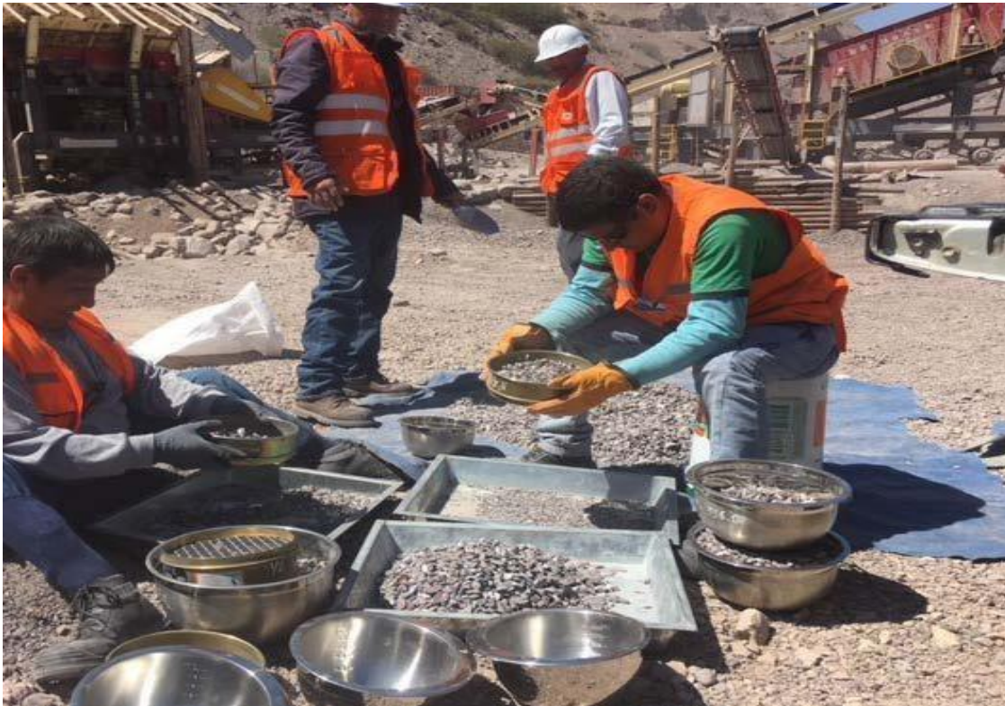
Figura n.º 3. 21 Ensayos granulométricos en campo, grava/arena
