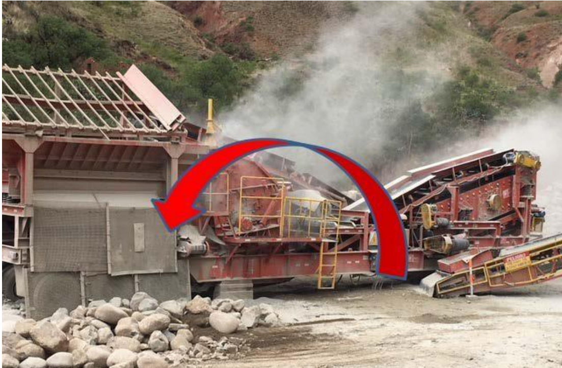
Figura n.º 3. 9 Chancadora de impacto (HSI) EAGLE Jumbo UM 1200–25 CC
