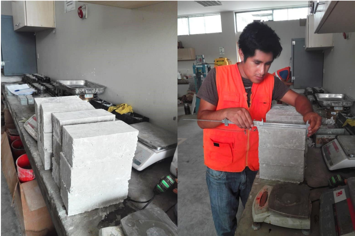
Figura 32: Medición de los adoquines
