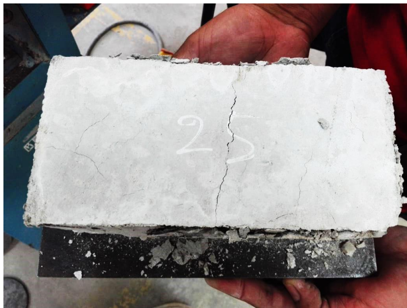
Figura 34: Falla del adoquin a la resistencia a la compresión, vista en planta
