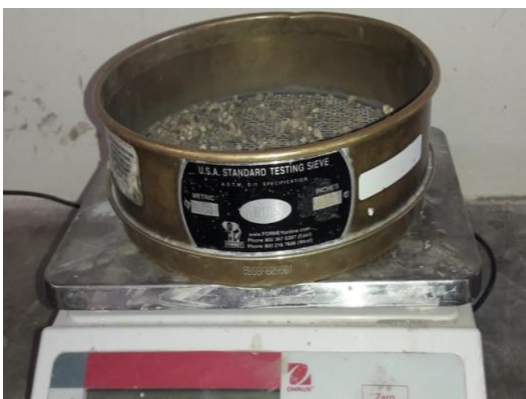
Figura N° 02.6: Tamiz de 3/8” + agregado retenido.
