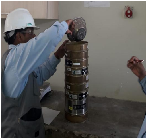
Figura N° 02.5: Tamizado del agregado fino.
