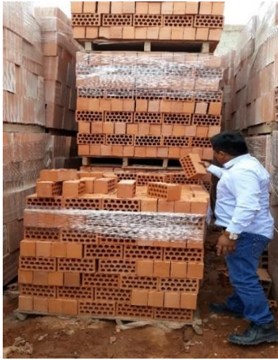
Figura N° 01.1: Selección de ladrillos King Kong 18 huecos Marca Lark para los ensayos.
