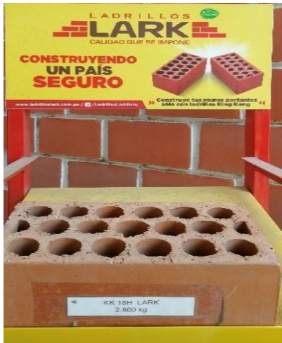
Figura N° 01.2: Compra del Ladrillo King Kong marca Lark 18 huecos al 50 % para los ensayos.
