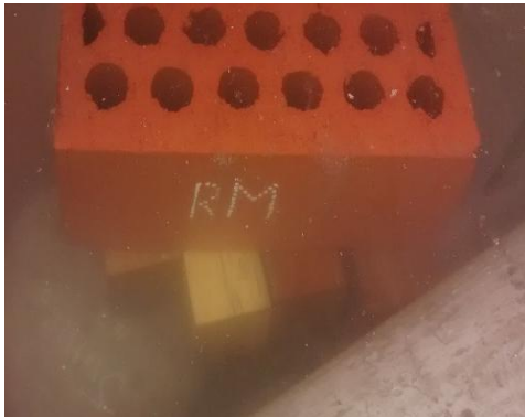
Figura N° 03.1: Unidad de albañilería sumergido en agua para el ensayo absorción.
