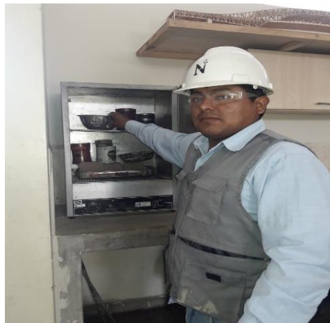
Figura N° 03.3: Horno para los ensayos de contenido de humedad, PEA, absorción del agregado fino.
