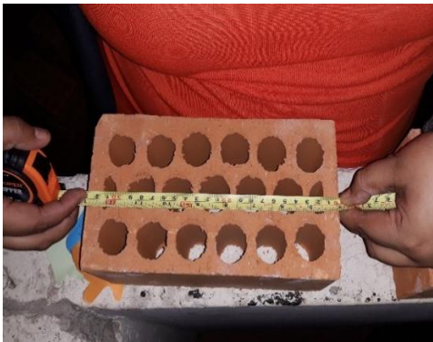
Figura N° 03.2: Ensayo de variación dimensional del ladrillo King Kong 18 huecos, aplicando la NTP 399.613.
