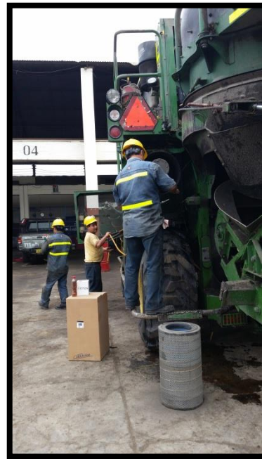
Figura 47: Cambio Filtro de aire primario. Fuente: División Mantenimiento
