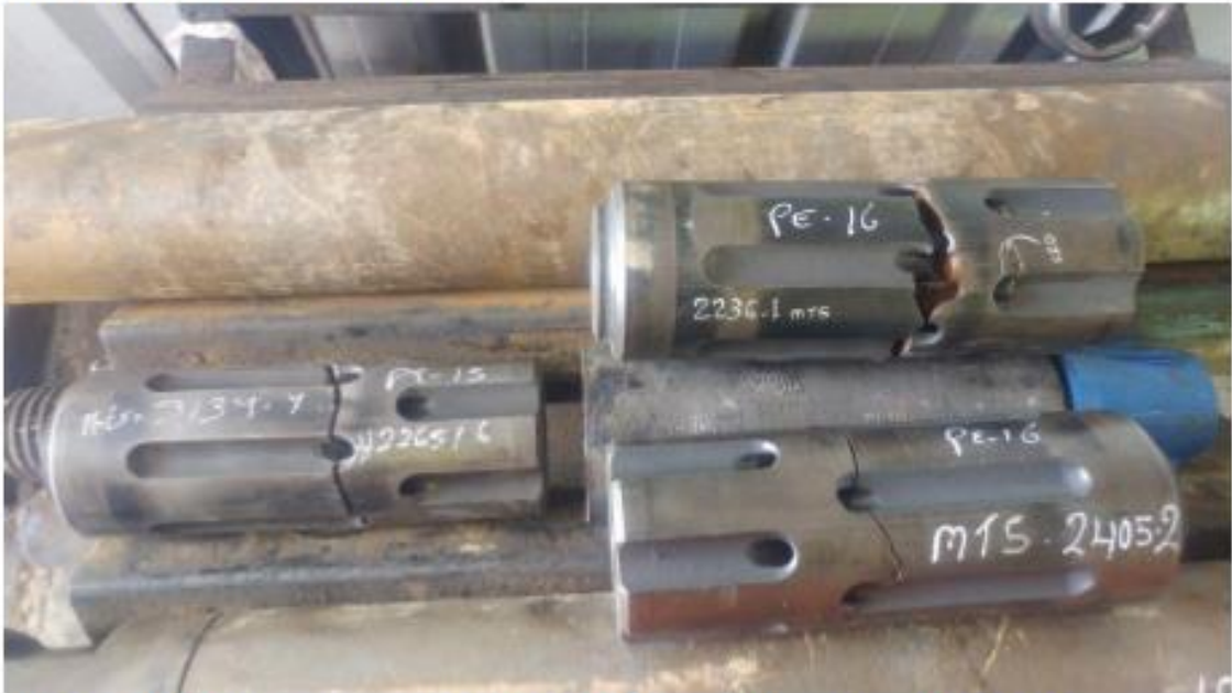
Foto 2. Evidencia del pistones NUMA rotos tango de la PE-15 como también de la PE-16.
