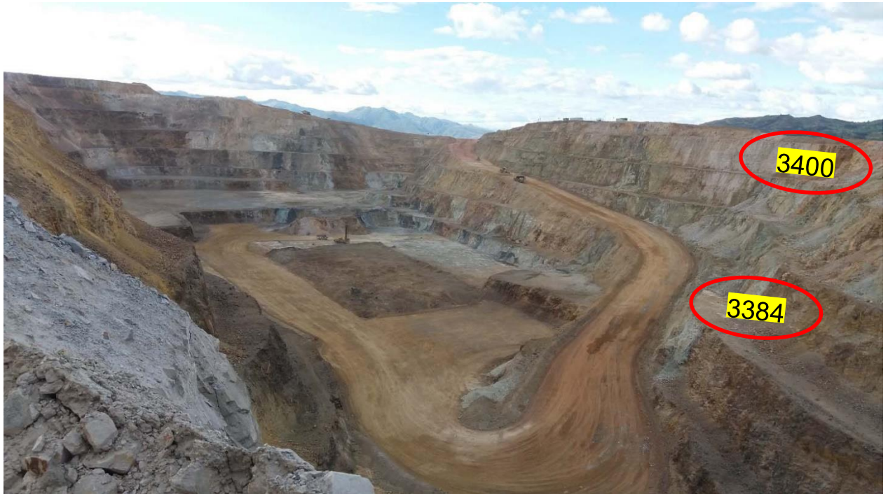
Figura 19. Bancos que se trabajaron los aceros DTH, en fase 05 del tajo de la mina modelo de Huamachuco.
