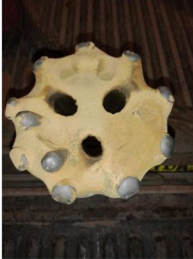
Foto 2. Desgaste prematuro de la broca Atlas Copco.
