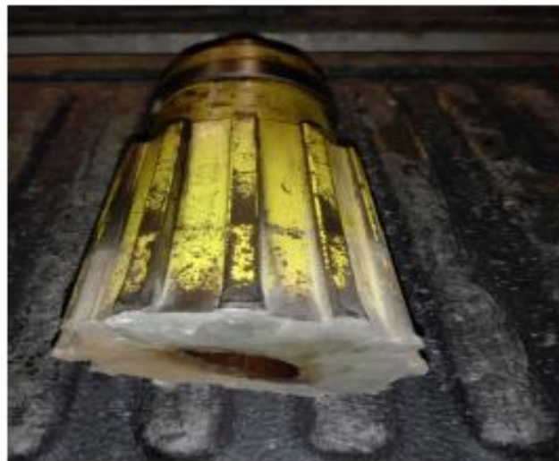
Foto 1. Rotura de cabeza de broca atlas Copco.
