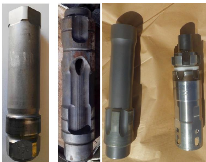
Figura 9. Pistón de Martillo DTH con tubo interno y sin tubo externo.
