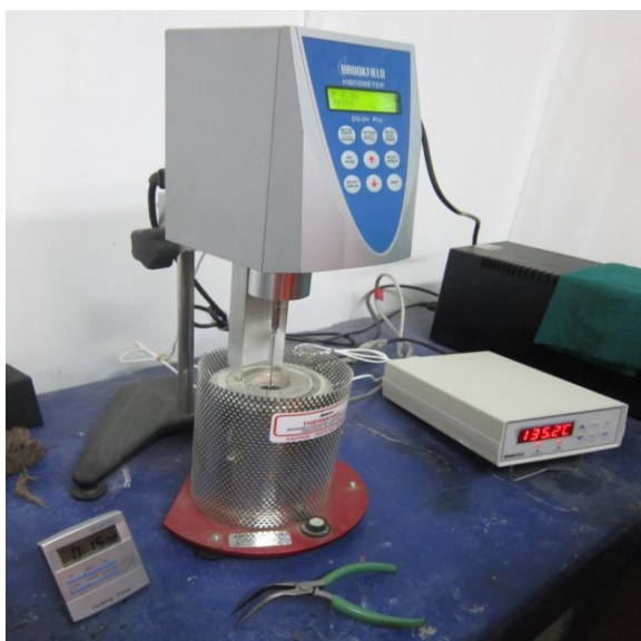
Figura n.º 22. Ensayo de viscosidad Brookfield Nota: Inicio del ensayo a 135°C Elaborado por los Autores
