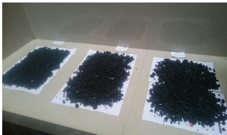
Figura n.º 31. Mezcla fría para ensayo RICE.
