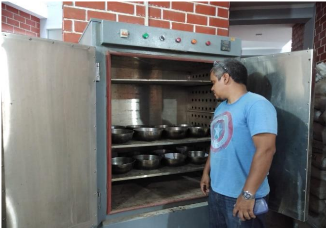
Figura n.º 24. Mezcla de agregados ya pesados y calientes Nota: Colocación de agregados a calentar a 150°C para ser chancado Elaborado por los Autores
