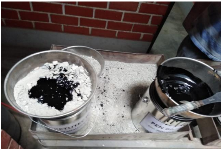
Figura n.º 25. Colocación del ligante asfáltico a la mezcla de agregados Nota: Mezcla de agregado y asfalto en estufa Elaborado por los Autores
