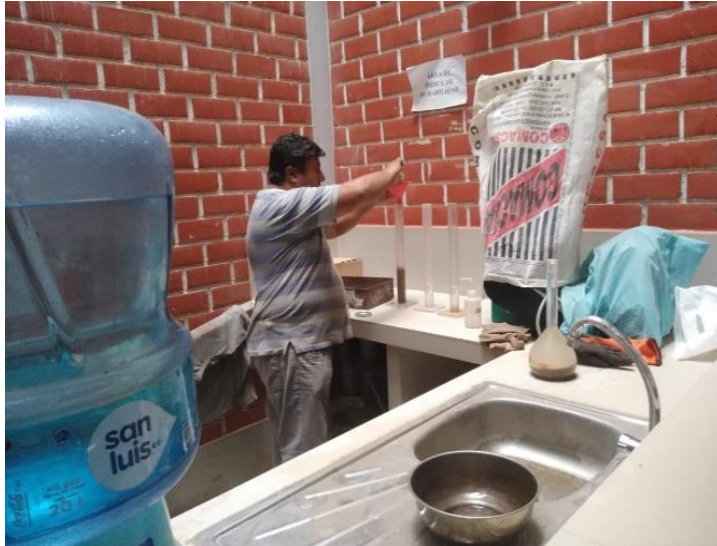
Figura n.º 15. Equivalente de arena Nota: Vaciado de material fino a las probetas Elaborado por los Autores
