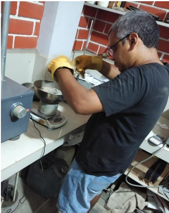
Figura n.º 23. Pesado de los agregados para diseño Nota: Mezcla de agregados y asfalto pesados para su mezcla Elaborado por los Autores
