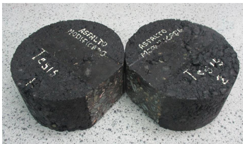
Figura n.º 54. Especímenes de ensayo asfalto modificado. Elaborado por los Autores
