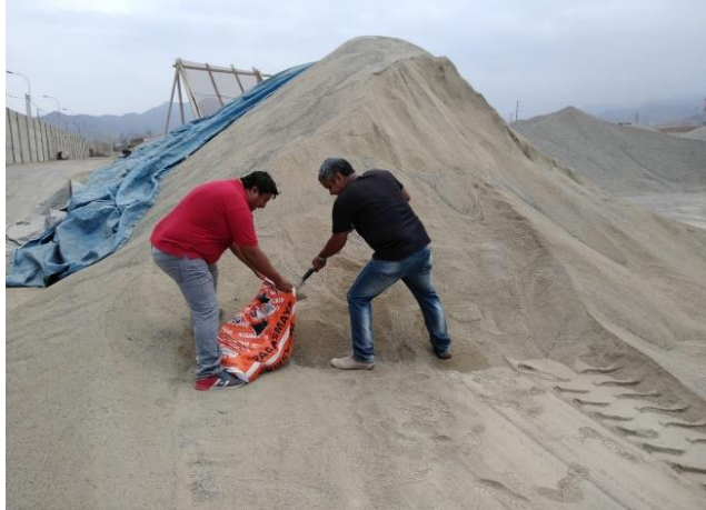
Figura n.º 11. Muestreo de agregado fino. Nota: Recolección del material fino para su análisis Elaborado por los Autores
