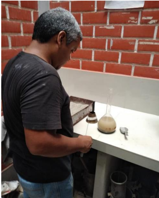
Figura n.º 19. Agregado + agua en la Fiola Nota: Asentamiento de finos en la Fiola Elaborado por los Autores
