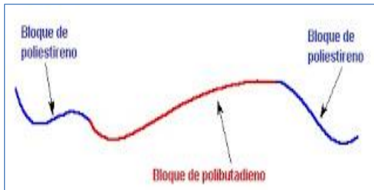
Figura n.º 3. Bloque de polibutadieno. Adaptado de “SBS Tecnología de los Plásticos”, 2011. Recuperado de http://tecnologiadelosplasticos.blogspot.com/2011/12/sbs.html
