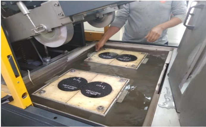
Figura n.º 43. Colocación de especímenes para ensayo a 50°C.
