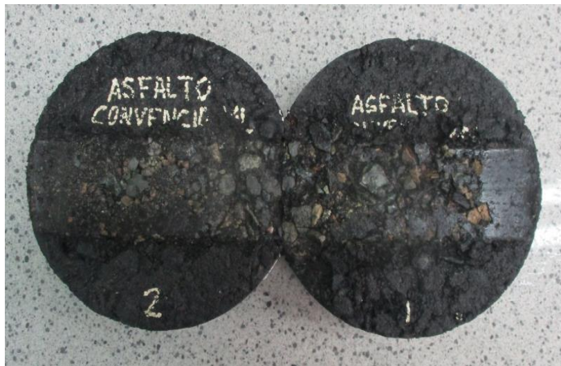
Figura n.º 57. Especímenes de ensayo asfalto convencional Nota. Briquetas después de ensayo de Rueda de Hamburgo Elaborado por los Autores
