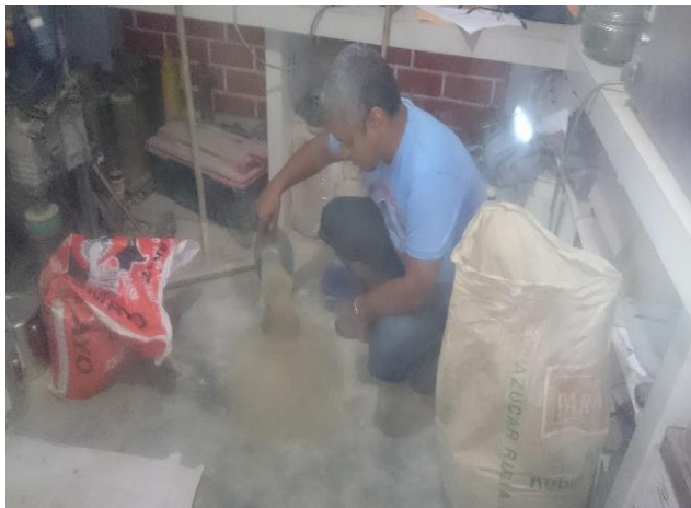
Figura n.º 12. Cuarteo de agregados canteras Rumi – Crushing. Nota: Agregado fino sino cuarteado para su granulometría Elaborado por los Autores
