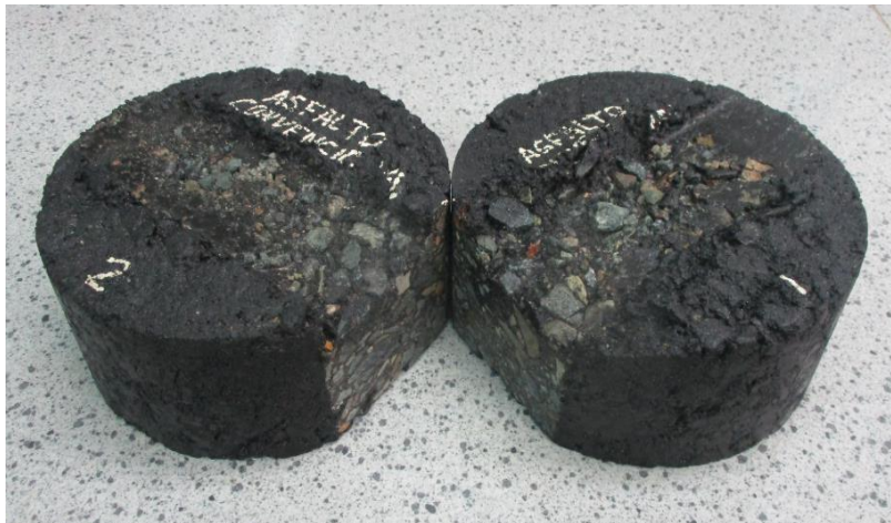
Figura n.º 58. Especímenes de ensayo asfalto convencional Elaborado por los Autores
