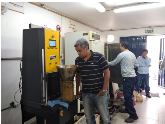
Figura n.º 36. Molde con muestra en el compactador giratorio Superpave. Nota: Proceso de compactación buscado vacíos entre 6.0% - 8.0% Elaborado por los Autores
