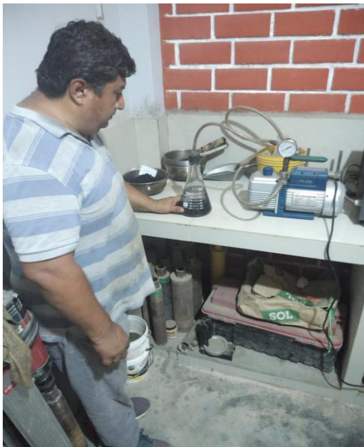
Figura n.º 33. Ensayo RICE. Nota: Ejecución del ensayo de peso específico teórico máximo Elaborado por los Autores
