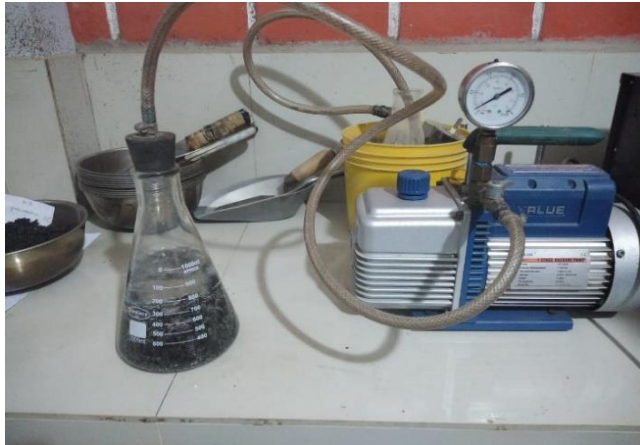
Figura n.º 32. Extracción de aire atrapado a 30 mmHg. Nota: Proceso de eliminación del aire atrapado por 15 minutos Elaborado por los Autores
