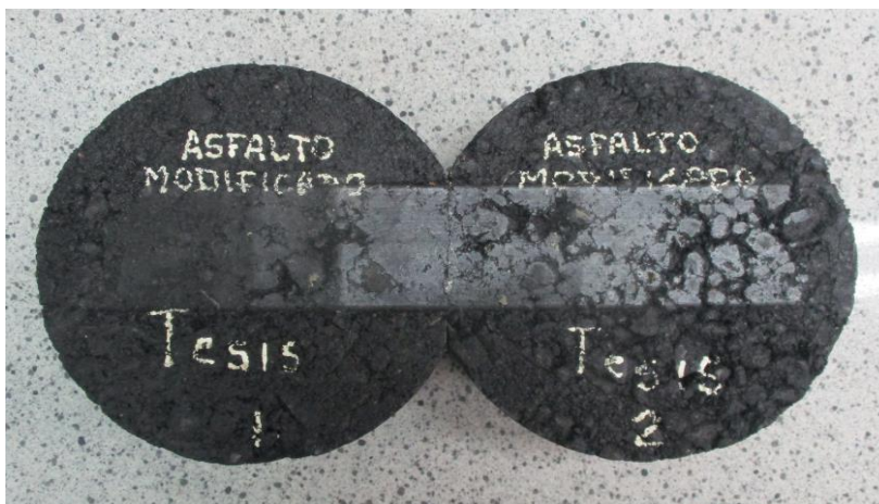
Figura n.º 53. Especímenes de ensayo asfalto modificado. Nota. Briquetas después de ensayo de Rueda de Hamburgo Elaborado por los Autores
