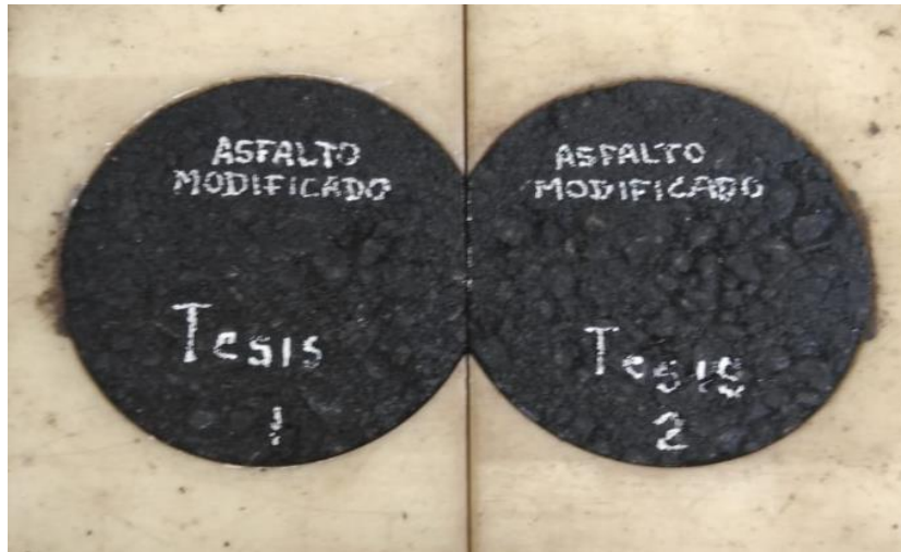
Figura n.º 52. Especímenes de ensayo asfalto modificado. Nota. Briquetas antes de ensayo de Rueda de Hamburgo Elaborado por los Autores
