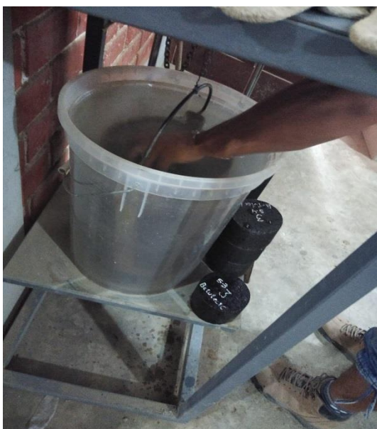
Figura n.º 35. Obtención del peso sumergido. Nota: Briqueta saturada para peso sumergido Elaborado por los Autores
