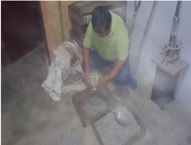
Figura n.º 13. Tamizado de agregados Nota: Agregado grueso siendo tamizado Elaborado por los Autores
