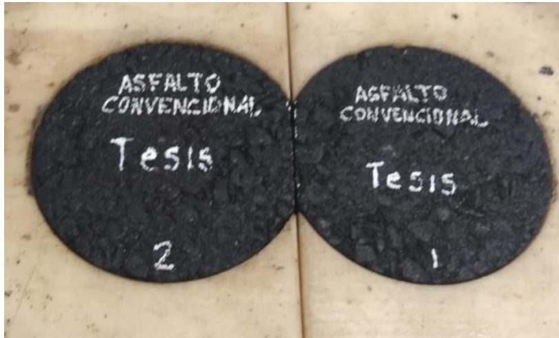
Figura n.º 56. Especímenes de ensayo asfalto convencional. Nota. Briquetas antes de ensayo de Rueda de Hamburgo Elaborado por los Autores
