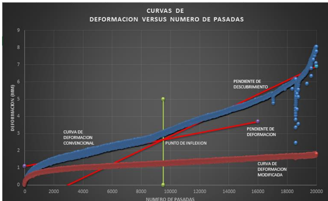
Figura n.º 60. Deformación vs Número de Pasadas. Nota: Comparativo grafico de resultados de ambas mezclas asfálticas Elaborado por los Autores
