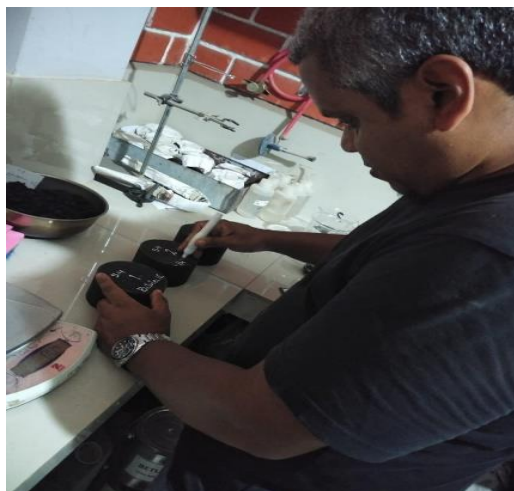
Figura n.º 34. Identificación de briquetas para peso específico. Nota: Proceso de limado de aristas e identificación de briquetas Elaborado por los Autores
