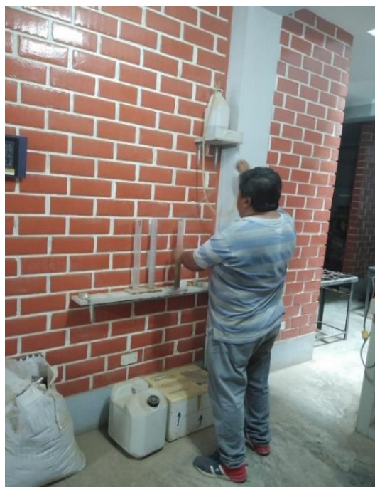
Figura n.º 16. Tubo irrigador Nota: Lavado de finos con el tubo irrigador Elaborado por los Autores
