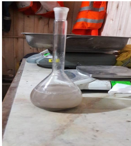
Fig. 4: Ensayo de peso específico con el agregado patrón y reciclado.
