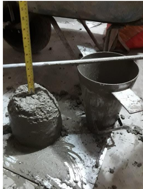
Fig. 8: Medición de asentamiento del concreto fresco.
