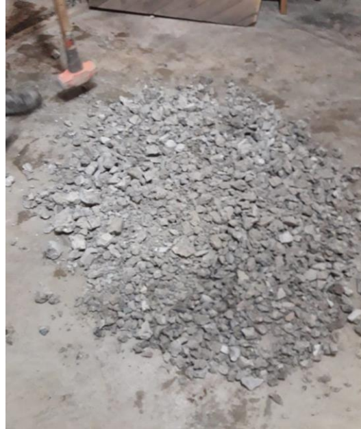
Fig.2: Rotura de projetas de concreto, agregado reciclado.
