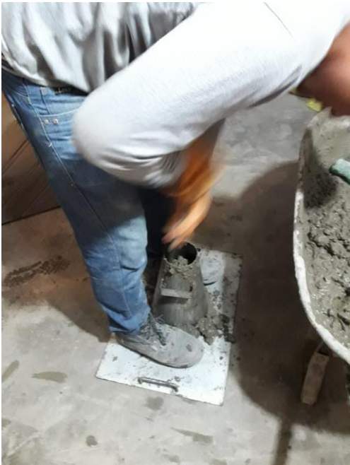
Fig. 7: Medición de asentamiento del concreto fresco.
