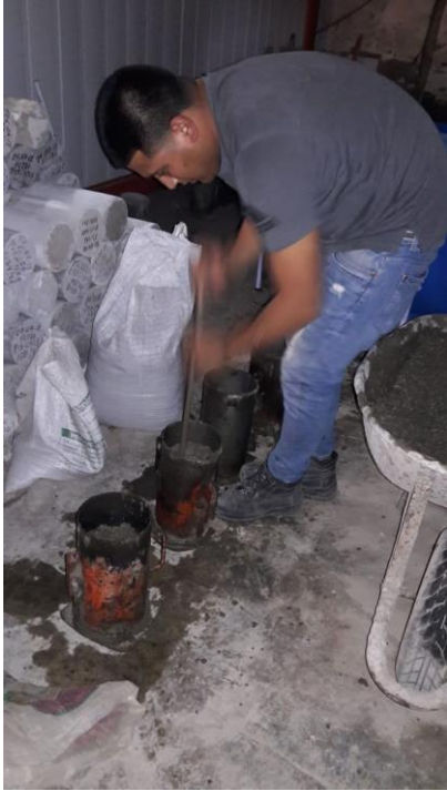
Fig. 9: Preparación de probetas de concreto.
