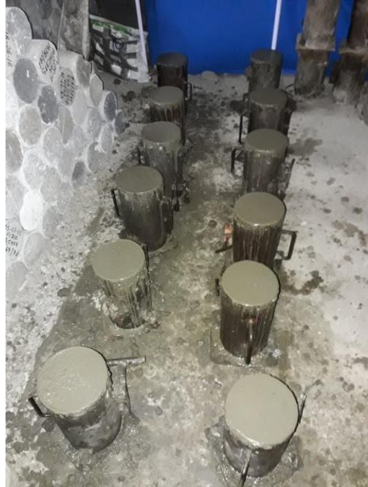
Fig. 10: Probetas de concreto patrón y reciclado.
