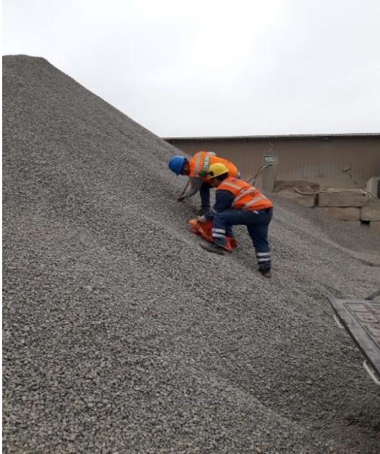
Fig. 1: Toma de muestra del agregado patrón.
