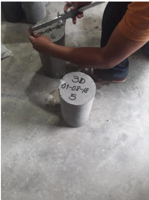
Fig. 11: Medición de diámetro de probetas
