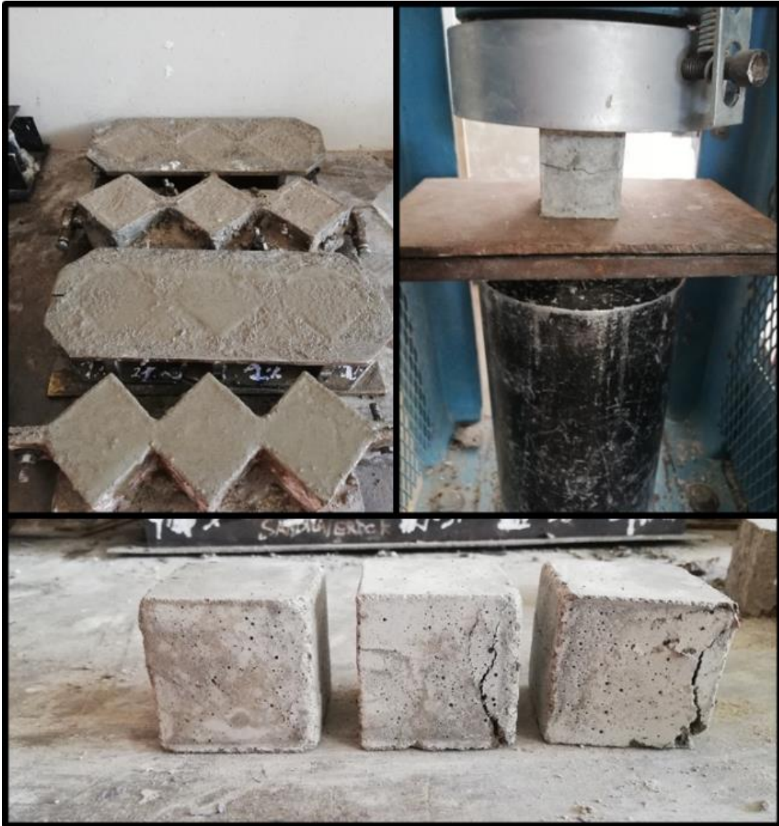
Figura 86: Realización del ensayo de resistencia a la compresión en cubos de mortero seco predosificado
