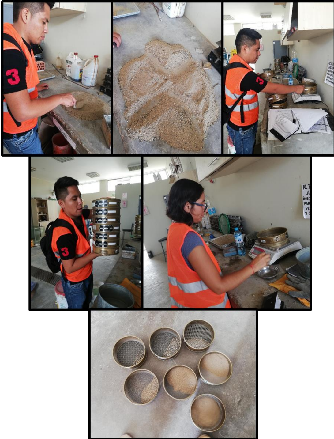
Figura 71: Realización del ensayo de granulometría del agregado fino
