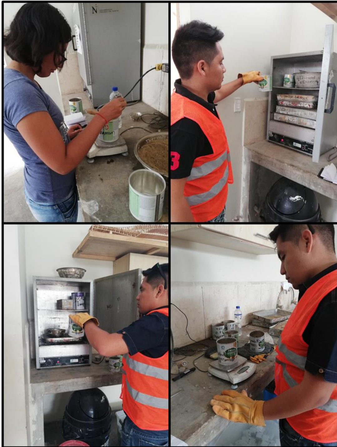
Figura 70: Realización del ensayo de porcentaje de contenido de humedad del agregado fino
