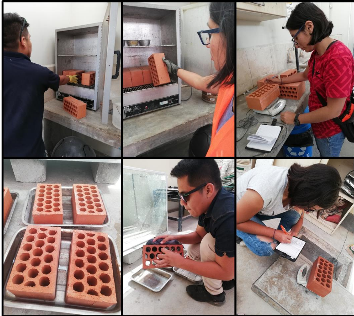
Figura 79: Realización del ensayo de absorción en unidades de albañilería
