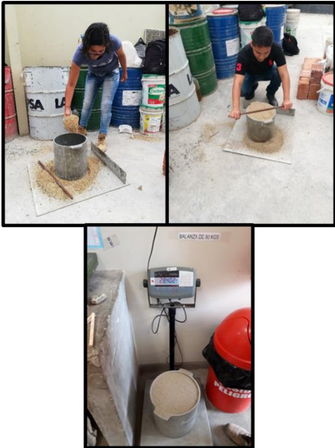
Figura 74: Realización del ensayo de peso unitario seco suelto del agregado fino
