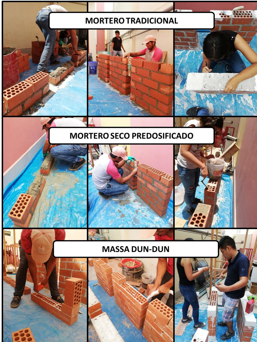
Figura 83: Elaboración y refrentado de muretes
