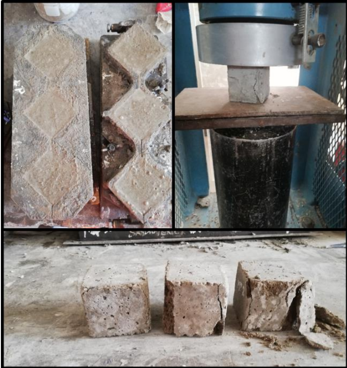
Figura 85: Realización del ensayo de resistencia a la compresión en cubos de mortero tradicional
