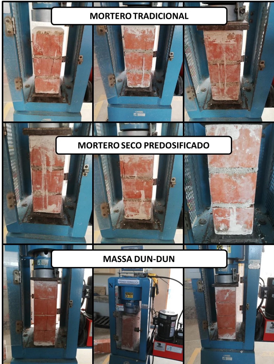
Figura 82: Fallas presentadas en el ensayo de compresión axial en pilas
