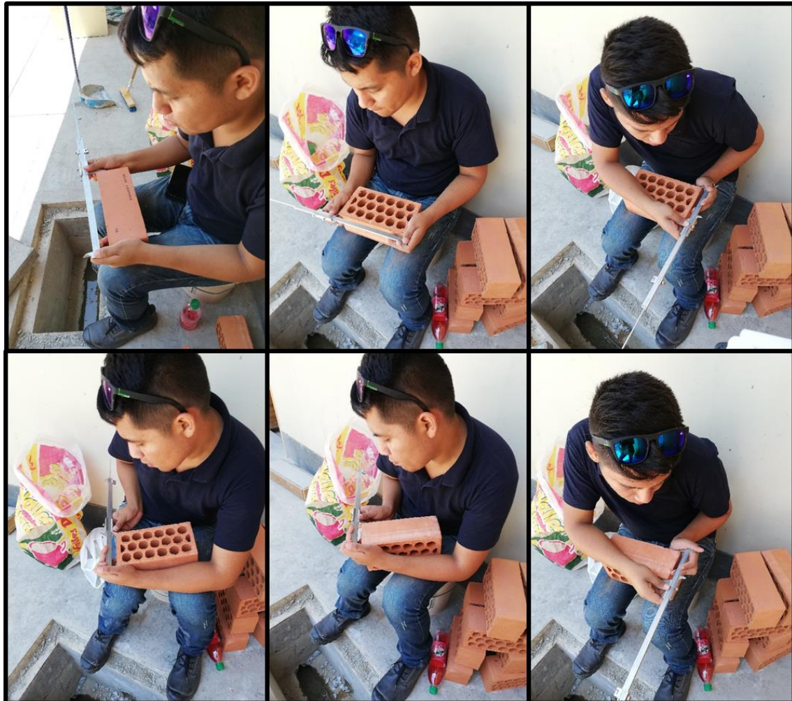
Figura 77: Realización del ensayo de variación dimensional en unidades de albañilería
