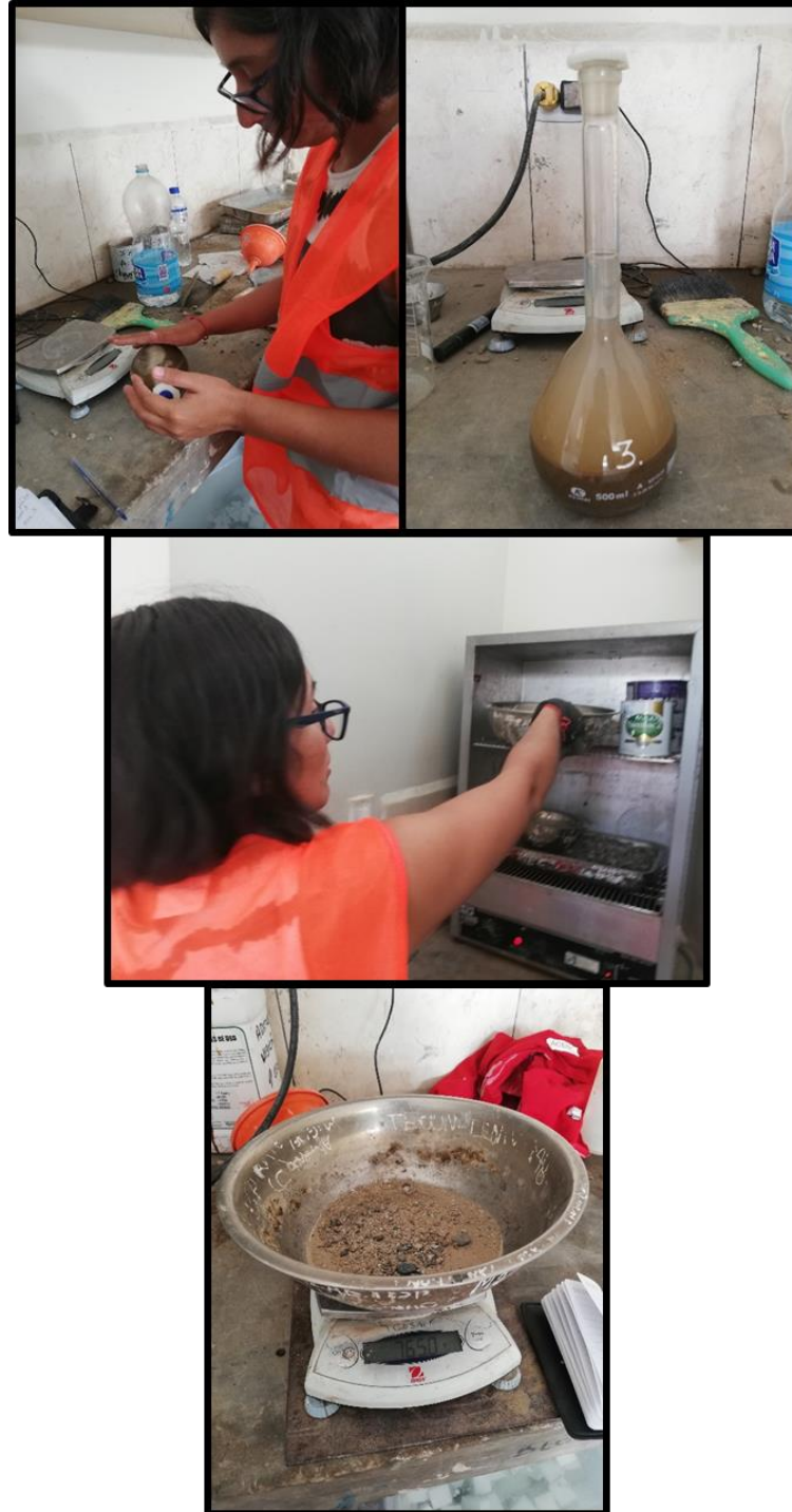
Figura 73: Realización del ensayo de peso específico y absorción del agregado fino
