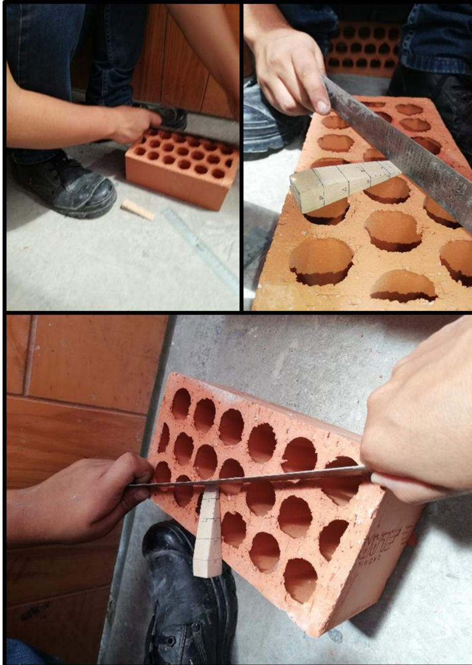
Figura 78: Realización del ensayo de alabeo en unidades de albañilería
