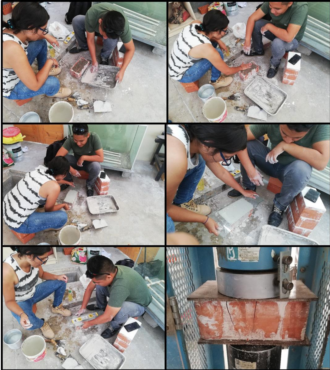
Figura 76: Realización del ensayo de resistencia a la compresión en unidades de albañilería
