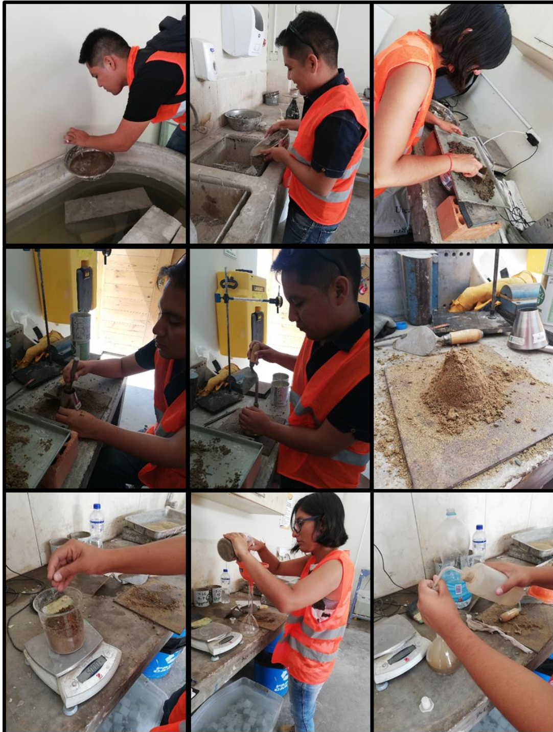
Figura 72: Realización del ensayo de peso específico del agregado fino
