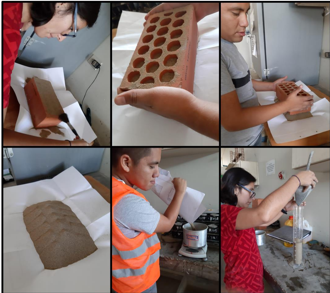
Figura 80: Realización del ensayo de porcentaje de vacíos en unidades de albañilería
