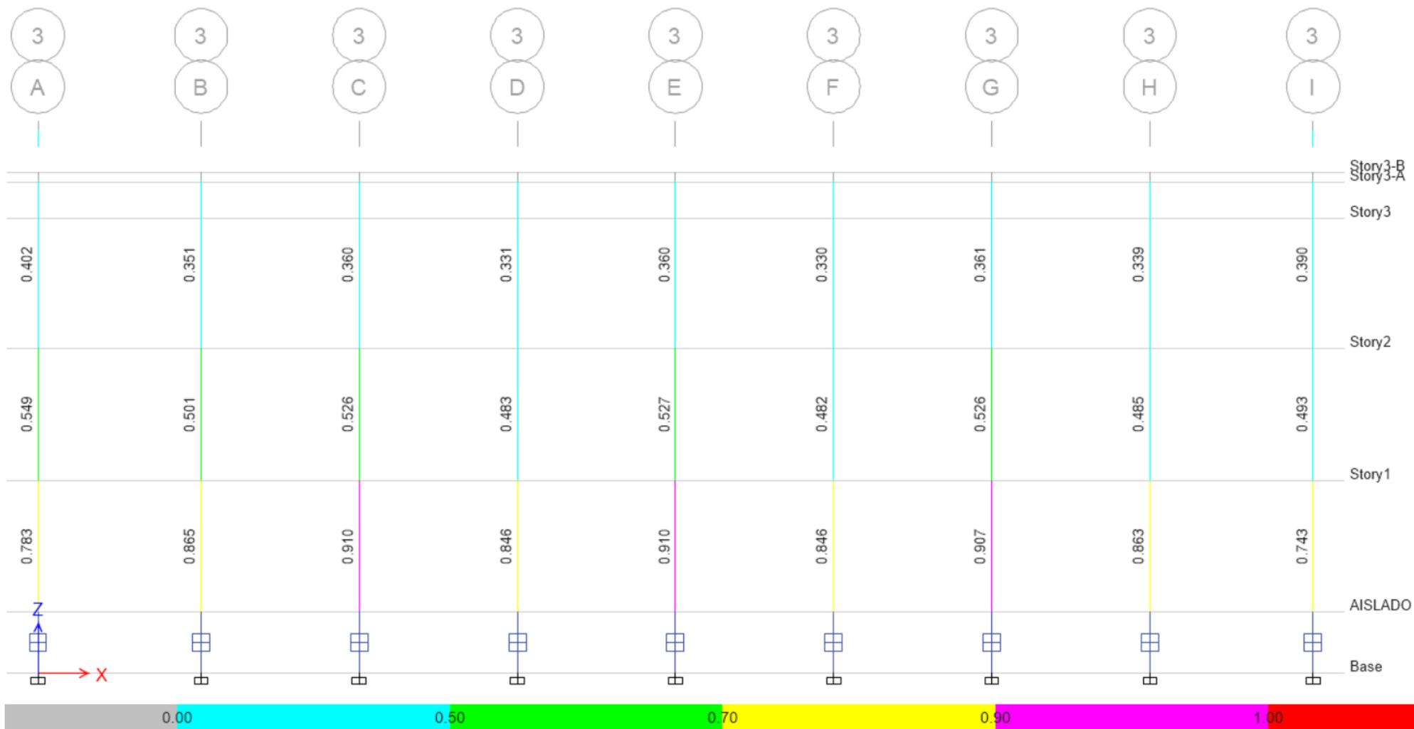
Figura 69: Ratios de demanda capacidad para las columnas del p3. Se observa que las columnas est3n trabajando a menos del 100% de su capacidad, es decir la capacidad de las columnas sobrepasa la demanda impuesta a las columnas.
