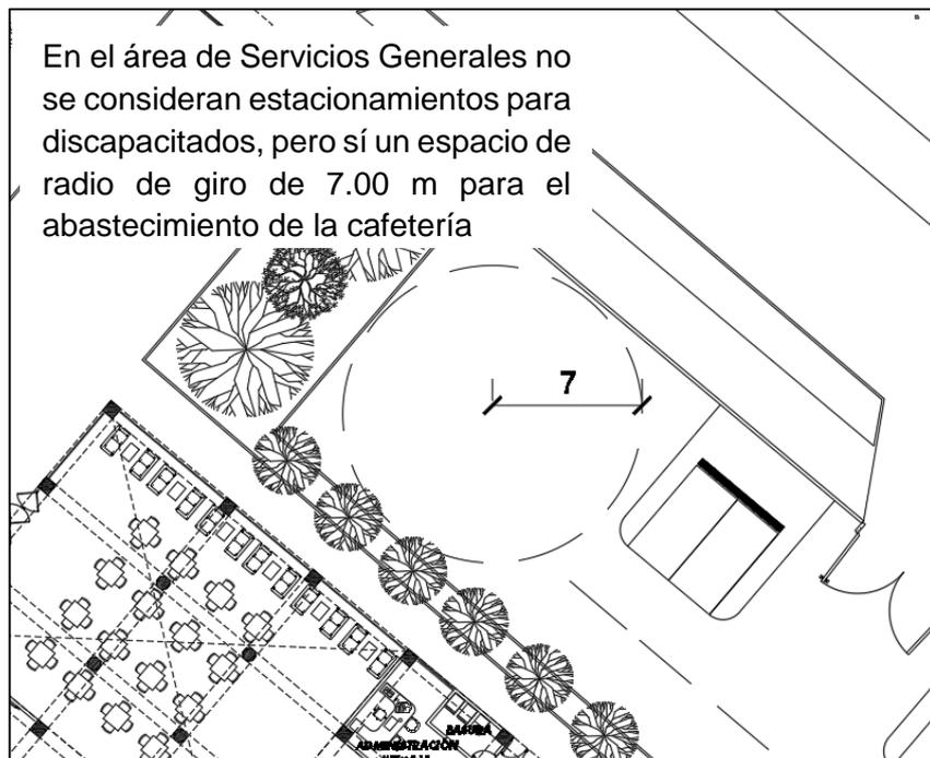
Figura N° 76. Estacionamientos Servicios Generales - Planta
