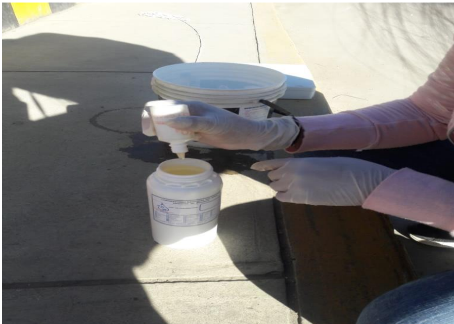
Figura 44. Preservación de muestra para análisis de DBO
