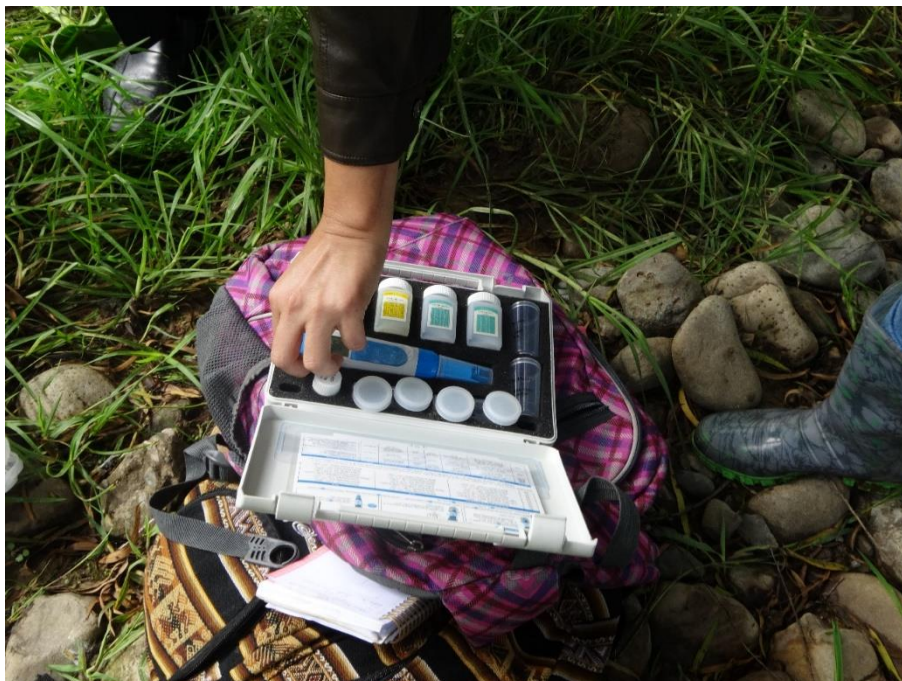
Figura 42. Muestreo in situ - Multiparametro PC60
