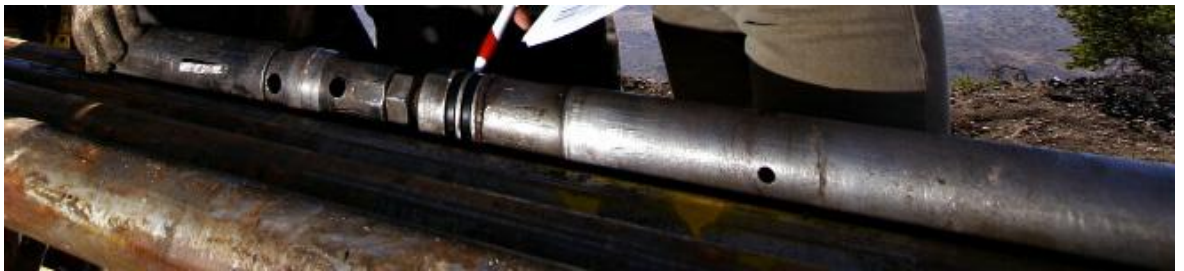
Figura 14. Cabezal y tubo interior o saca testigos Fuente: Fernández R., 2015
