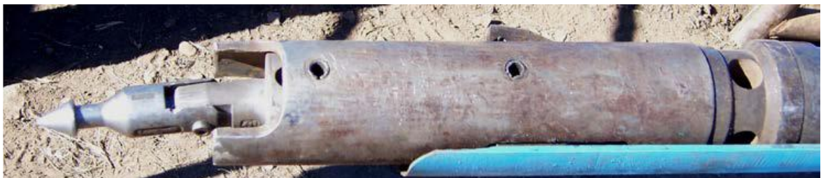
Figura 15. Parte superior del cabezal al que va enroscado el tubo saca testigos (tubo interior) Fuente: Fernández R., 2015
