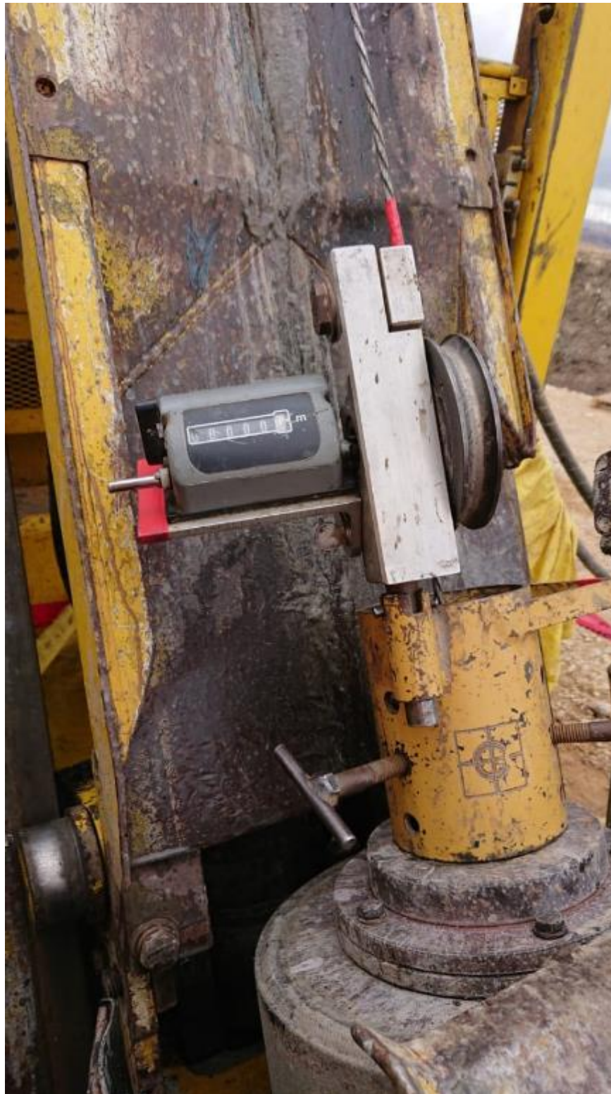
Foto 4. Contador para llegar a la profundidad indicada del equipo de medición
