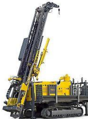
Figura 7. Máquina de perforación por circulación reversa montada sobre orugas. Fuente: Fernández R., 2015
