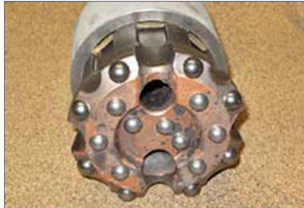
Figura 5. Broca de martillo de fondo con carga frontal (orificios). Notar los “botones” que constituyen la herramienta que desmenuza la roca por golpe y rotación
