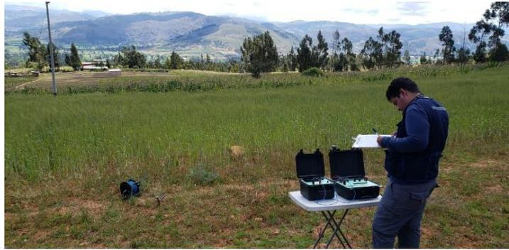
Figura 21.. Estación SEV 01 con coordenadas N: 9200565 y E: 779290, ubicado al sur-este del centro poblado de Agocucho.
