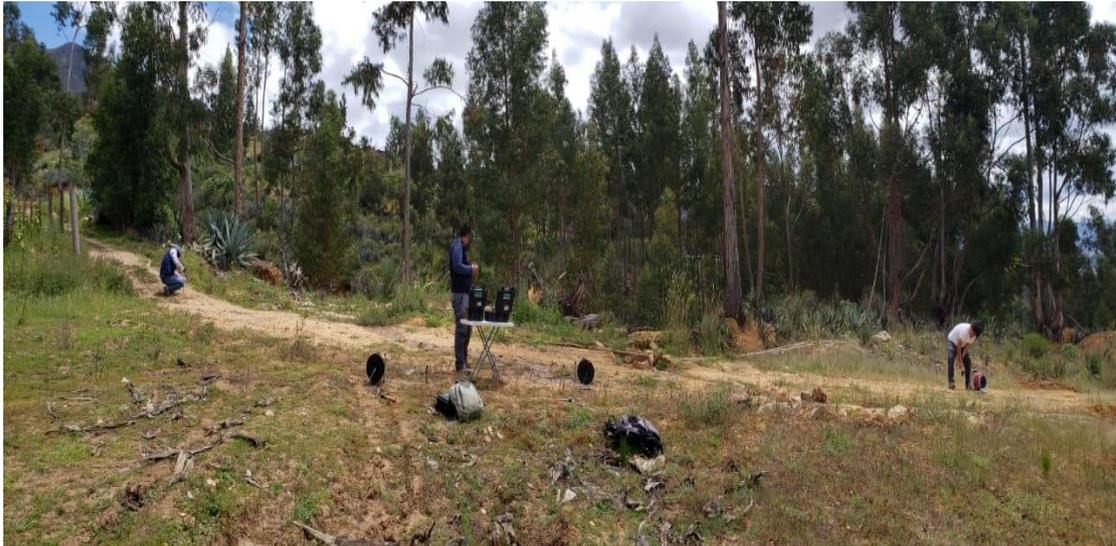
*Figura 5.* Alineamiento y distribución de los electrodos utilizados en campo configuración Schlumberger
