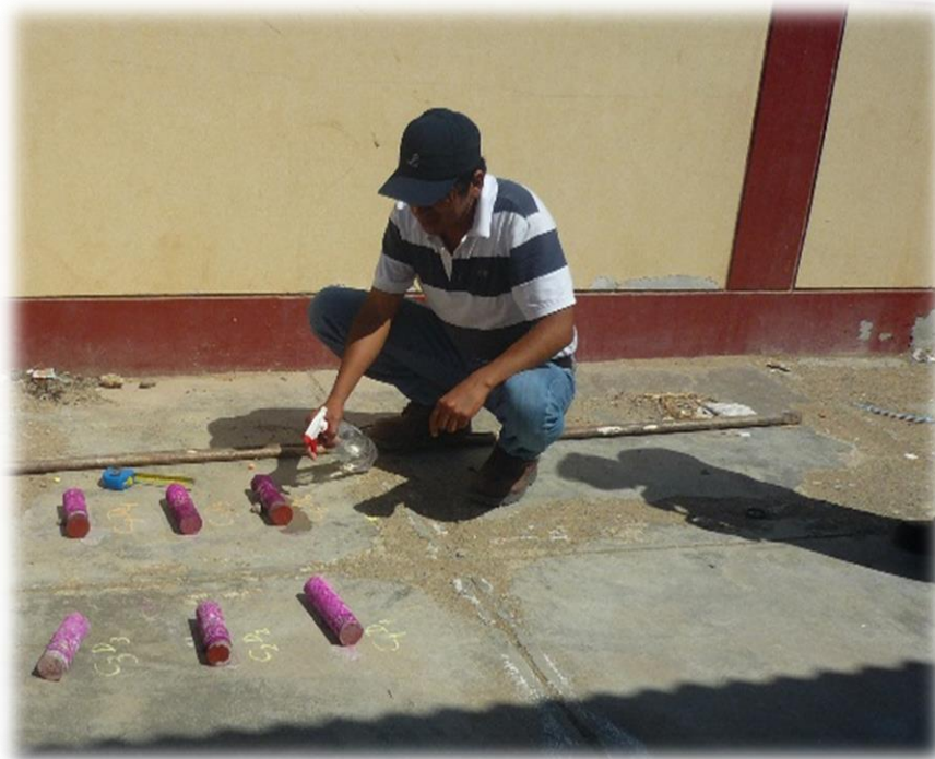
Foto 12. Ensayo del método de la fenoltaleína en los núcleos de concreto
