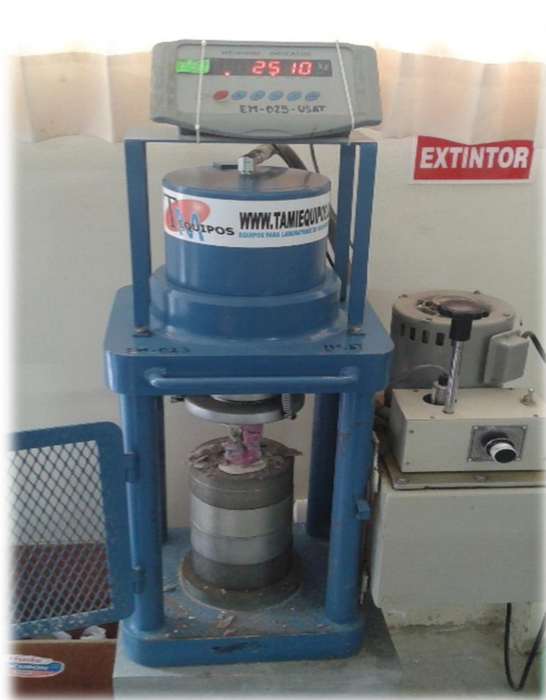
Foto 14. Determinación de la resistencia a la compresión axial del núcleo de concreto
