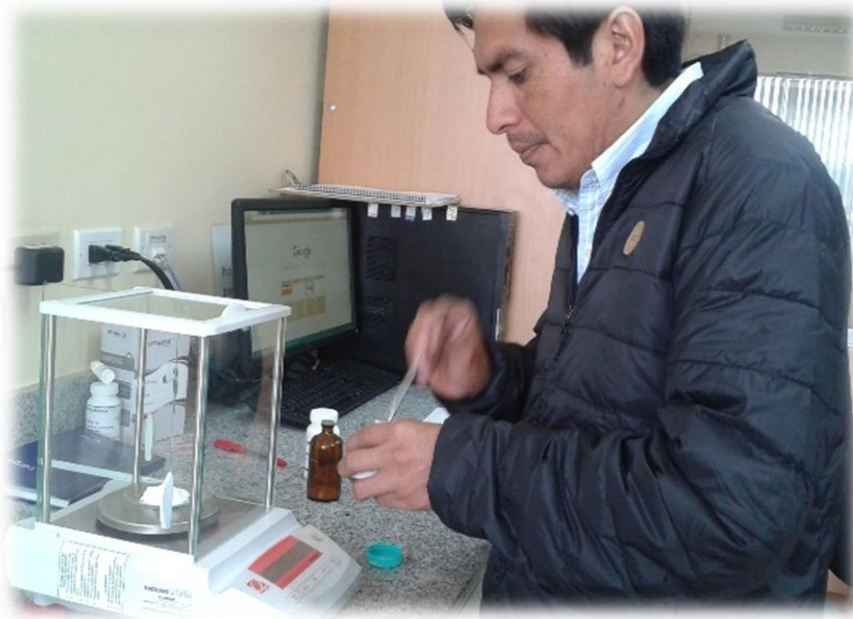
Foto 05. Preparación del reactivo (método de la fenolftaleína)
