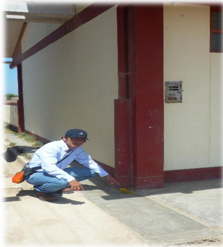
Foto 03. Identificación del valor del CO 2 en la parte inferior de la columna
