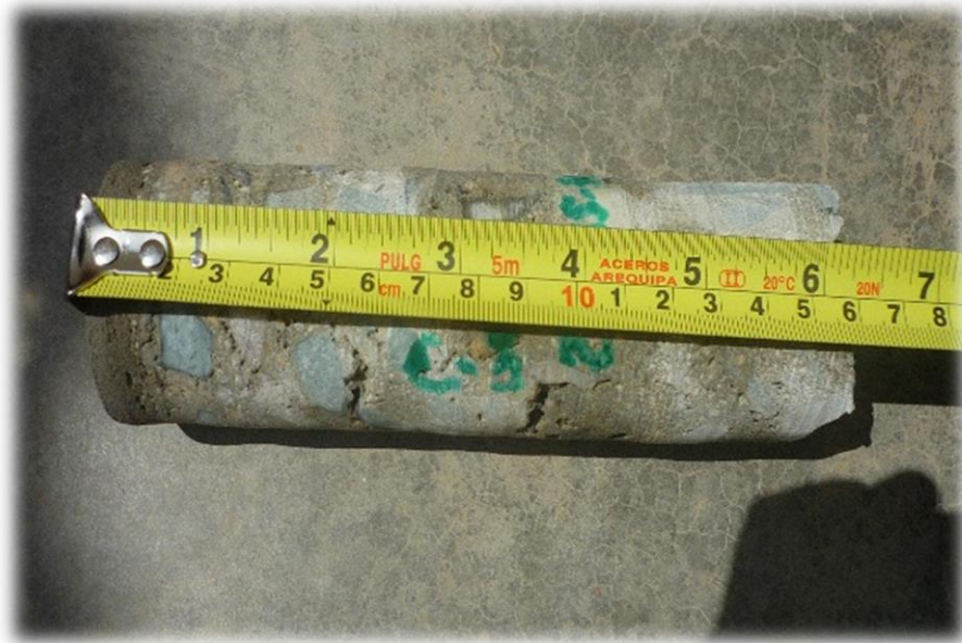
Foto 10. Medición del mortero en el núcleo de concreto
