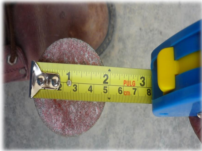
Foto 11. Medición del diámetro en el núcleo de concreto con wincha
