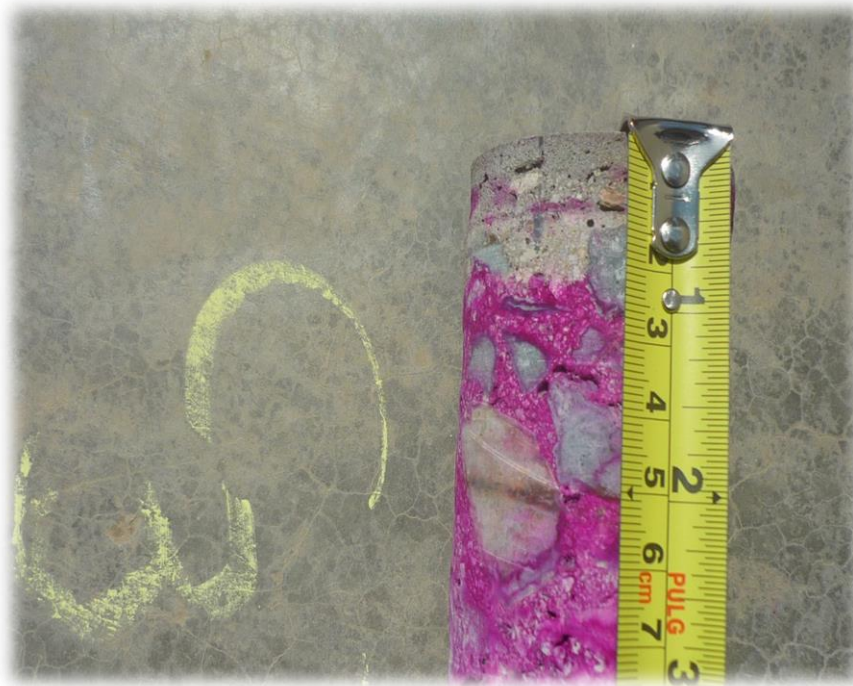
Foto 13. Determinación del frente carbonatado
