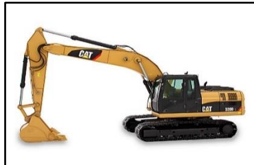
Figura 8: Excavadoras hidráulica sobre orugas
