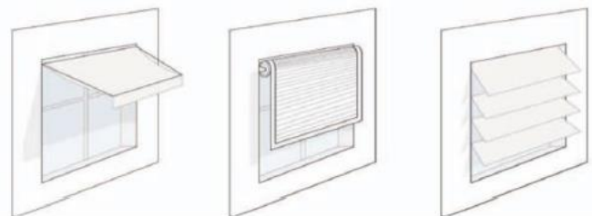
Protecciones solares móviles.
