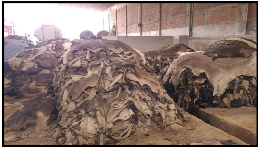
Figura 1. Recepción, salado clasificado y apilado de pieles
