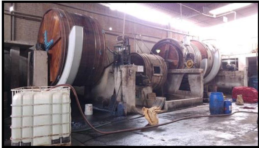
Figura 12. Proceso de Neutralizado – Botal para neutralizar
