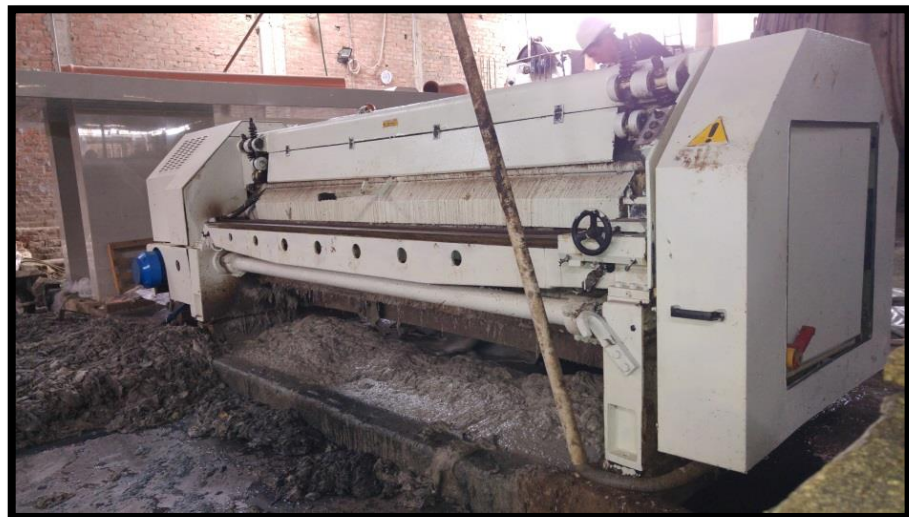
Figura 5. Proceso de dividido - Máquina divididora
