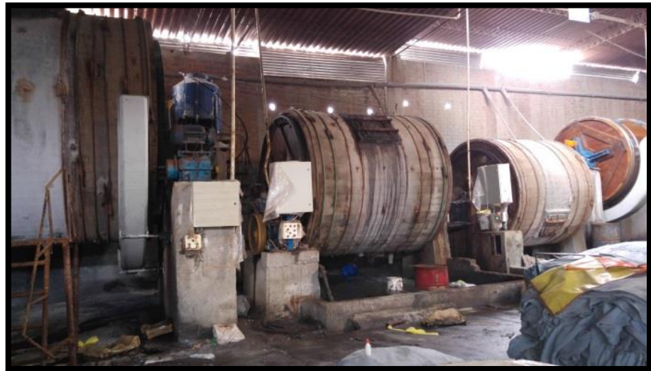
Figura 6. Proceso de desencalado – Botal para desencalado
