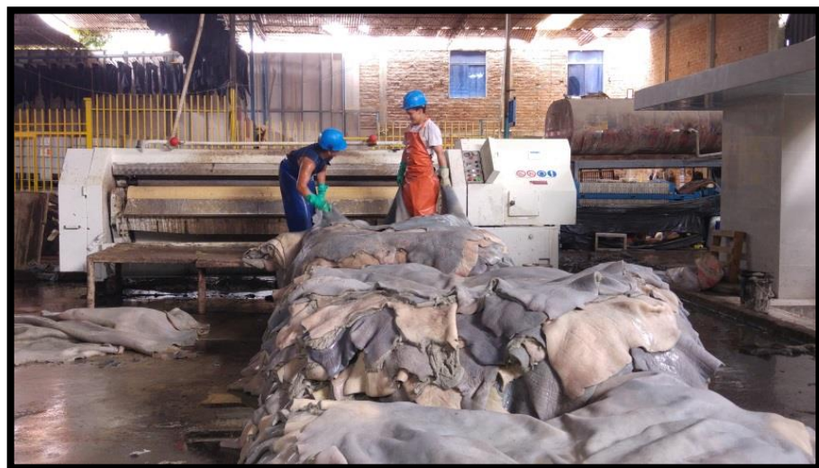
Figura 4. Proceso de descarnado – Máquina descarnadora
