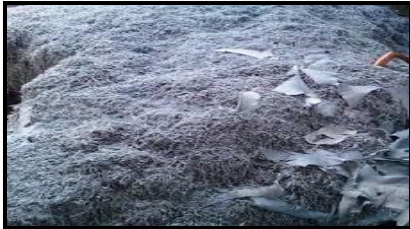
Figura 11. Viruta de cromo, residuo del proceso de rebajado
