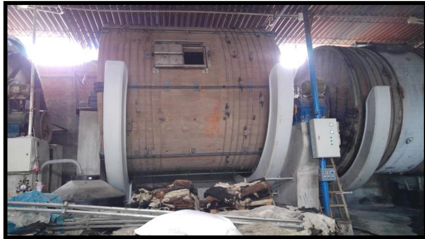
Figura 3. Proceso de pelambre – Botal pelador
