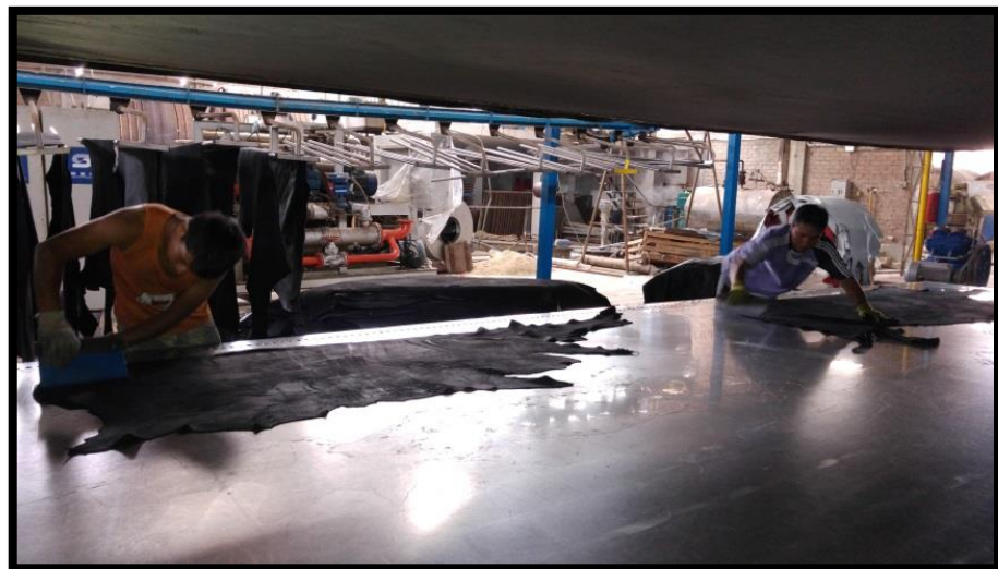
Figura 15. Proceso de secado – Máquina de secado al vacío
