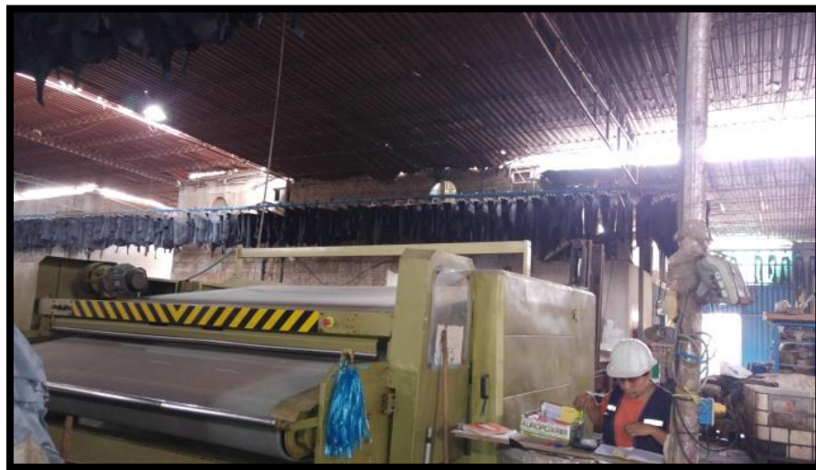
Figura 9. Proceso de escurrido – Máquina escurridora
