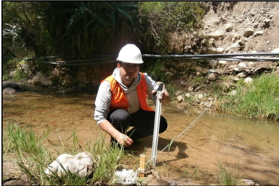
Fotografía 17 Medición del tirante de agua del río
