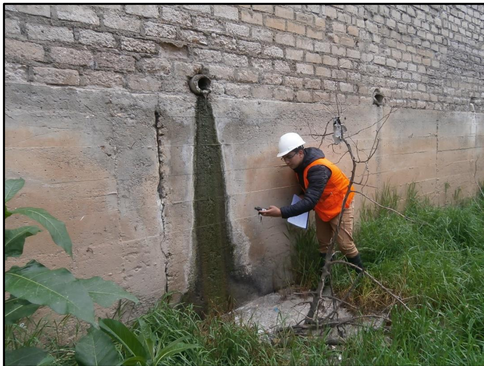
Fotografía 8 Toma de datos con GPS Manual del punto de descarga.
