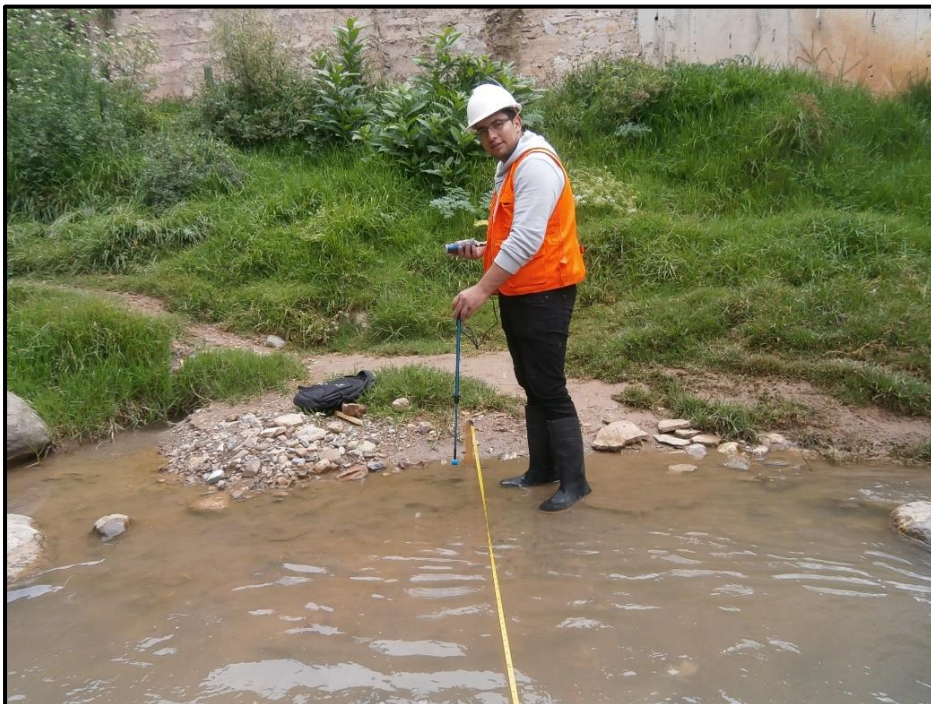
Fotografía 18 Medición de la velocidad del río con el correntómetro
