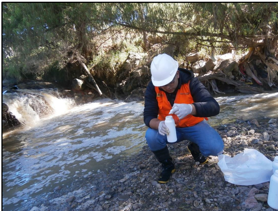
Fotografía 28 Recolección de la muestra N°6 después de la descarga P.T.A.R.C
