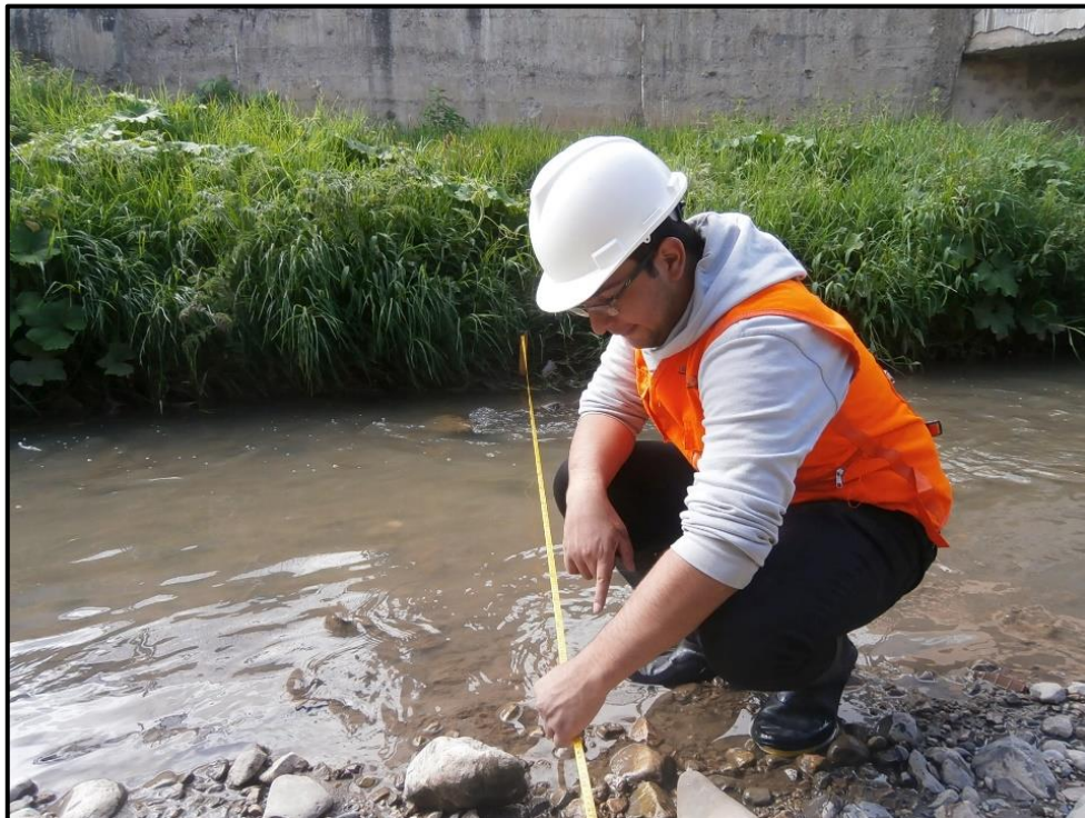
Fotografía 16 Medición de la longitud del río
