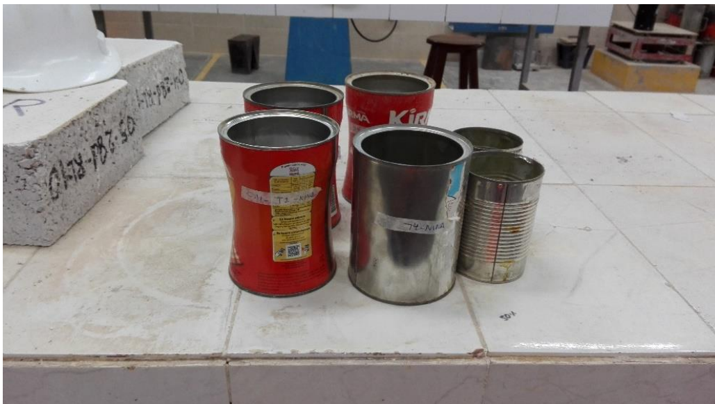
Figura 3. Taras del ensayo de contenido de humedad
