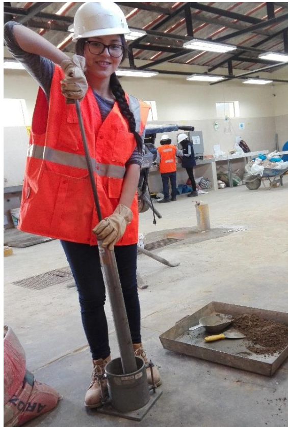
Figura 6. Compactación de proctor modificado
