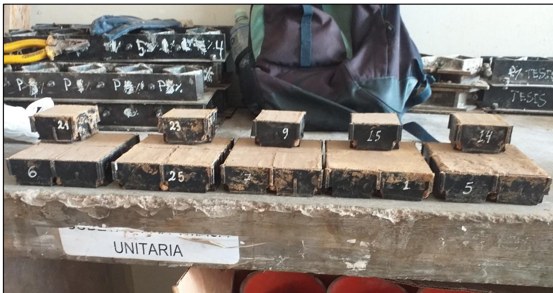
Figura 77. Probetas de celda individual y compuesta antes de realizar el capping
