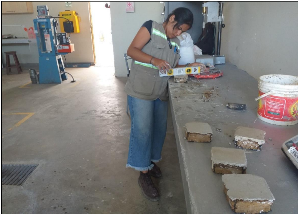
Figura 78. Realizando capping a probetas con relleno
