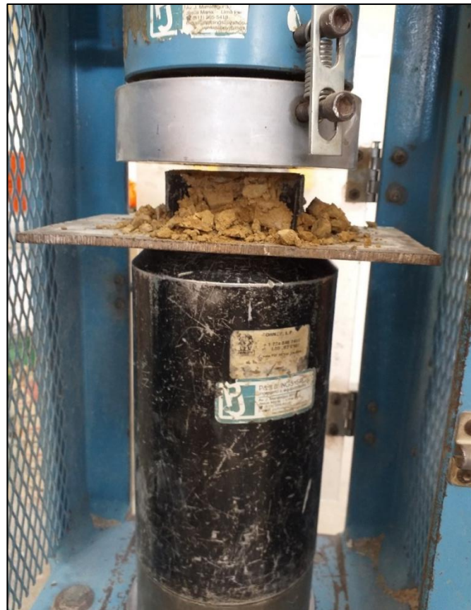
Figura 81. Probeta de celda sin bordes (en "x") con relleno en ensayo de deformación
