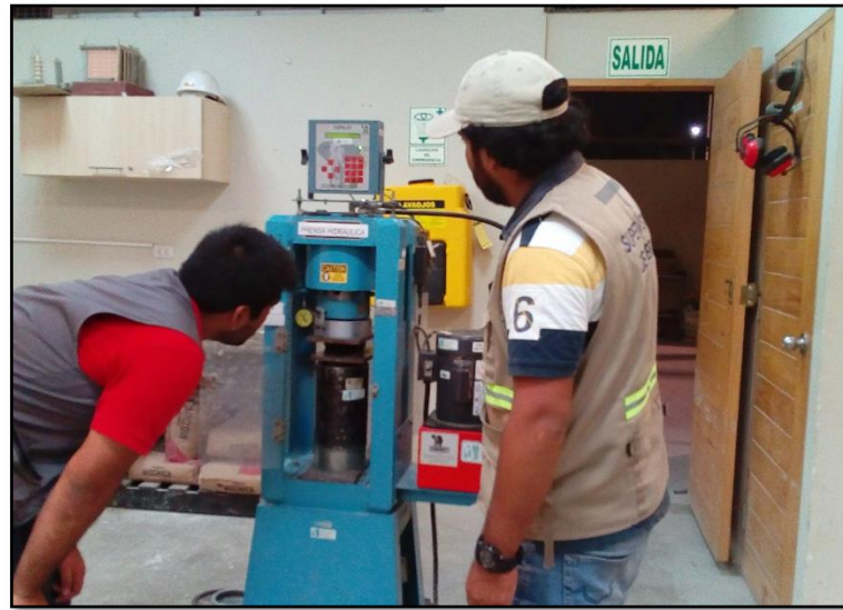
Figura 16. Realización de ensayo de deformación
