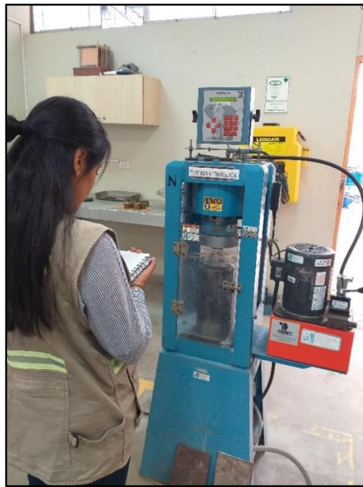
Figura 15. Realización de ensayo de resistencia a la compresión
