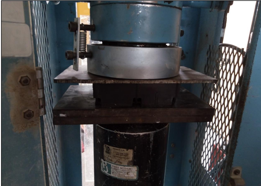
Figura 76. Ensayo de esfuerzo de celda compuesta sin relleno
