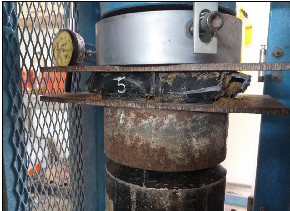
Figura 80. Probeta de celda compuesta con relleno en ensayo de deformación
