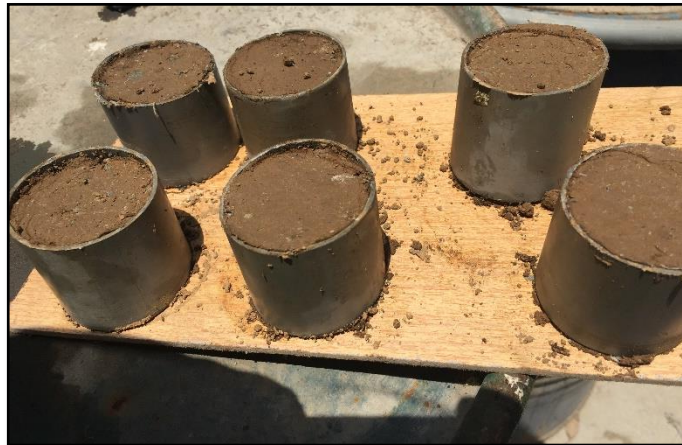
Figura 9. Probetas patrón (material base)
