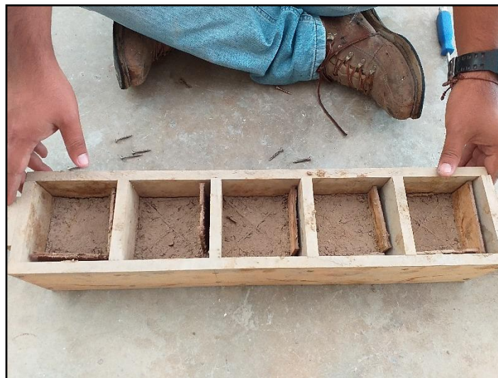
Figura 12. Compactación de celdas sin bordes (en “x”)
