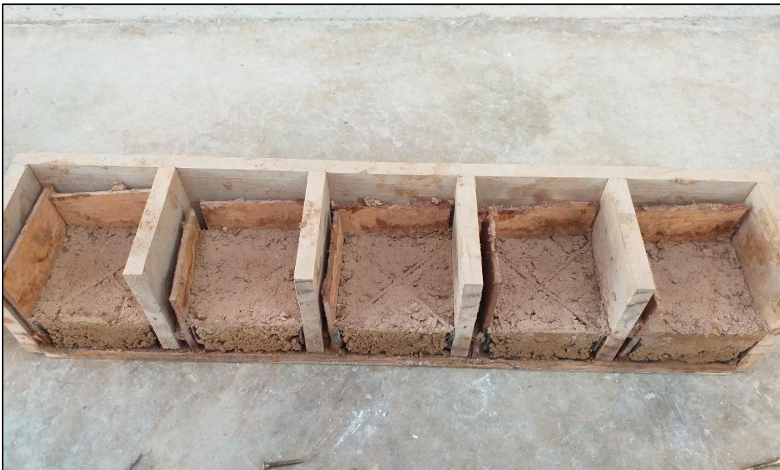
Figura 75. Probetas de celda sin bordes (en "x") con relleno
