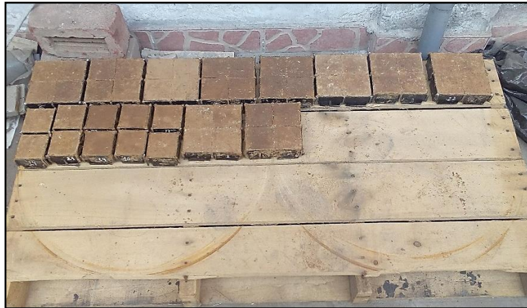
Figura 11. Compactación de celdas individuales y celdas compuestas
