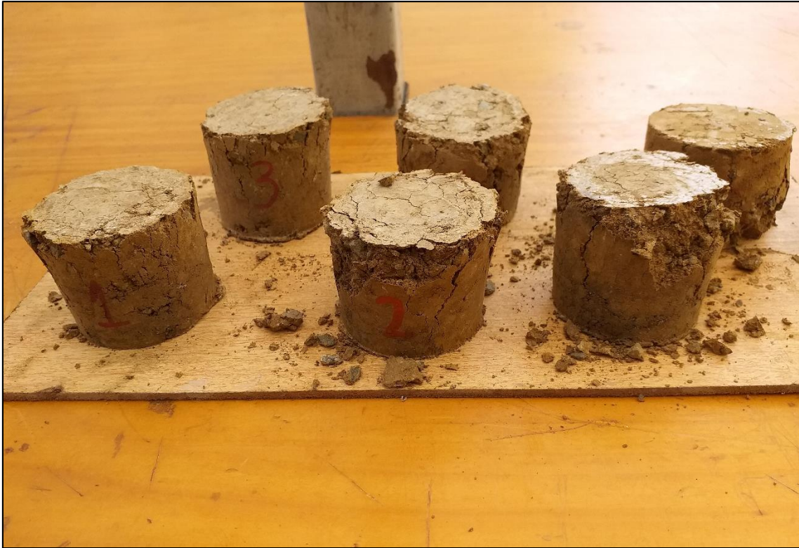
Figura 82. Probetas patrón después de ensayo de resistencia a la compresión
