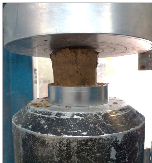
Figura 10. Ensayo de esfuerzo a probeta patrón
