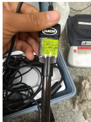
Figura 23. Etiqueta de calibración del pH metro Hach multiparámetro.
