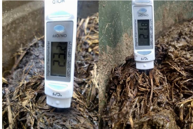
Figura 17. Toma de temperatura de las composteras in situ.
