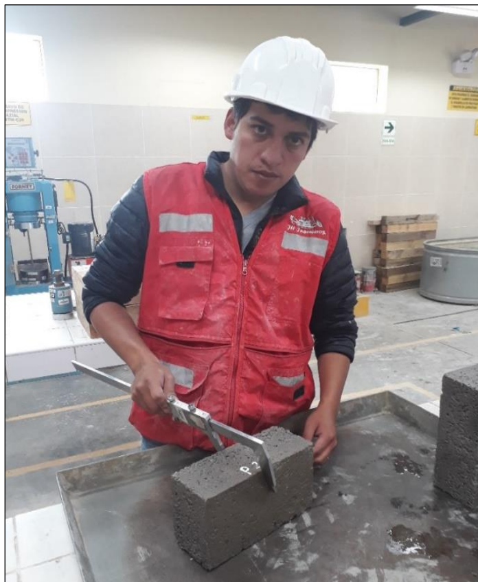
FOTOGRAFÍA 8: Toma de las dimensiones de las unidades de albañilería.
