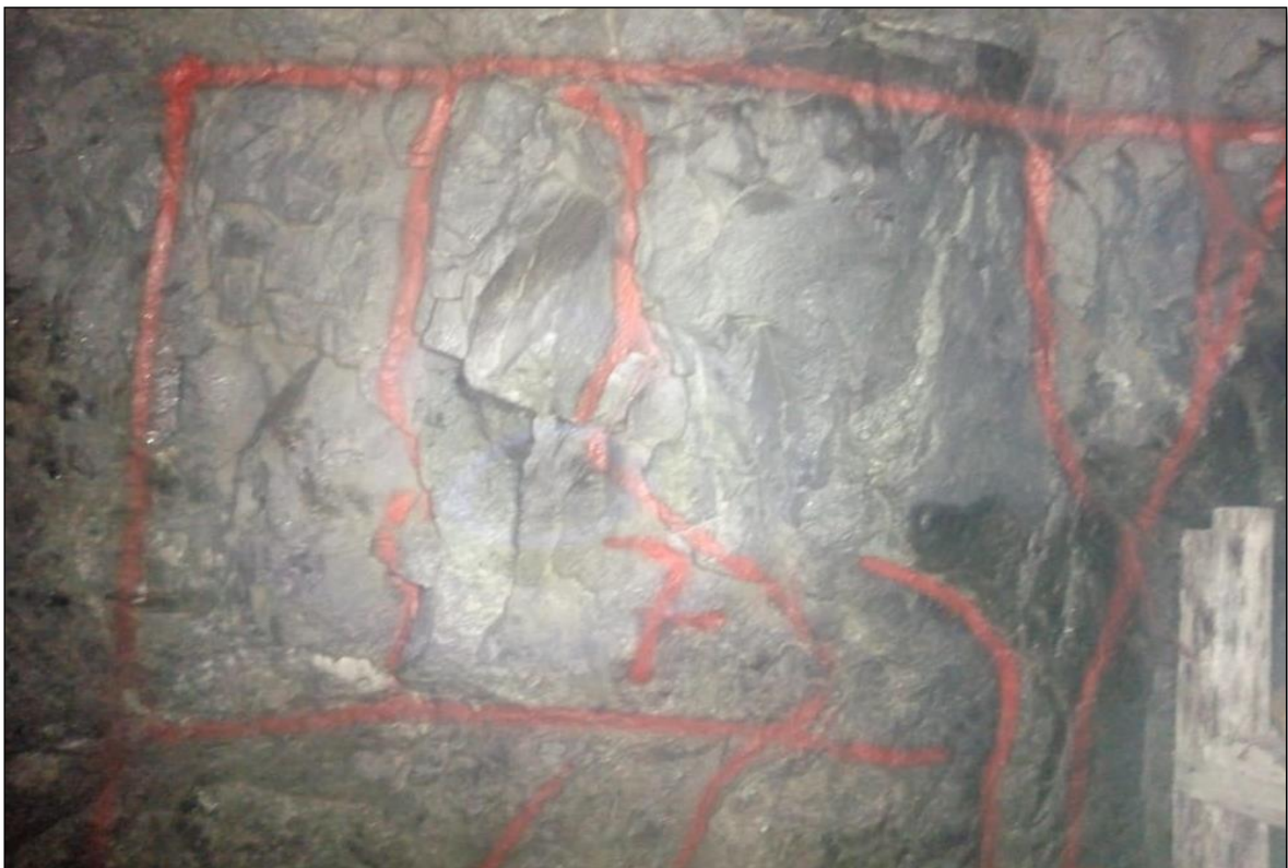
Figuras 55: Mapeo geomecánico de la rampa Karent.
