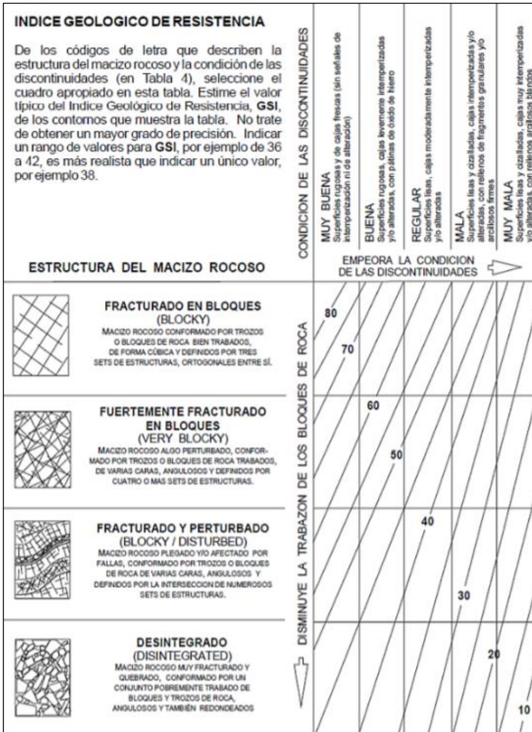
Figuras 44: Clasificación del macizo rocoso, índice GSI.
