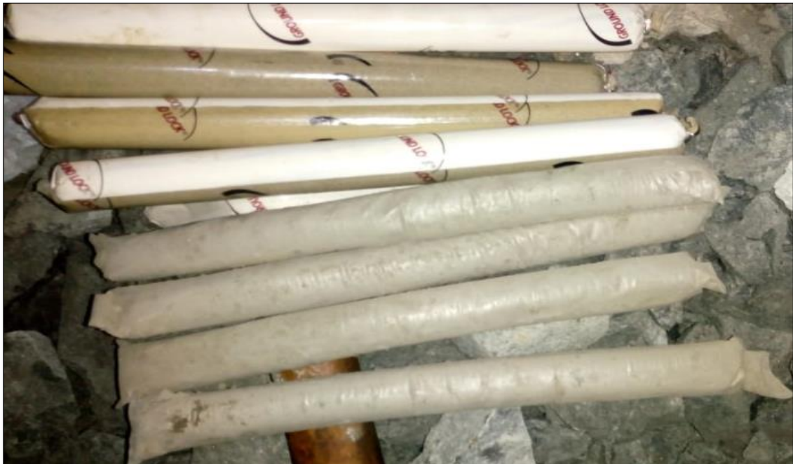
Figuras 58: Cencom y resina para sostener el perno.
