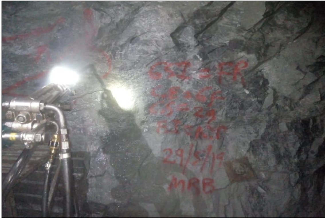
Figuras 57: Perforación para el perno Helicoidal con JackLeg.
