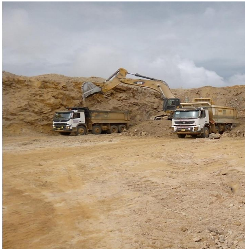
Ilustración 1: Proceso de carguío en el tajo. Fuente: Área técnica de mina.
