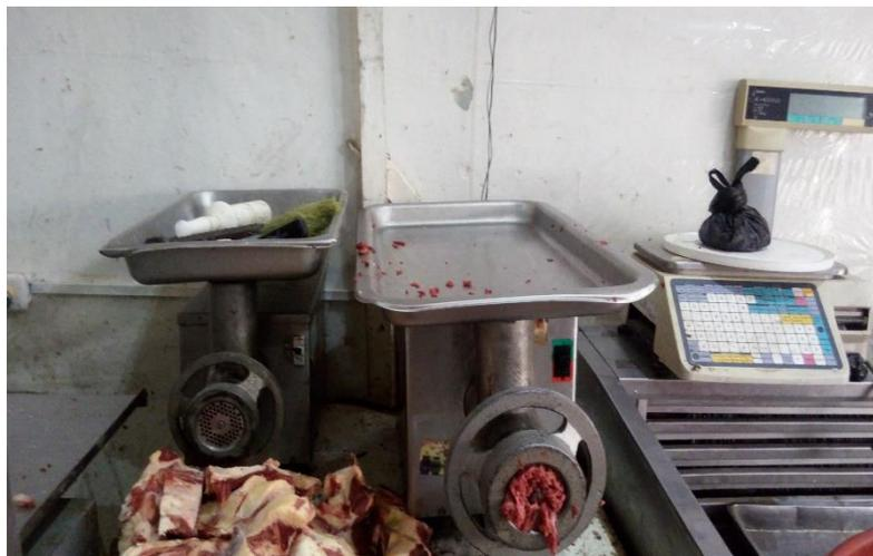
Figura 11: *Instalación de equipos fijos no permite su limpieza.* (DS N°007-98-SA y su modificatoria DS 038- 2014-SA, Distribución de ambientes e instalación de equipos, Art 38).
